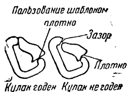
Фиг. 128. Проверка кулака двухзвенной цепи
