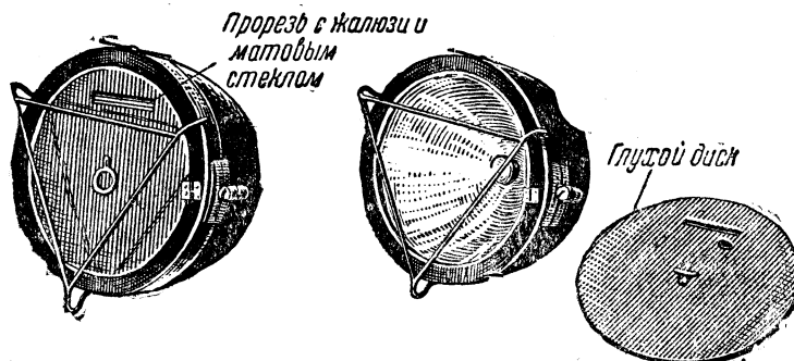
Фиг. 238. Светомаскировка буферной фары
