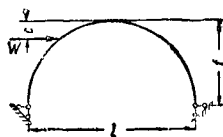
Фиг. 45. Двухшарнирная параболическая арка, нагруженная горизонтальной сосредоточенной силой
