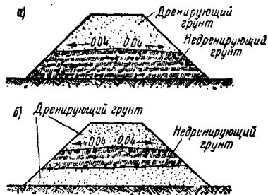
Фиг. 2. Схема допустимого расположения грунтов в теле насыпи
