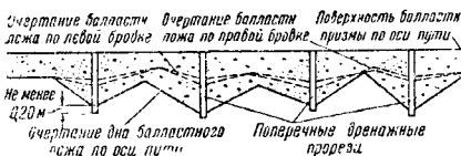
Фиг. 97. Расположение поперечных дренажных разрезов при неровном дне ложа
