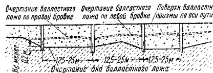
Фиг. 96. Расположение поперечных дренажных разрезов при ровной поверхности дна ложа
