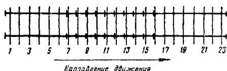
Фиг. 25. Схема установки пружинных противоугонов на двухпутных линиях с 1949 г.
