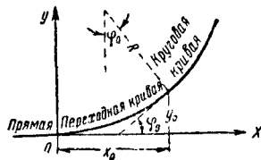
Фиг. 19. Координатное изображение переходной кривой
