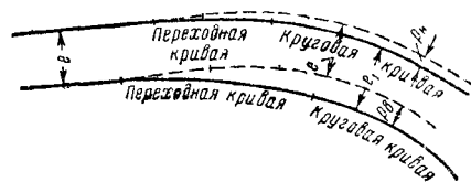
Фиг. 30. Способ раздвижки путей переходными кривыми
