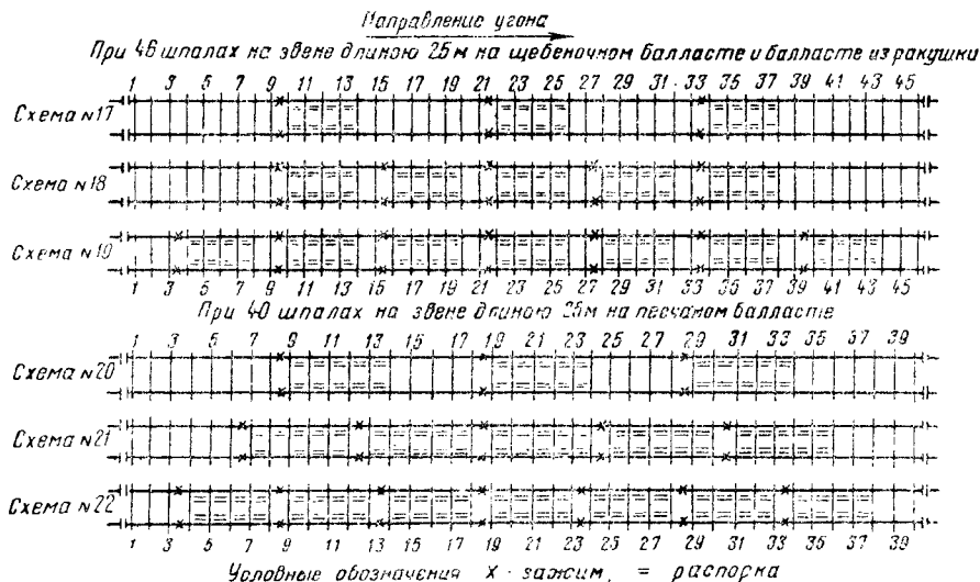
Фиг. 21. Схемы установки клиновых противоугонов на двухпутных линиях до 1949 г.
