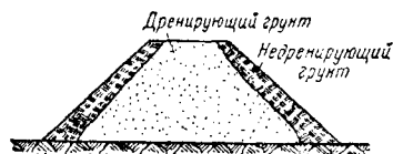
Фиг. 1. Схема недопустимого расположения грунтов в теле насыпи
