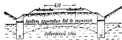
Фиг. 99. Несовершенный двусторонний дренаж
