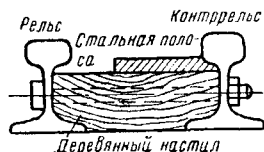
Фиг. 15. Конструктивное оформление приспособления инж. Богоявленского
