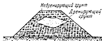
Фиг. 3. Схема недопустимого расположения грунтов в теле насыпи
