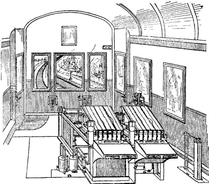
Фиг. 148. Вагон-путеизмеритель системы Ляшенко
