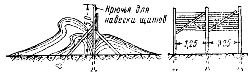
Фиг. 82. Снегозащитные заборы с навесными щитами (после подъёмки щитов)
