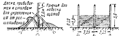
Фиг. 81. Снегозащитные заборы с навесными щитами (до подъёмки щитов)
