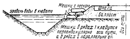
Фиг. 103. Схема защиты балластного слоя от размыва
