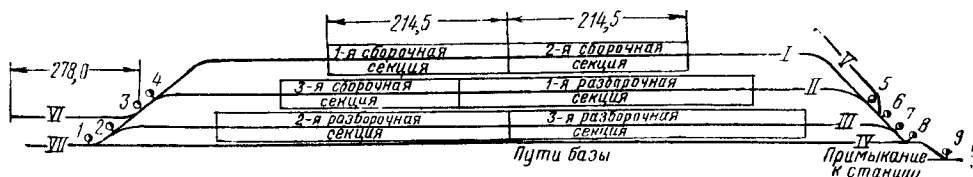
Фиг. 37. Количество секций и путевое развитие звеносборочной базы
