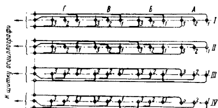
Фиг. 62. Схема монтажа центрального щитка на четыре вида колебаний
