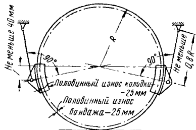
Фиг. 32. Условия подвешивания тормозных колодок у тендерных колёс
