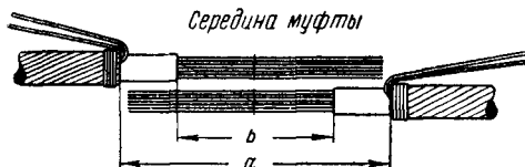
Фиг. 283. Разметка концов кабеля
