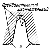
Фиг. 62. Напуск для высоких ребер
