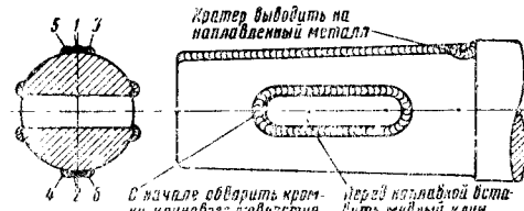
Фиг. 44. Схема наплавки головки поршневого штока
