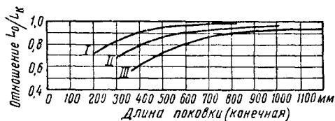
Фиг. 31. График для определения длины заготовки под раздачу для поволоков диаметром: I—до 1 500, II—до 2 000, III—до 3 000 мм
