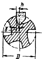
Фиг. 132. Заточка передней грани метчика
