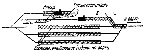
Фиг. 136. Комплексная механизация очистки от снега парка прибытия при одном свободном пути (опыт станции Свердловск-сортировочный);
