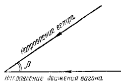
Фиг. 129. Угол между направлением движения вагона и направлением ветра
