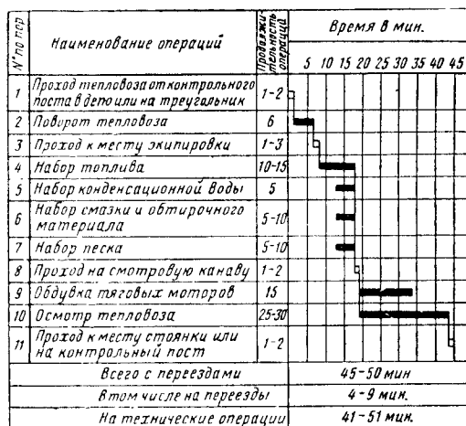
Фиг. 126. Примерный график полной экипировки тепловозов
