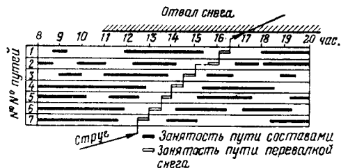
Фиг. 137. Очистка от снега парка приёма или отправления стругом в «окна» между поездами (опыт станции Люблино)
