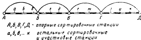
Фиг. 14. Схема направления с указанием опорных сортировочных станций
