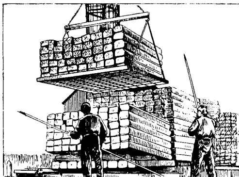
Фиг. 75. Захват для погрузки и выгрузки краев досок пакетами
