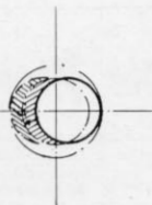
Abb. 3. Ein „verbohrt“ Loch wird entgegengesetzt zur Verlauffrichtung „geräumt“ und zwar um das Doppelte des Abweichmaßes (schraffiert!). Dieses Räumen und das nachfolgende Aufbohren hat natürlich nur Sinn, wenn zuvor kleiner als benötigt gebohrt wurde.
