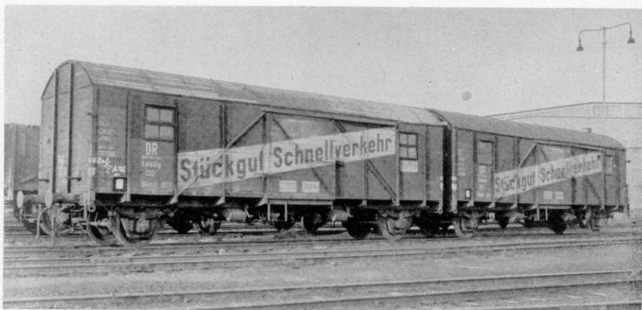
Aus zwei kurzgekuppelten und mit Faltenbälgen verbundenen Großraum-Güterwagen Glmhs Leipzig wird eine „Leig-Einheit“ für den Stückgutschnellverkehr mit dem nunmehrigen Gattungszeichen Gllmhs.
