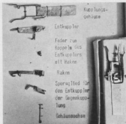
Abb. 8. Die Einzelteile der Kupplung. Rechts: Eine komplette Kupplung.
