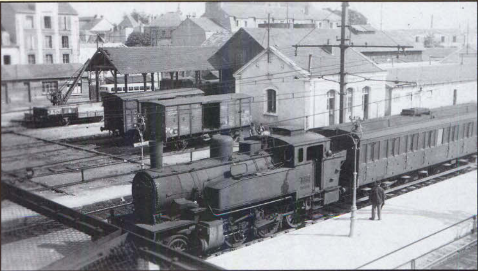
Bild 14: Die (T 9 3 ) Stettin 7327, 1910 bei Jung als Fabriknummer 1479 gebaut, ging als Reparationslieferung an die Paris-Orléans-Bahn, die sie nach ihrer Fusionierung mit der französischen Südbahn (Midi) als 130–869 bezeichnete. H. G. Hesselink hat sie mit dieser Nummer am 12. August 1938 in Chateauroux aufgenommen.
