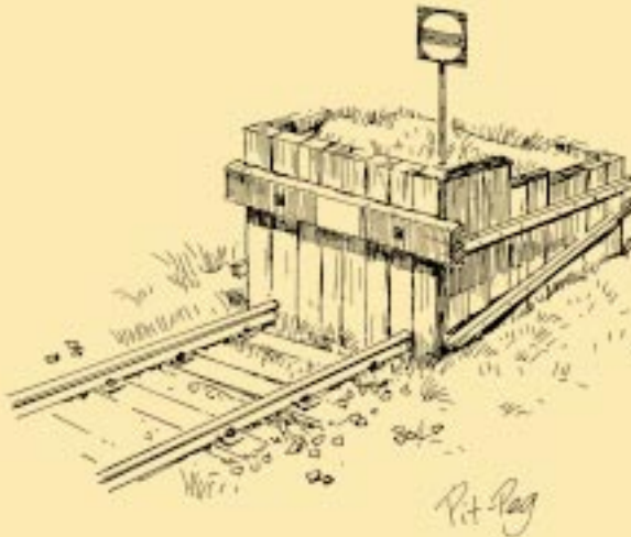
Die einfachste Form eines Prellbocks. Eine kleine Erdaufschüttung und zwei kräftige Balken waren bei sehr einfachen Betriebsverhältnissen oft ausreichend.
