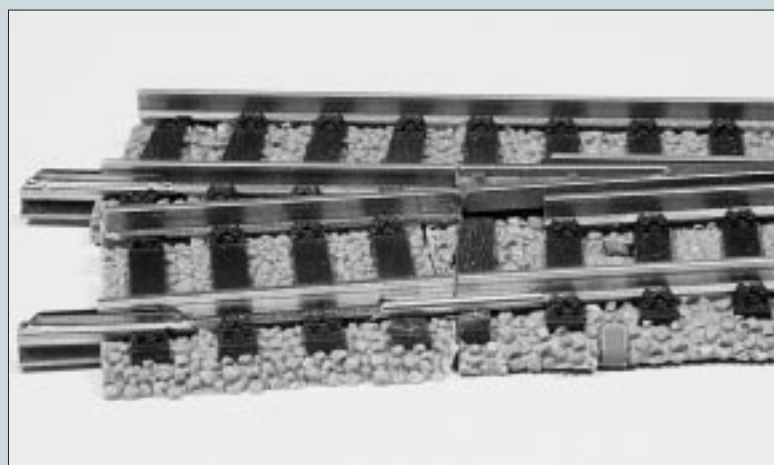
Oben: Auf der Außenschiene erfolgt der mechanische und elektrische Übergang mit Hilfe eines Schienenverbinders. Links: Aus einem geraden Stück Profi-Gleis entsteht der neue, wesentlich großzügigere Anschluß an das Herzstück.
