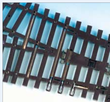
Oben: Die in den Schwellen der Roco-Line-Weichen liegenden Verbindungen versorgen die vom Herzstück abgehenden Schienen unabhängig von der Weichenstellung mit Strom. Die Kontakte dienen der Herzstückansteuerung über externe Umschalter.
