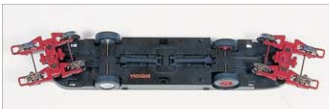
Der im festen Drehpunkt radial eingestellte Spurwagen am Brekina-Fahrwerk macht es deutlich: In Kurven würden die Gummireifen der Hinterachse unweigerlich von der Schiene abrutschen.
