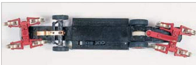
Die Deichsel des Günther-Fahrwerkes löst dieses Problem: Schienen- und Gummiräder bleiben in der Spur. Dafür schwenkt jedoch die äußere Achse des Spurwagens mehr aus.
