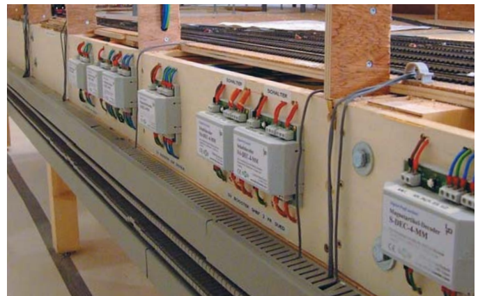
Die Decoder für Magnetartikel sind an einem rückseitigen Brett zugänglich montiert, um im Störfall schnell eingreifen zu können.
