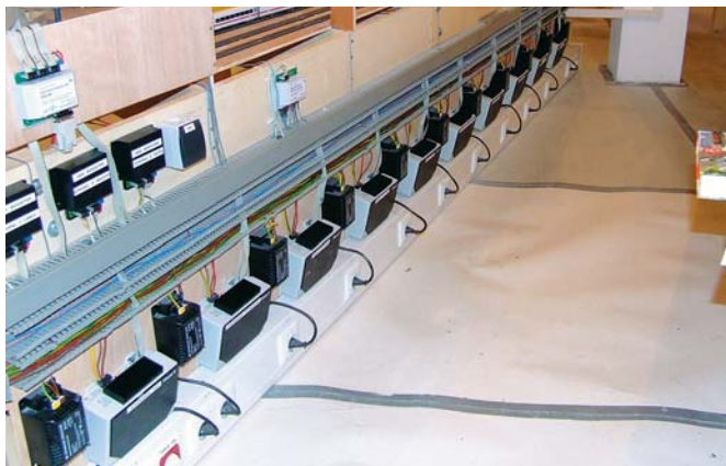
Jede Menge Digital-Booster sorgen für störungsfreien Betrieb, auch wenn viele Züge gleichzeitig Strom fordern.
