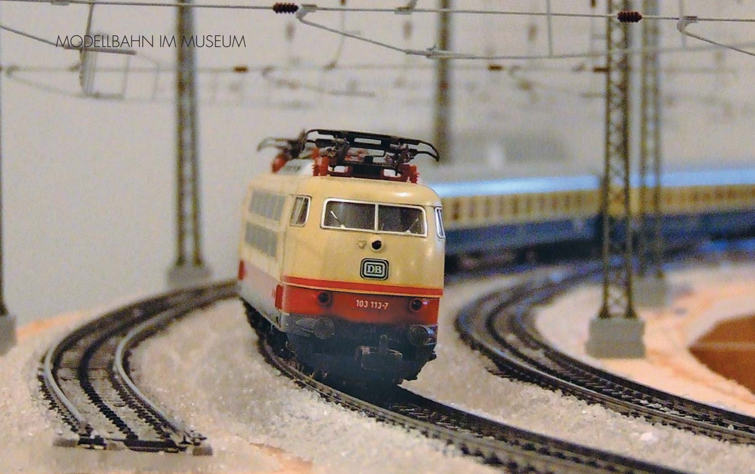
Gut zu sehen ist die „Kurvenlage“ des Zuges. Das selbst entwickelte Gleisbett mit Überhöhung machte das Verlegen der Schienen recht einfach. Das Stumpfgleis links ist das Ende der zurückgebauten dreispurigen Strecke von Schlüchtern bis zum Distelrasentunnel.
