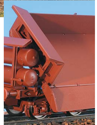
Formneu und funktionstüchtig: Zweiseitenkipper von Piko, ganz oben im Normalzustand, darunter mit gekippter Wanne.
