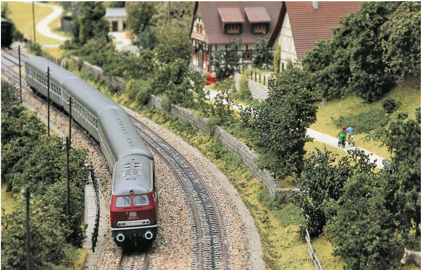
Eine 216 legt sich mit ihrem Eilzug in die Kurve. Den dynamischen Eindruck bekommt die Szene durch die Überhöhung der Kurvenaußenseiten, die unten im Schnitt zu sehen ist.
