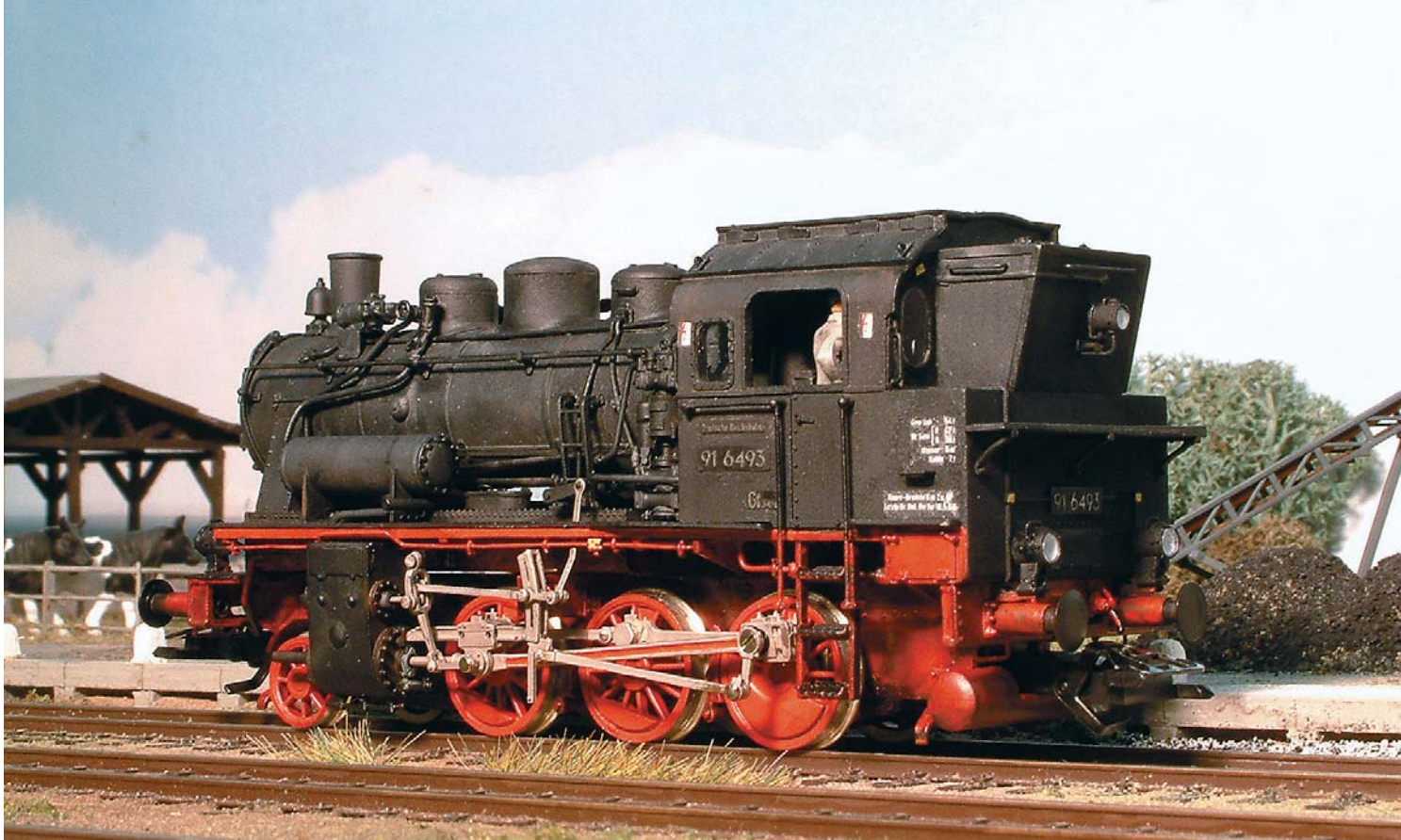
Die Lok am Ladegleis eines Unterwegsbahnhofs. Aus dieser Perspektive gut zu sehen sind der Vorwärmer, die Speisepumpe sowie der Luftbehälter.
