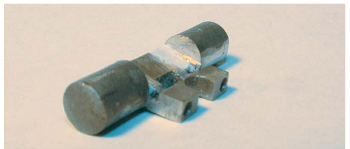
Der Luftbehälter und seine Halterung mussten in der Mitte ausgefeilt werden, um das Kupplungsspiel nicht zu behindern.
