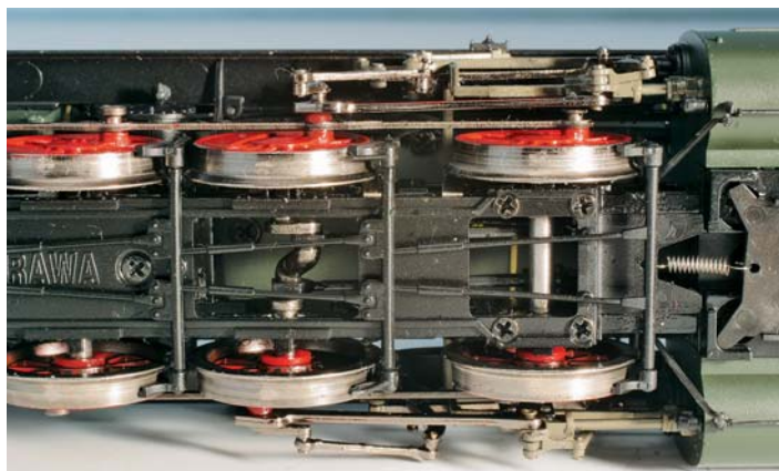
Ein Blick auf Kropfachse und Bremsanlage. Rechts die vordere Kurzkupplung.
