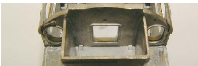
Der geleerte Kohlenkasten von oben. Die Kanten des Blechaufsatzes wurden etwas schmaler gefeilt.
