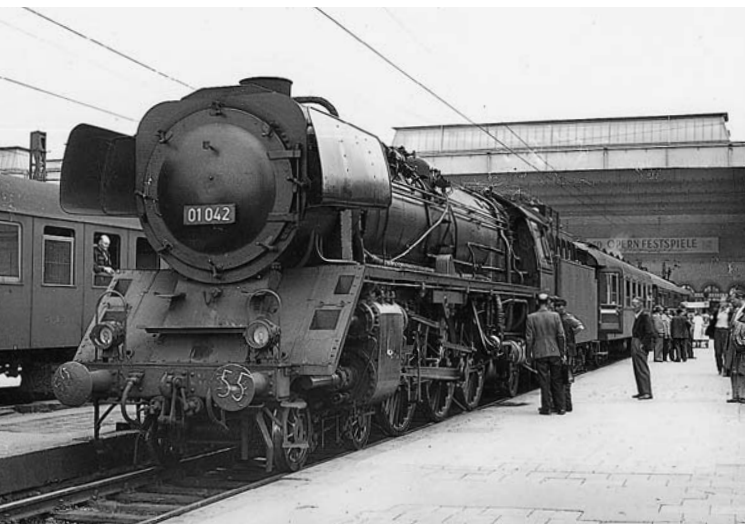
01 042 mit Henschel-Mischvorwärmer (1951). FOTO: CARL BELLINGRODT
