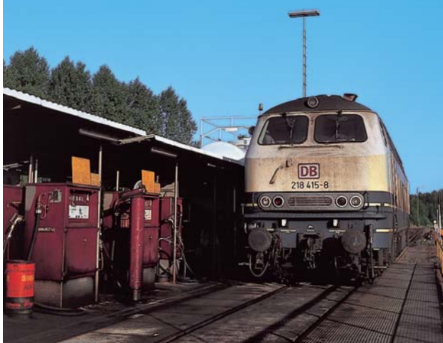
Bei der über zehn Jahre andauernden Auslieferung der 218-Bauserien wurden 208 Loks mit dem TB 11-Motor von MTU ausgerüstet, darunter auch die 1977 gebaute 218 415 – hier bei einem Tankstopp. Foto: MICHAEL GIEGOLD
