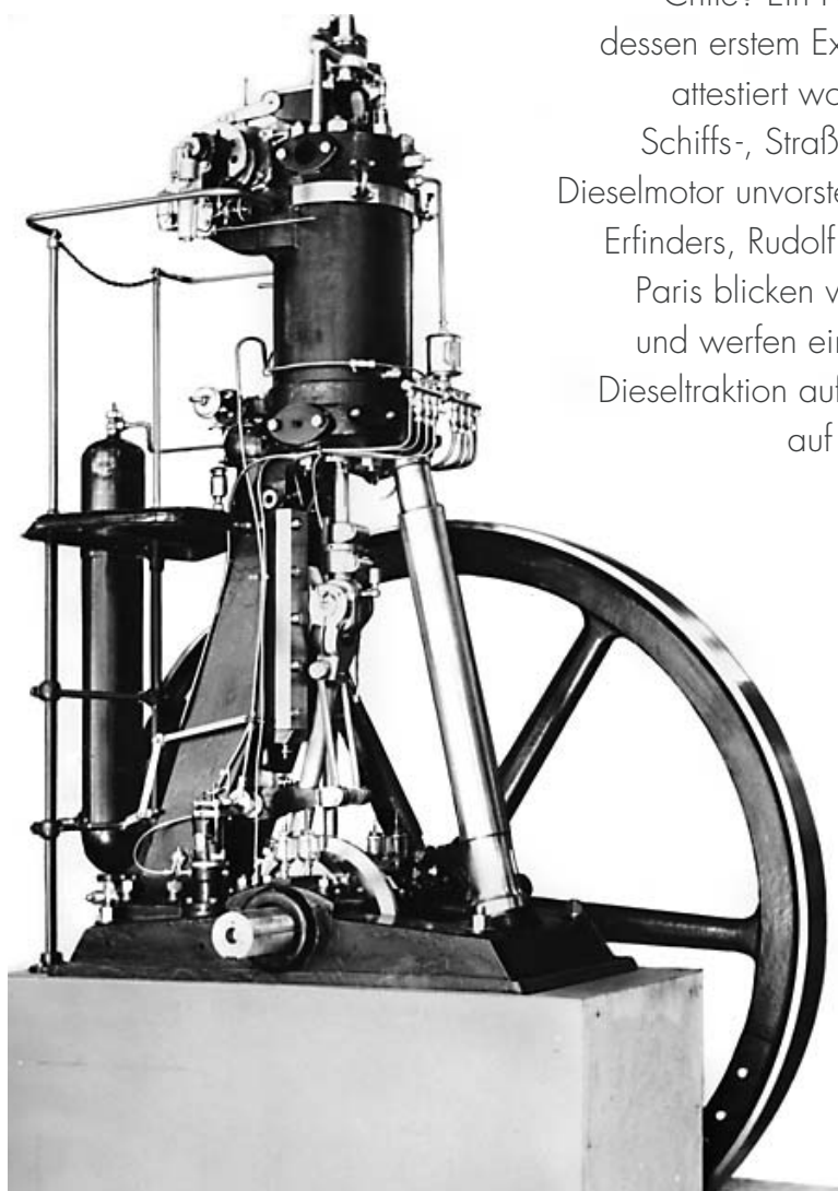
Der „Ur-Diesel“: Am 17. Februar 1897 wurde dem Prototyp einer „rationellen Wärmekraftmaschine“ die Betriebsreife zugesprochen – heute ein Exponat im MAN-Museum in Augsburg.
