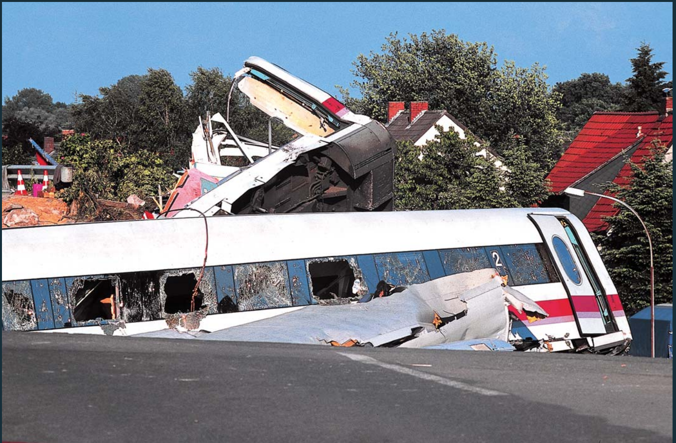
Durch den Aufprall des quergestellten Mittelwagens Nr. 3 stürzte die Straßenbrücke ein. Die hinteren Wagen zerschellten regelrecht in den Beton- und Stahltrümmern.
