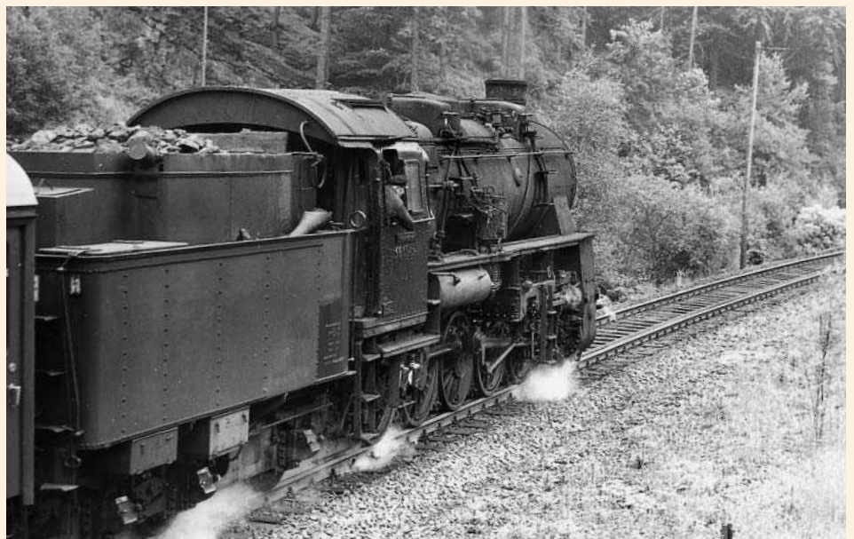
Typen-Porträt der 58 1535 (oben). – Auf Strecke die 58 1345 (unten) mit pr. 3 T 20-Tender und Kesselspeiseventil vor dem Dampfdom, aufgenommen 1976.
