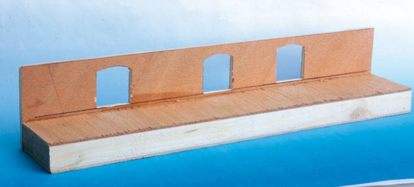
Ein Stück 19 mm starke Tischlerplatte plus eine Rückwand aus 5-mm-Sperrholz bilden die Basis der Rampe.
