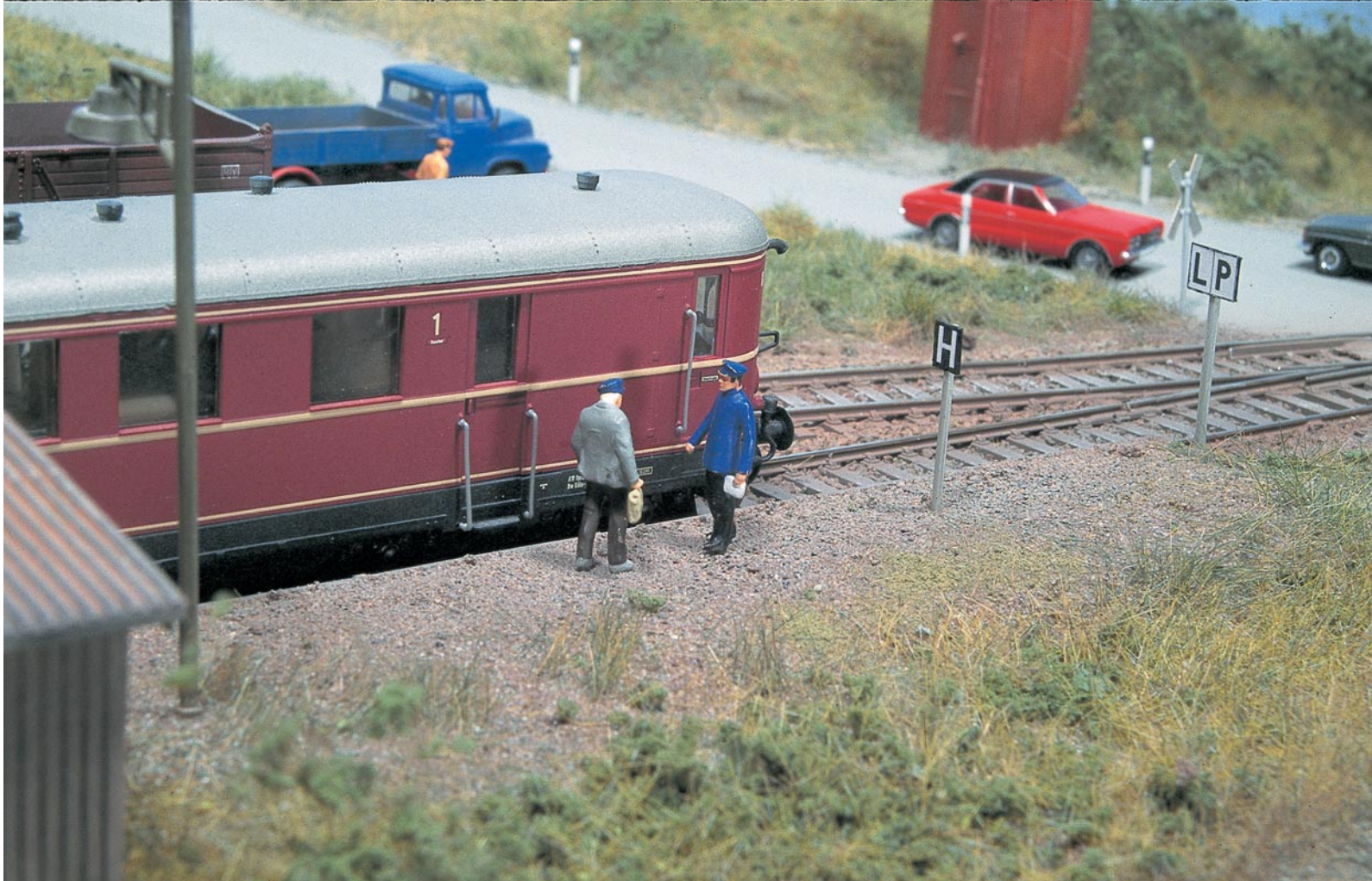
Signaltafeln sind Signale ohne Signale zu sein – jedenfalls im engeren Sinne: Die Haltetafel Nr. 5 zeigt dem Lokführer, wo er im Bahnhof zum Stehen zu kommen hat, die Tafeln BÜ 5 und BÜ 4 zeigen, dass er vor der Weiterfahrt zu läuten und zu pfeifen hat.
