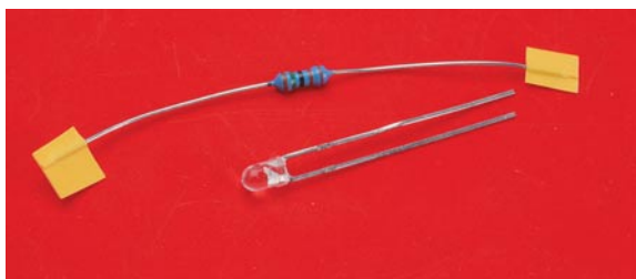
Eine der verwendeten LEDs mit passendem Widerstand.
