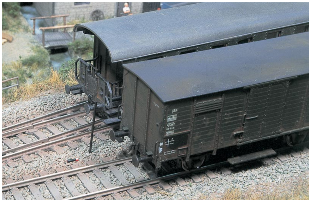
Bis hierher und nicht weiter: Der Drahtstift markiert die Stelle, wo das daneben liegende Grenzzeichen seinen Platz finden wird.
