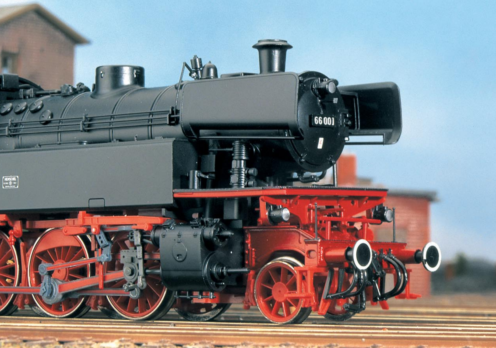
Auffälligste Unterscheidungsmerkmale von 66 001 und 66 002 sind die Kohlenkästen sowie die Kesselringe der jüngeren Maschine. Doch auch die Anschriften differieren. ALLE FOTOS EJ/SCHOLZ
