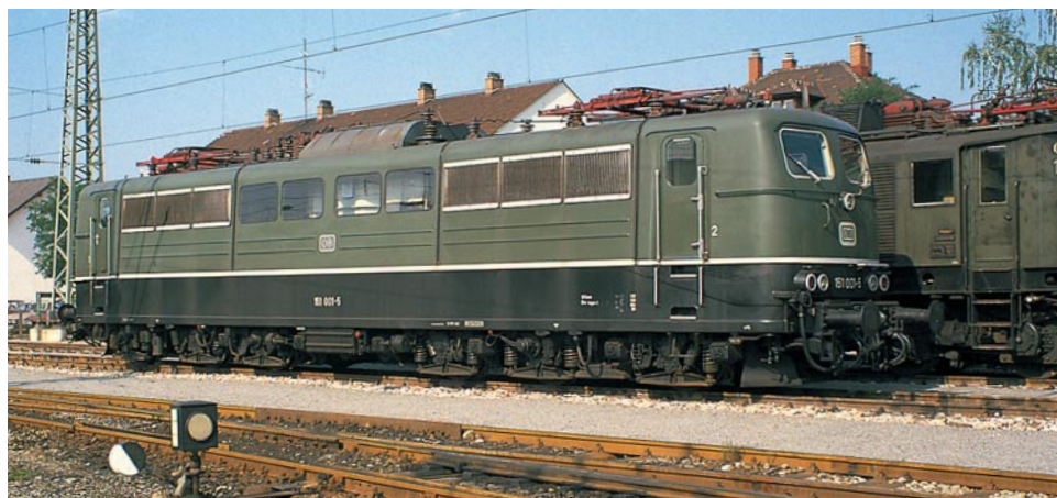
Besonderheiten der 151 001: umlaufende Handstange, drei Trittstufen zu den Führerständen und ein etwas breiterer Steg zwischen den beiden mittleren Maschinenraumfenstern. FOTO LUDWIG WALTER
