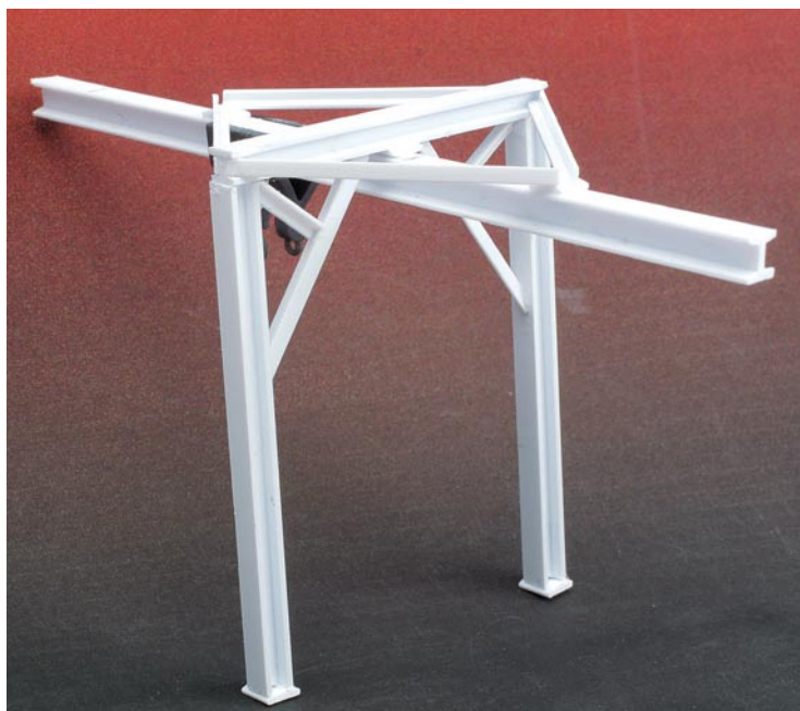
Der aus Plastruct-Profilen gefertigte Kran von der Seite und von oben. Als Auflager dient ein befeiltes und verspachteltes Holzklötzchen (UNTEN LINKS).
