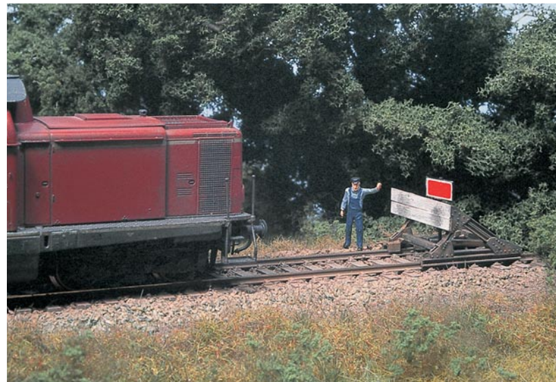
Ein Prellbock wurde mit der roten Tafel Sh 2 ergänzt. Sie kennzeichnet das definitive Streckenende.
