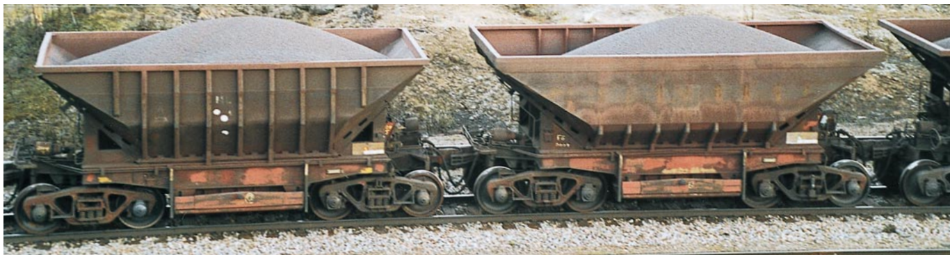
Beladene Erzwagen der Typen Uad (links) und Uadp im Modell (OBEN) und im Original.
