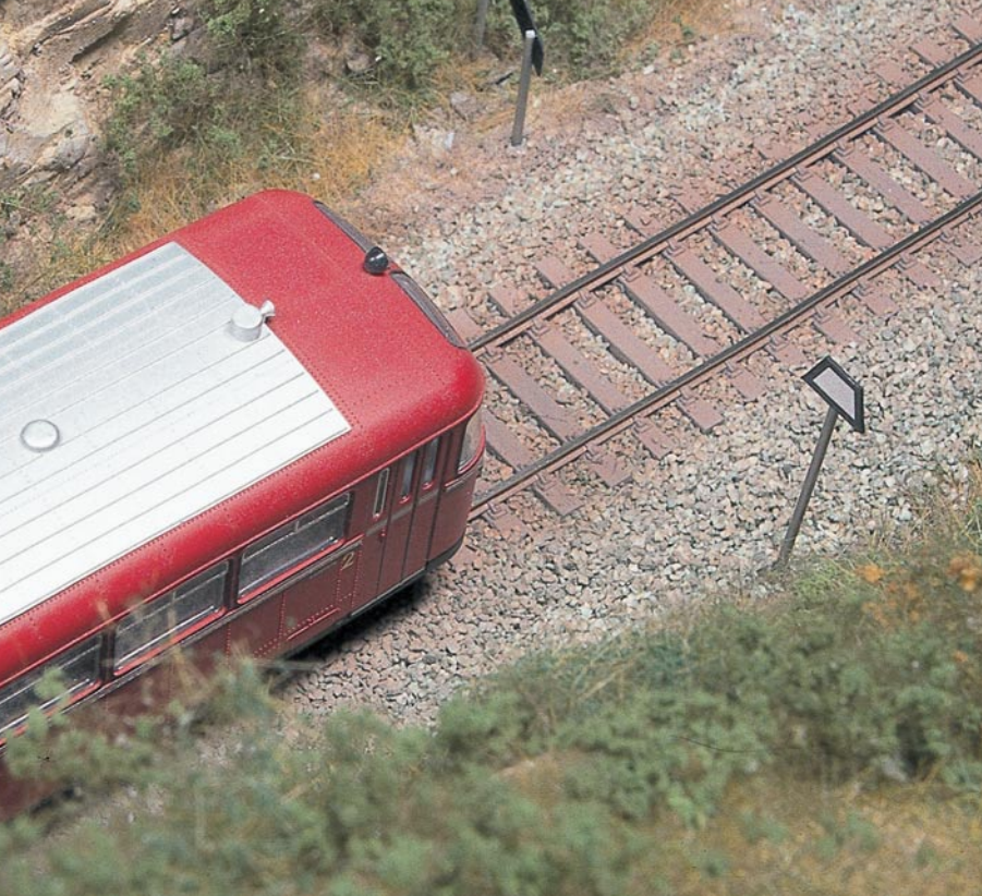
Die Trapeztafel Nr 1 kann auf Nebenbahnen das Einfahrsignal ersetzen. Wird ein Gleis in zwei Richtungen benutzt, steht die H-Tafel an beiden Enden des Bahnsteigs.
