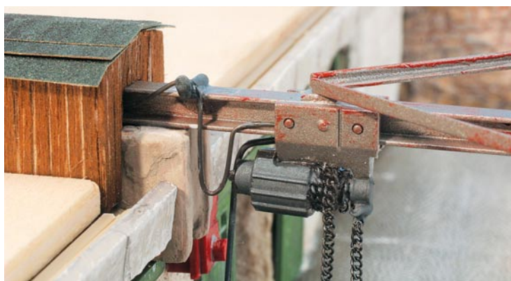
Die Laufkatze des Krans musste stark umgebaut und ergänzt werden. LINKS das Kibri-Original, RECHTS mit Vollmer-Motor, Kabeln und Kette.
