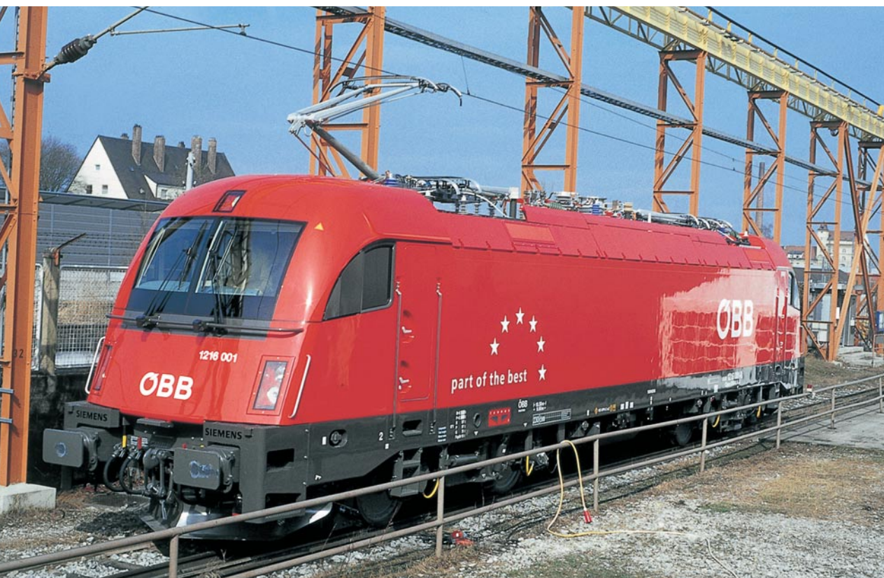
Elegante Mehrsystem-Nachfolgerin der Siemens-Europaloks: Die neue ÖBB-Reihe 1216 entstand aus einer Symbiose von ES 64 F4 bzw. 189 (Elektrik) und Taurus (Form und 230-km/h-Drehgestelle). Hier 1216 001 bei der Präsentation am 31. März 2005 bei Siemens in München-Allach. FOTO DR. HELMUT PETROVITSCH
