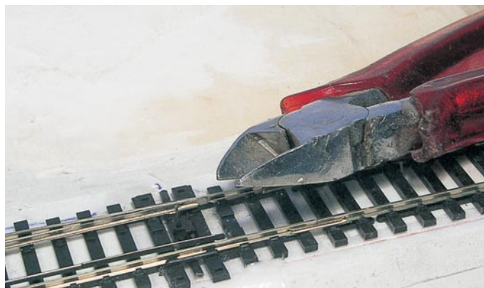
Die Versorgungsleitung zur Polarisierung des Herzstücks. Das aus der Stellschwelle ragende Drahtstück ist abzuzwicken.
