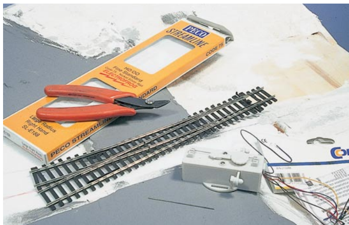
Die Schwellen der Weiche wurden am Straßenübergang seitlich gekürzt. Der Servo-Antrieb von Conrad, hier mit montiertem Stelldraht.
