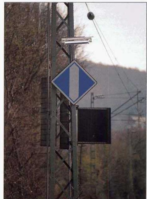
**Bild 4:** Das Signal EI 5 bedeutet "Bügel an".
