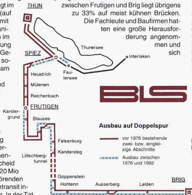
**Bild 6:** Schematische Darstellung des zweigleisigen Ausbaus der Lötschbergbahn. Skizze: GZ/Vorlage BLS
