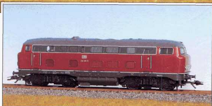
Bild 1: Auf der linken Seite der "Lollo", in der Ausführung der Epoche IV mit der Betriebsnummer 216 005, erkennt man fünf Lüftergitter.
