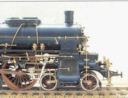
Bilder 1 und 2 (oben): Die Kunststoff-Aggregate und -Leitungen am Kessel wurden gegen Messingbauteile ausgetauscht.
