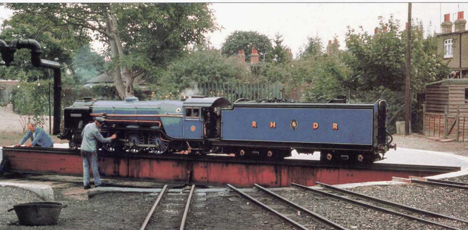
Bild 4: Mit der Handkurbel wendet der Scheibenwärter die Lokomotive Nr. 8 "Hurricane" auf der Drehscheibe in Hythe.
