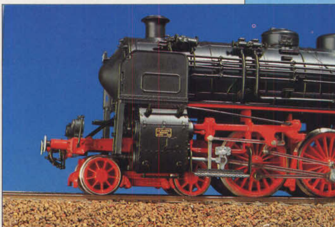
Bild 8: Die RP-25-Vorlaufräder zeugen ebenso wie die filigrane Steuerung und die freistehenden Kesselspeiseventile vom hohen Fertigungsstandard der Rivarossi-18 616.
