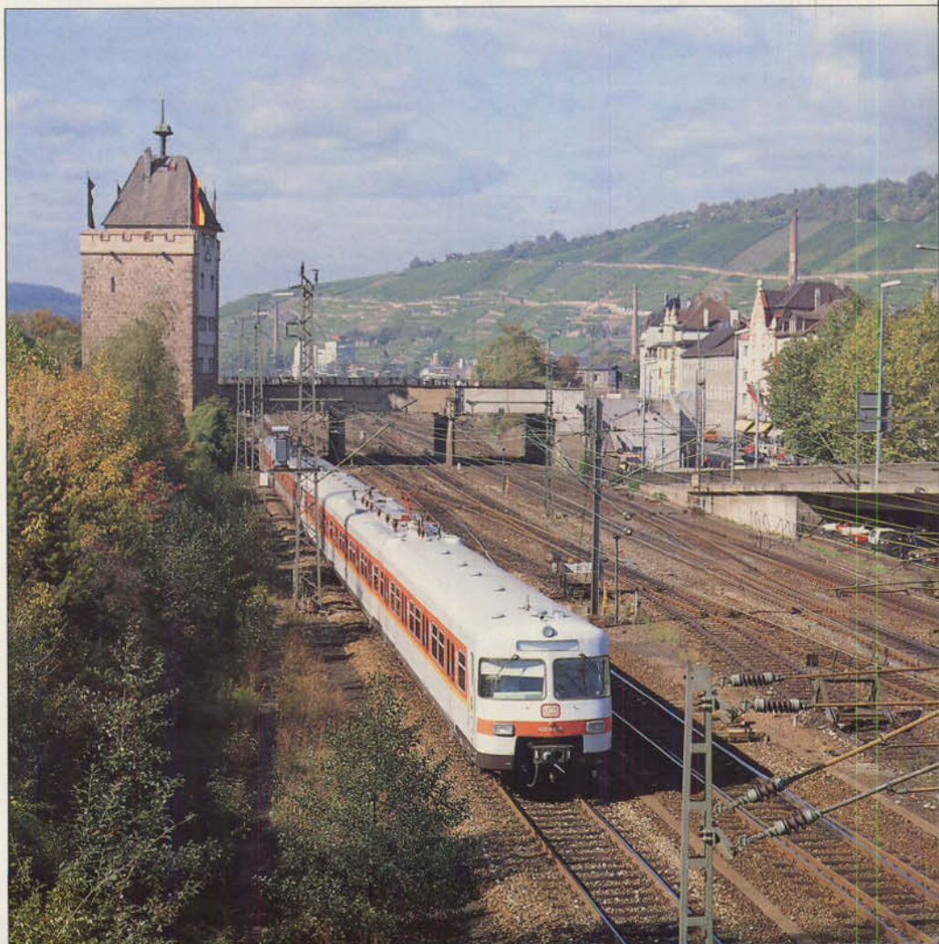
Bild 2: Die in Stuttgart eingesetzte siebte Bauserie verfügt über eine stärkere Bremsenrichtung mit einer zweiten Brems Scheibe. Bisher war es im Hasenbergstunnel gelegentlich zu Rauchentwicklung gekommen. Auf dem Bild ist der 420 915/421 415/420 415 im Bw Plochingen am 5. Mai 1990 zu sehen.
