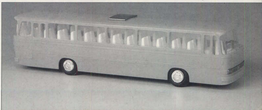
Bild 12 (unten): Nicht nur als Linienbus für den Stadt- und Nahverkehr, sondern auch für Ausflugsfahrten steht jetzt der passende Bus aus der Zeit vor etwa 20 Jahren von I.M.U. bereit. Das Original des Setra-Busses hat eine Länge von 12 m und verfügt über 55 komfortable Sitze für Fernreisen und Ausflüge.
