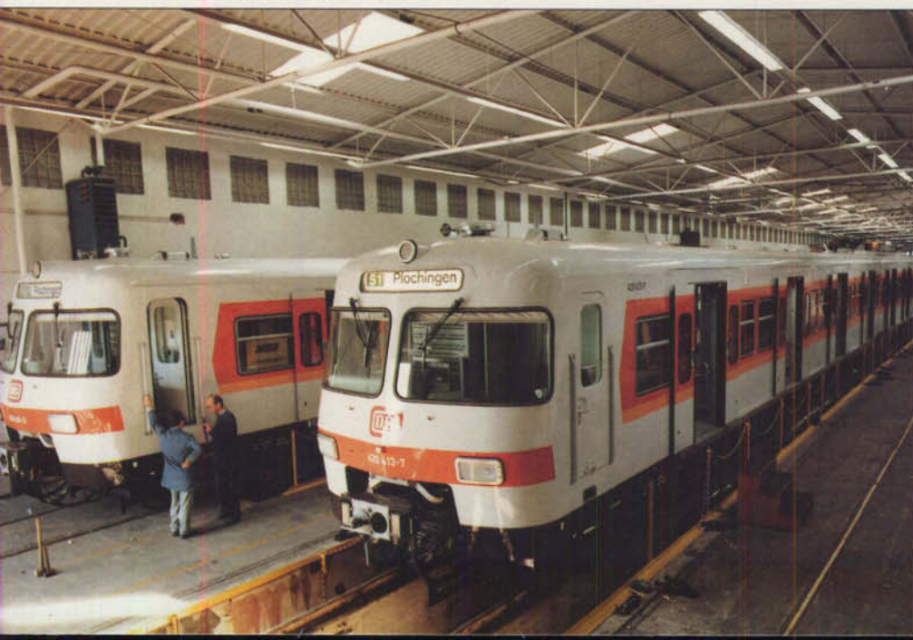
Bild 6: Die beiden ersten Triebwagenzüge der siebten Bauserie stehen in der Produktionshalle von MBB in Donauwörth bereit. Für einen Mehrbedarf an Triebfahrzeugen für das Münchener S-Bahn-Netz wird über den Einsatz von Doppelstock-Triebwagen nachgedacht, die aus technischer Sicht bereits realisierbar wären. Fotos 4 bis 6: Werkfoto MBB
