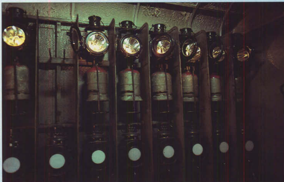
Bild 2: Nach der Wartung muß jede Lampe im fensterlosen Brennraum einen Brenntest bestehen.
