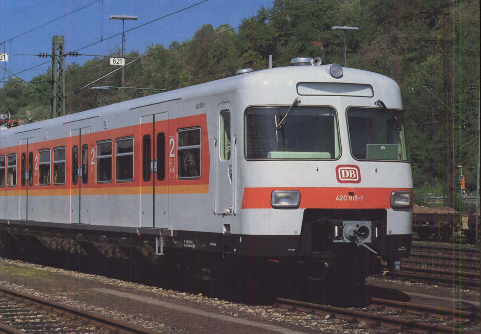
Bild 2: Die in Stuttgart eingesetzte siebte Bauserie verfügt über eine stärkere Bremsenrichtung mit einer zweiten Brems Scheibe. Bisher war es im Hasenbergstunnel gelegentlich zu Rauchentwicklung gekommen. Auf dem Bild ist der 420 915/421 415/420 415 im Bw Plochingen am 5. Mai 1990 zu sehen.
