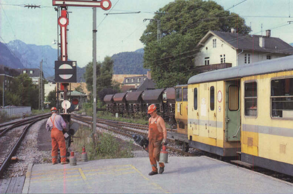
Bild 6: Nicht immer ist die Tätigkeit so leicht wie am Formsignal in Bad Reichenhall, wo der Klv 96-0015 für den Tausch der Propanflaschen direkt am Bahnsteig halten konnte.
