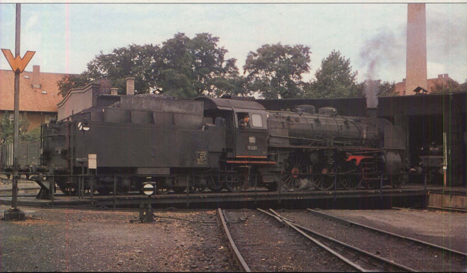
Bild 3: Die Lokomotive 18 620 wurde am 9. August 1964 auf der Drehscheibe des Bw Lindau aufgenommen. Sie ist mit dem gleichen bayerischen Tender 2'2 T 27,4 gekuppelt wie die Maschine 18 616, der jedoch weniger verbreitet war als die größeren Ausführungen 2'2 T 31,7 und 2'2 T 32,5. Foto: H. Koppisch
