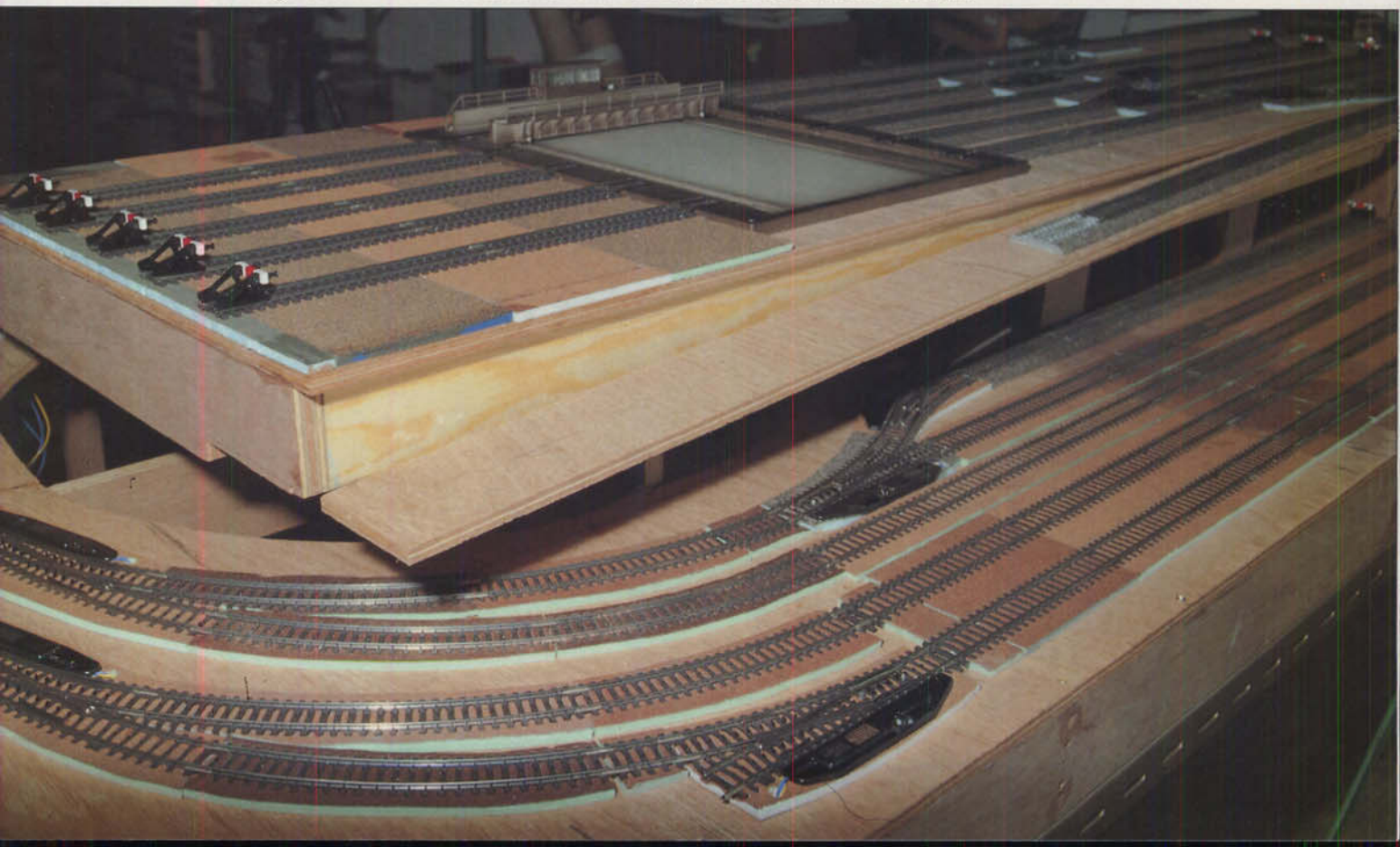
Bild 13: Die nach unten führende Trasse muß noch bis zum Anlagenende verlängert werden, damit das Gleis hinter der Spitzkehrenweiche eine kurze Tenderlokomotive und zwei O-Wagen, die z.B. mit Kohle beladen zum AW müssen, zum Umsetzen aufnehmen kann.
