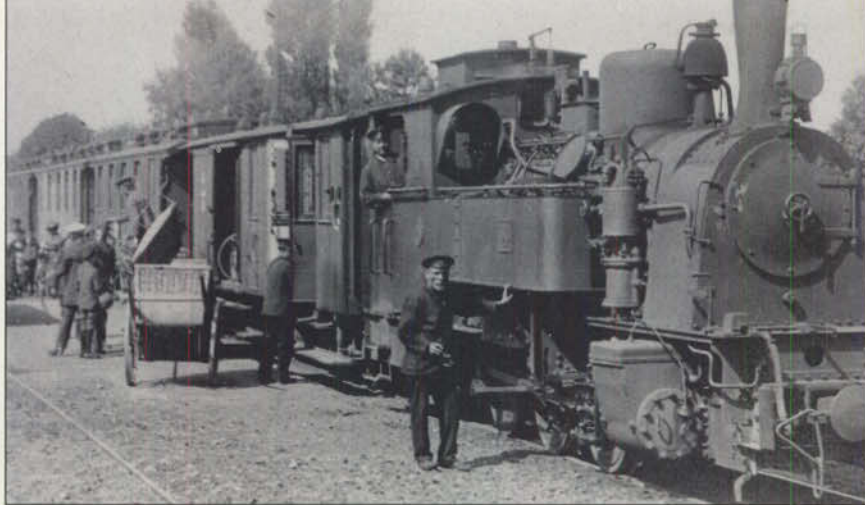
Bild 14 (darunter): Diese Hagans-Maschine von 1902 tat auf der Feldbahn als (T 3 e ) Erfurt 81 Dienst. Die letzte Achse wurde über Kurbeln angetrieben.
