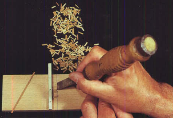
Bild 42: Das Ablängen der Schindeln geschieht auf der selbstgebauten Lehre mit einem scharfen Stecheisen.
