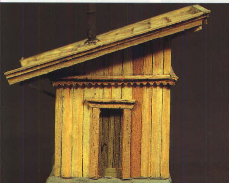
Bild 40: Die charakteristische Pultdachform zeigt die Seitenansicht. Die aus mehreren Leisten bestehende Dacheinfassung ist bereits montiert. Das gleiche gilt für die Türeinfassung.
