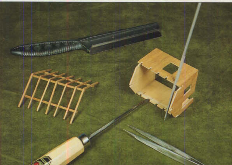
Bild 49: Die fertig bearbeiteten Wände sind an den Ecken verleimt. Die Aussparungen für den Dachstuhl sind vorbereitet.
