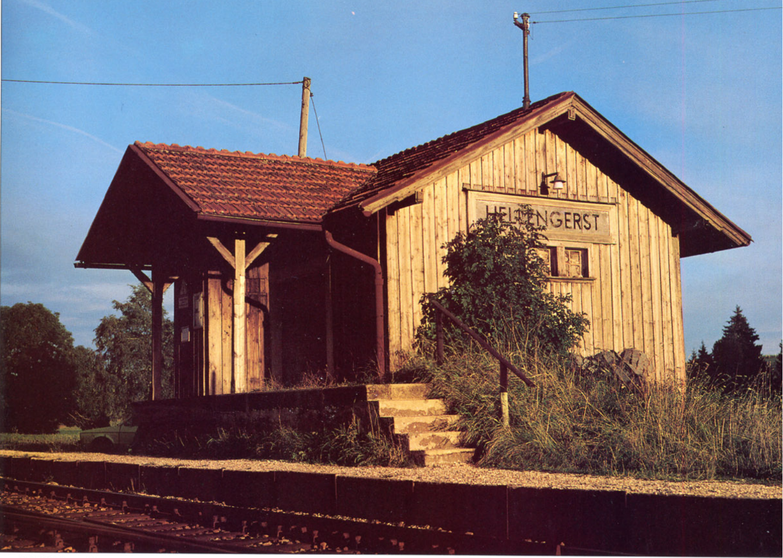
Bild 4: Dieses Foto verdeutlicht die einfache, kostensparende Bauweise der Hochbauten an den bayerischen Nebenbahnen.
