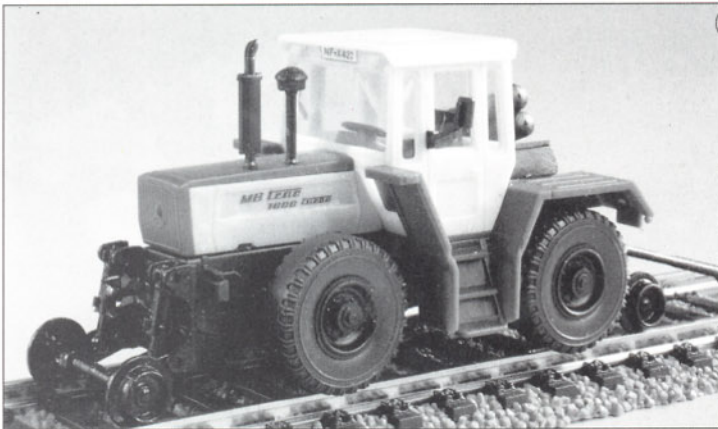
◀ Bild 4: Von Kibri stammt der Bausatz eines MB-Track mit Zweibegeausrüstung, der sich vor allem als Rangierfahrzeug auf Straße und Gleis vorbildgerecht einsetzen läßt. Werkfoto
