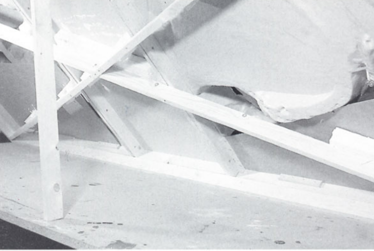
Bild 6: Die Anlagenplatte von unten. Der Zusatzrahmen ist bereits mit den Anlagenteilen verleimt.
