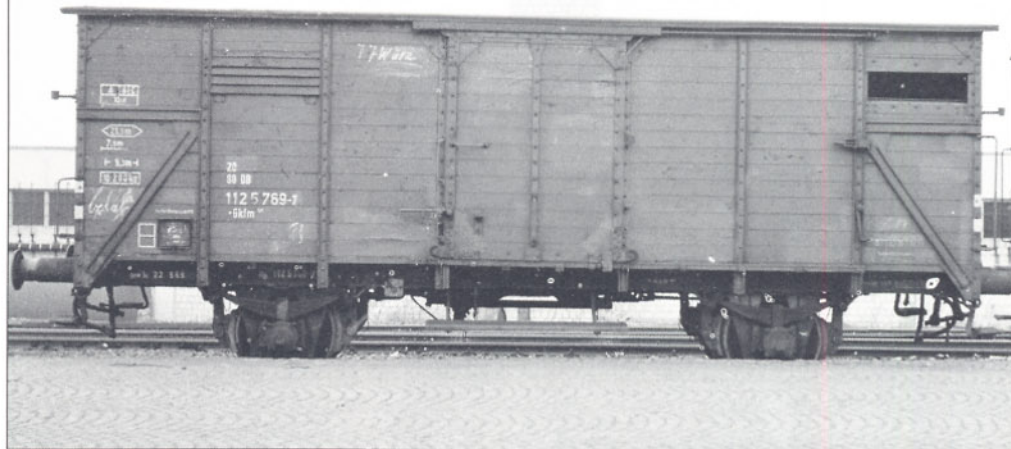
Bild 7: Als Gkln 191 hier schließlich der Wagen mit der UIC-Nummer 20 80 112 5 769-7 im Jahre 1969. Er hat inzwischen seine internationale Verwendungsfähigkeit und damit sein RIV-Zeichen eingebüßt (d. h. er entspricht nicht mehr den RIV-Bestimmungen und darf deshalb nicht mehr international eingesetzt werden). Foto: F. Burkhardt, Sammlung Diener
