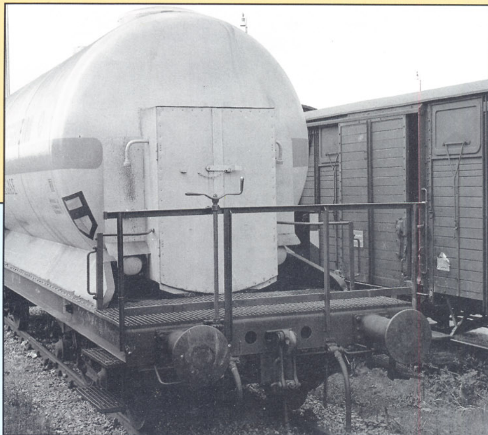
Bild 4: Am Handbremsende des Wagens befindet sich ein Geräteschrank. Die Bühnenabdeckung und die Aufstiege sind als Gitterroste ausgeführt. Fotos und Zeichnung: H. Obermayer
