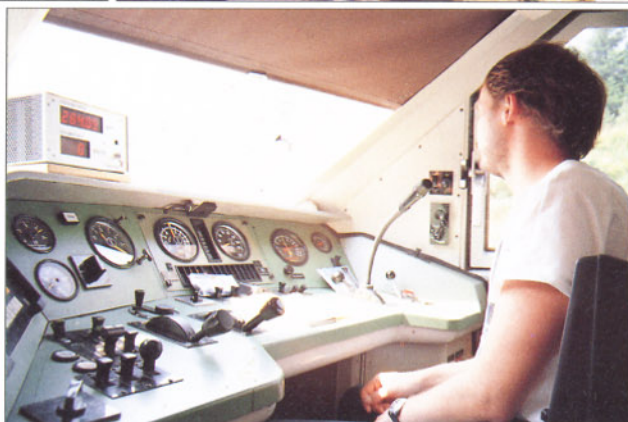
Bild 6: Die Lokführer finden im ICE Vertrautes. Ihr Arbeitsplatz entspricht im Wesentlichen dem in den Baureihen 111 und 120. Fotos 1, 3 bis 6: T. Kohnen
