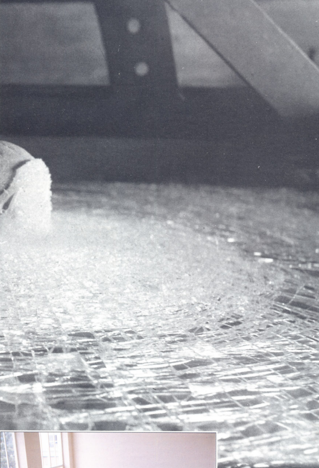
Bild 1: Obwohl bei diesem Versuch das Geschöß die Lok-Frontscheibe mit rund 400 km/h traf, fiel sie nicht aus dem Rahmen. Ganz besonders bemerkenswert ist die Beule am Auftreffpunkt.
