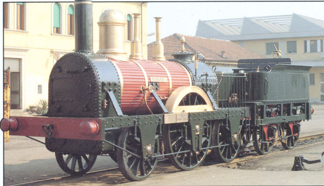
Bild 1: So sah die "Bayard" der ersten italienischen Eisenbahnstrecke von Neapel nach Portici (1839) aus. Der Nachbau von 1939 ist jetzt anlässlich des 150jährigen Bestehens der FS in der Werkstätte Cremona wieder in betriebsfähigen Zustand versetzt worden. Foto: E. Ganzerla
