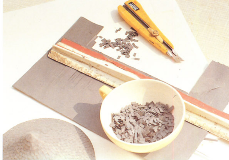
Bild 5: Ein Raster von 3 x 5 mm wird aufgezeichnet und anschließend mit einem sehr scharfen Messer ausgeschnitten.
