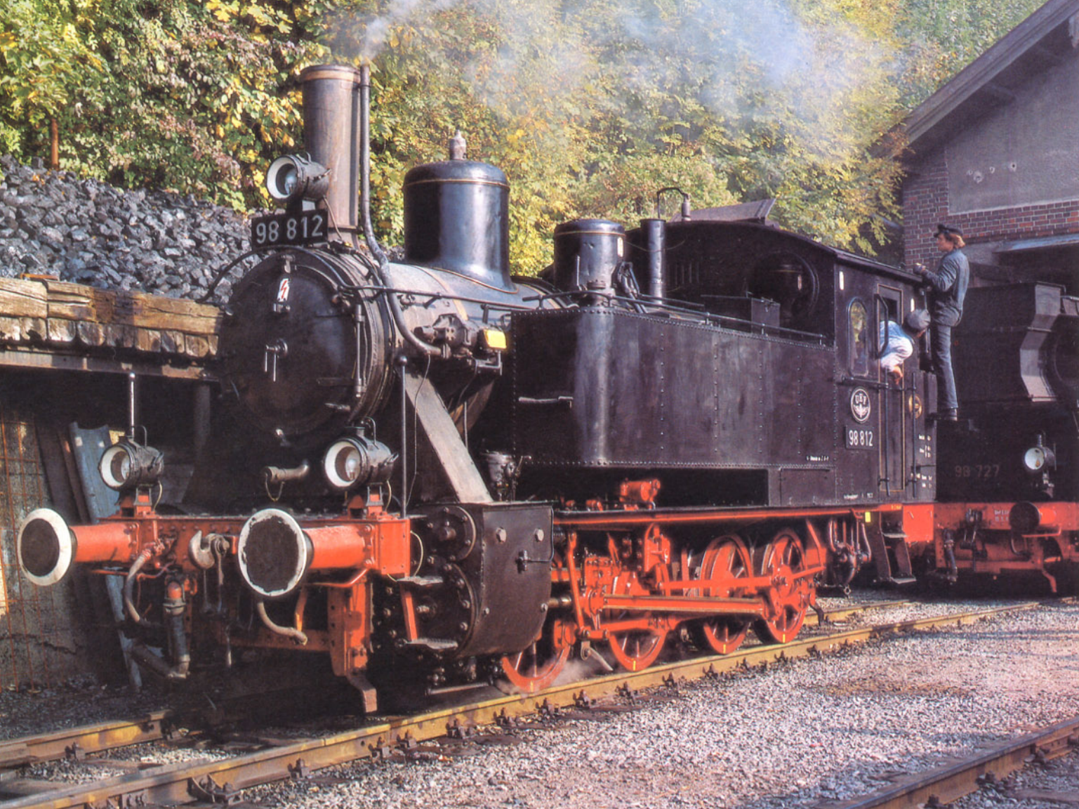
Bild 1: Von Krauss & Comp. wurde die 98 812 als GtL 4/4 2562 im Jahre 1914 an die Königlich Bayerischen Staatseisenbahnen geliefert. Heute befindet sie sich im Besitz der Ulmer Eisenbahnfreunde und wurde am 1./2. Oktober 1988 bei der Bahnhofskirta in Tegernsee eingesetzt.
