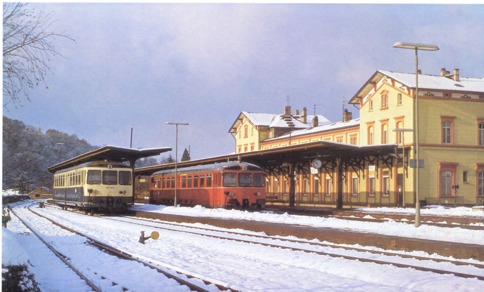
Bild 11: 1985 waren im Lahntal noch Akkutriebwagen der Baureihe 515 im Einsatz. In Diez begegneten sich am 28.11.1985 der 515 128 und der 515 655. Foto: H. Diehm
