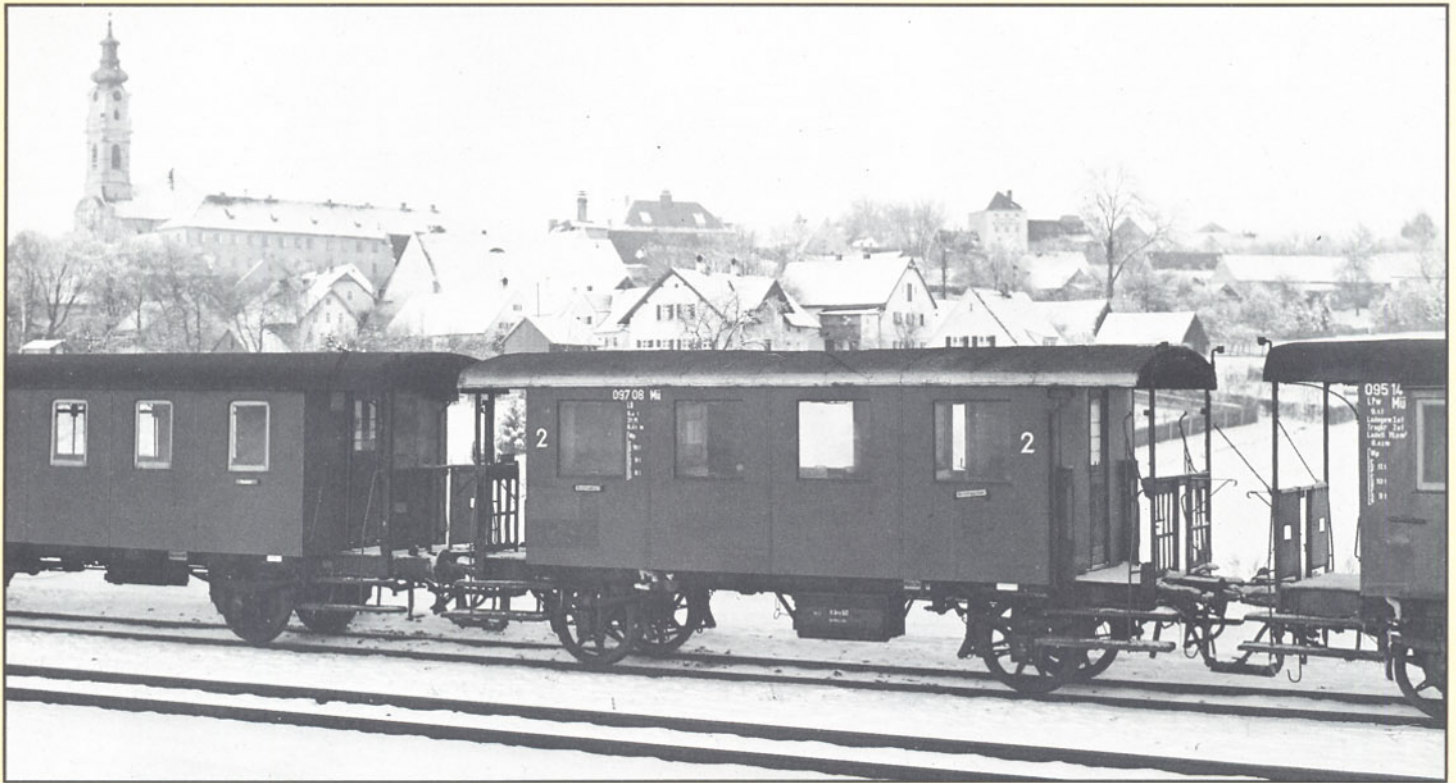
Bild 1: Mitte der fünfziger Jahre waren noch etliche bayerische Lokalbahnwagen leichter Bauart bei der Deutschen Bundesbahn im Einsatz. Diese Aufnahme aus Altomünster vom 30.12.1956 zeigt den 09708 M u , der als CL (nach Blatt 569) von den Bayerischen Staatseisenbahnen in Dienst gestellt worden war. Foto: Dr. Scheingraber
