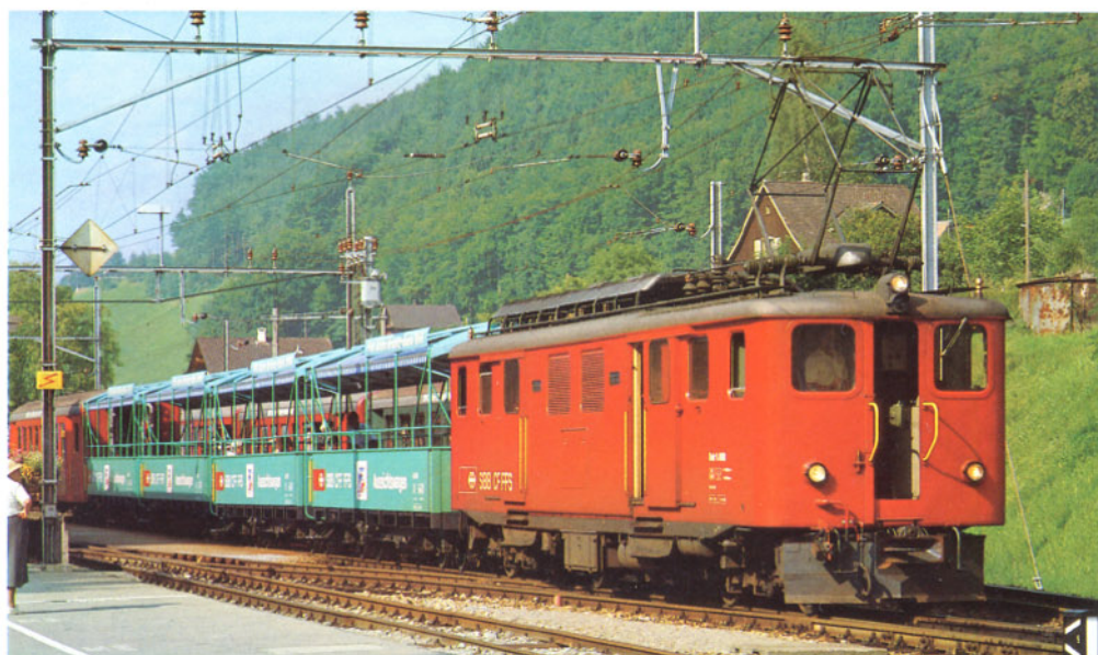
Bild 16: Nur im Sommer werden die Aussichtswagen By 881-884 auf der Bergstrecke eingesetzt. Sie sind aus vier offenen Güterwagen umgebaut worden. Foto: K. Eckert
