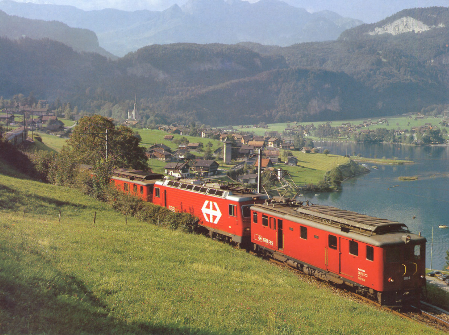
Bild 14: Bei Lungern entstand diese Aufnahme. Dreifachtraktionen dieser Art – zwei Gepäcktriebwagen, vorne der Deh 4/6 904 und die HGe 4/4 II 1952 in der Mitte – entstehen im Spitzenverkehr aus betrieblichen Gründen. Foto: K. Eckert
