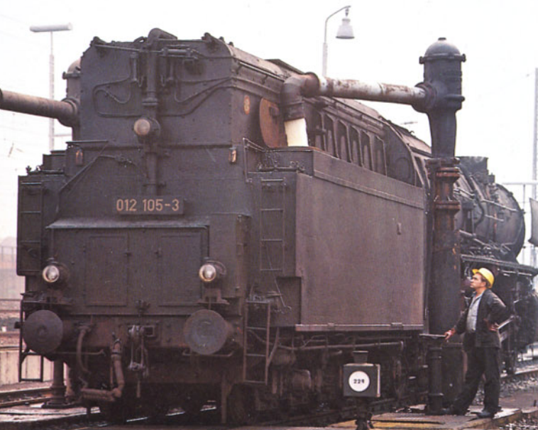
Bild 6: In den mächtigen Tendern konnte 38 m 3 Wasser mitgeführt werden. Foto: H. Obermayer
