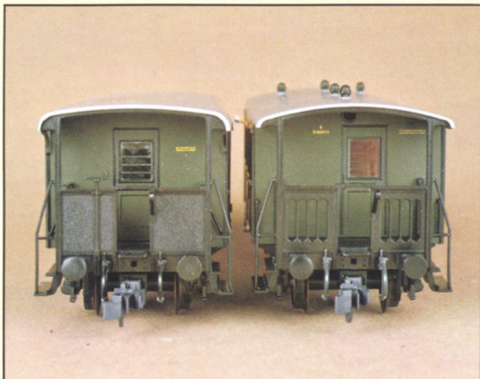
Bild 14: Sehr gut zu erkennen sind auf diesem Foto die unterschiedlichen Dachwölbungen der Roco-Modelle des PwL Bay 96 (links) und des CL Bay 06b (rechts).
