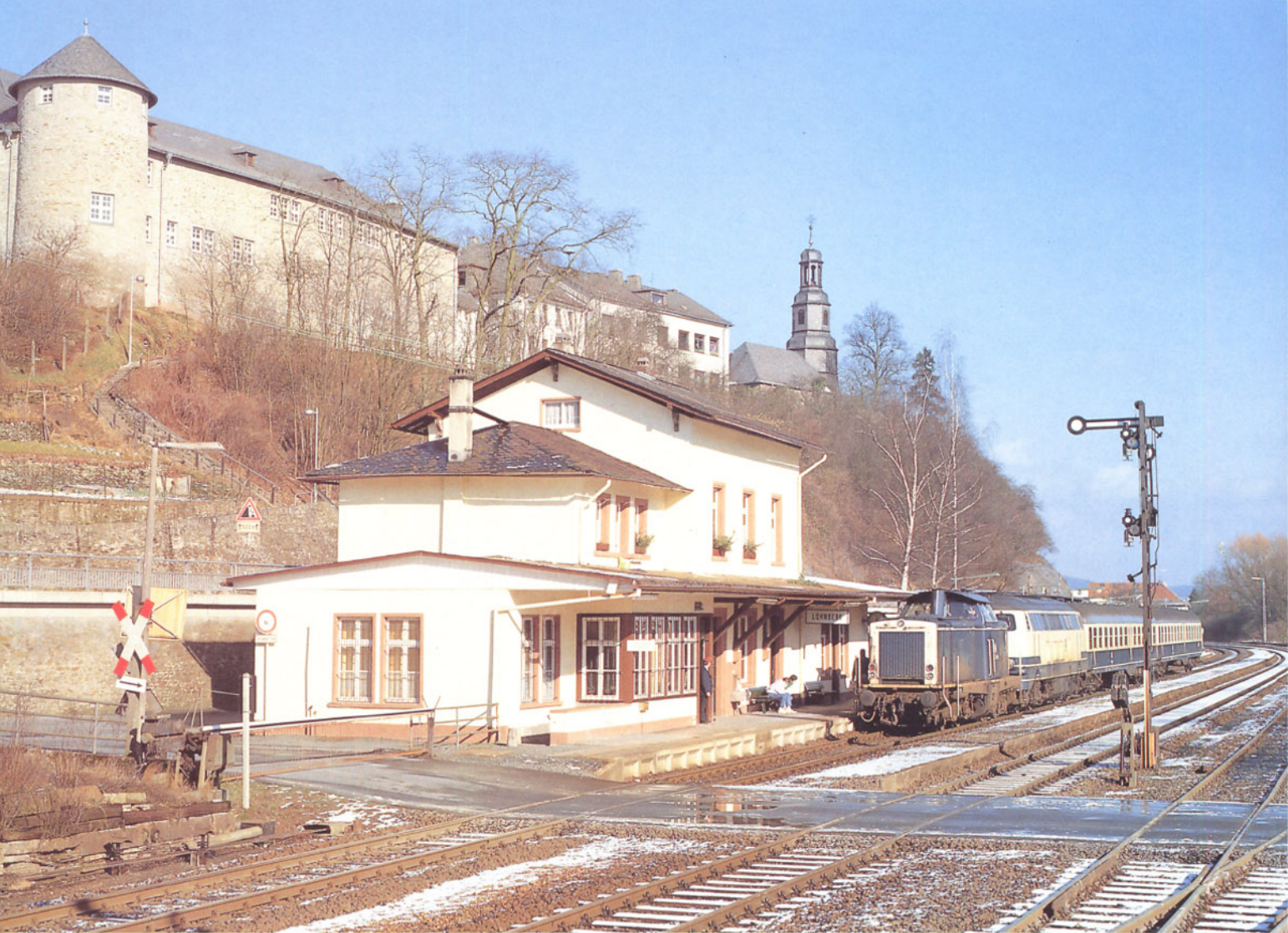
Bild 8: Am 13.02.1988 wurde die 212 268 (Bw Gießen) der 216 205 (Bw Kassel) mit dem N 6928 vorgespannt, um eine umlaufbedingte Leerfahrt der Lok einzusparen. Die Aufnahme entstand im Bahnhof Löhneberg. Foto: U. Kandler
