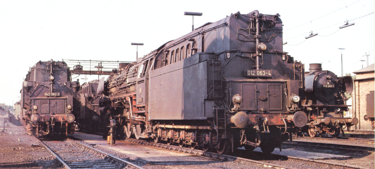
Bild 5: Der Ölbehälter der fünfachsigen Tender hat ein Fassungsvermögen von 13 m 3 . Insgesamt wurden 34 Maschinen der Baureihe 01.10 mit einer Ölfeuerung ausgerüstet. Foto: U. Geum
