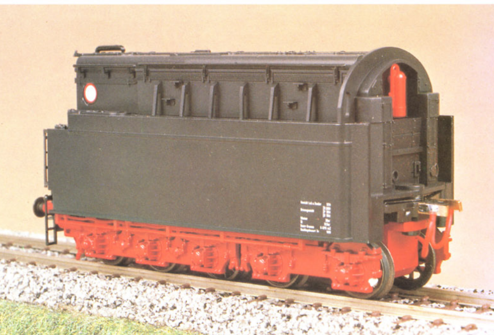
Bild 4: Der gelungene Öltender – diesmal von der Frontseite her aufgenommen – mit dem Feuerlöscher und der neuen stromführenden Kurzkupplung.
