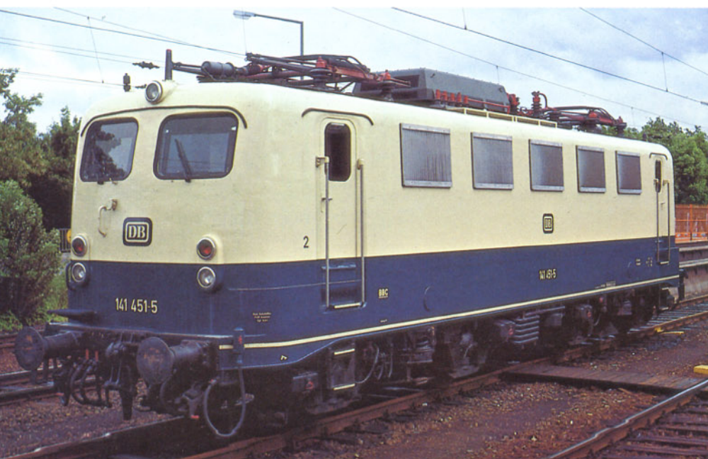
Bild 6: Die höchste Ordnungsnummer erhielt die 141 451. Sie wurde ab Werk mit einer Nutzbremse ausgerüstet, was an den Dachaufbauten zu erkennen ist. Die Aufnahme entstand am 25. Juni 1984 in Osnabrück Hbf. Foto: R. Köstner
