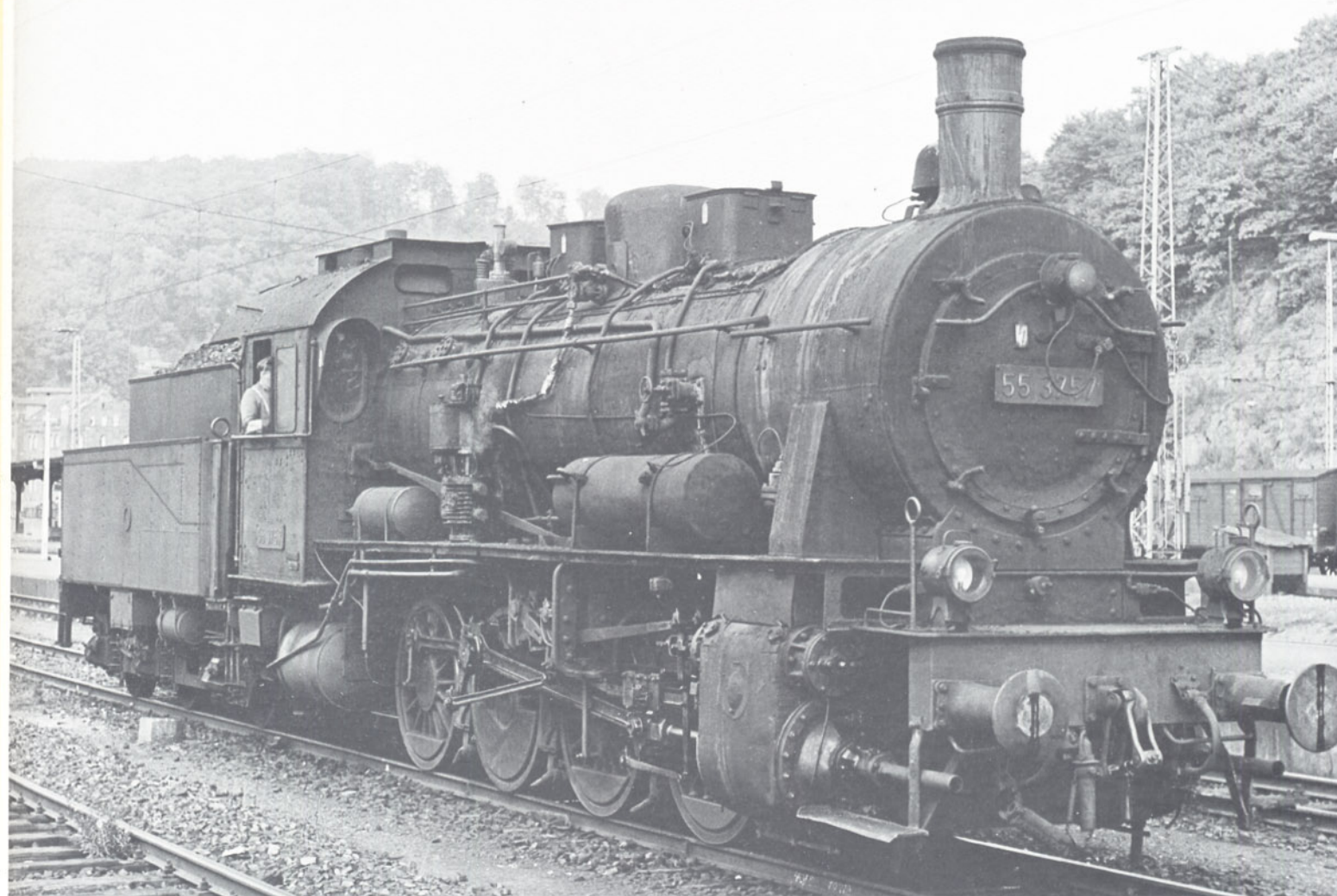
Bild 5: In Dillenburg war die 55 3757 beheimatet. Sie verfügte über dicht beieinanderliegende Dome.
