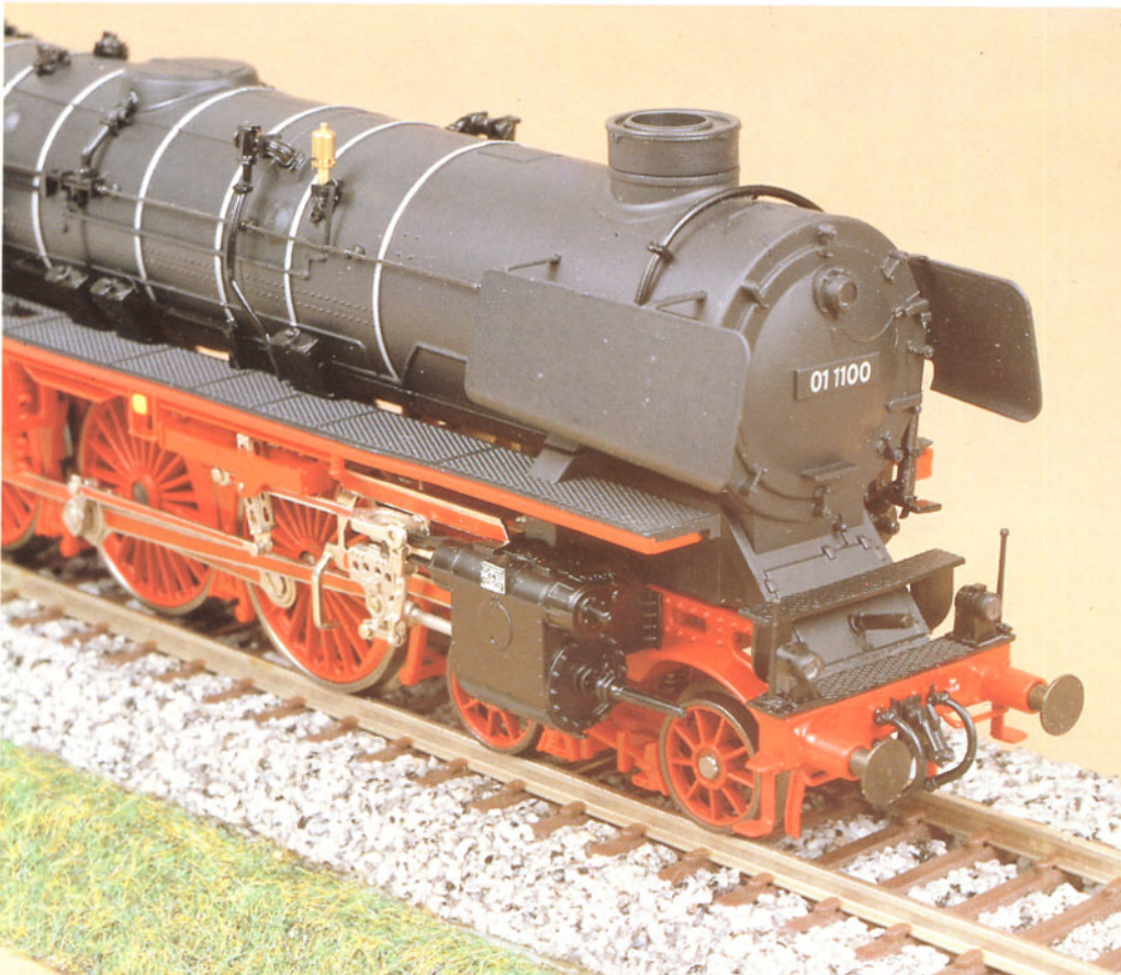
Bild 6: Blick auf die Frontpartie mit dem korrekt angeordneten Trittblech vor der Rauchkammer und dem Schornsteinaufsatz. Alle Fotos: H. Obermayer
