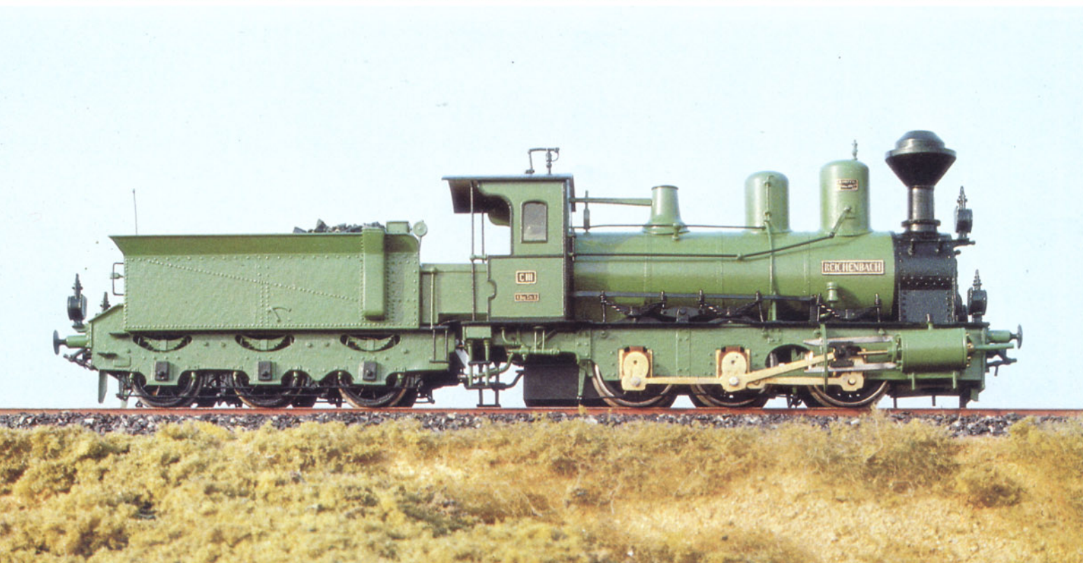
Bild 5: Die Lokführerseite des C III-Modells. Das Außenrahmen-Fahrgestell war für bayerische Hauptbahnmaschinen der achtziger Jahre des vorigen Jahrhunderts charakteristisch.
