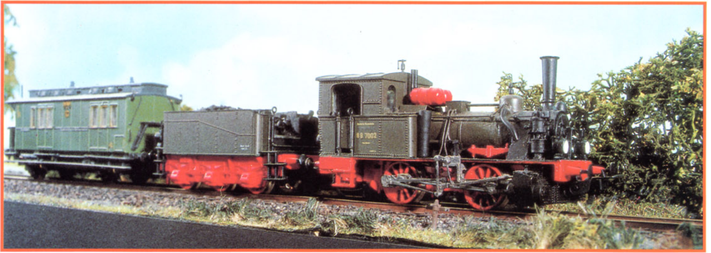
Bild 15: Viele Lokmodelle entstanden aus dem Umbau von Industriemodellen: Hier die 88 7002, ex T 1 Nr. 105 der LBE, mit zusätzlichem Tender.
