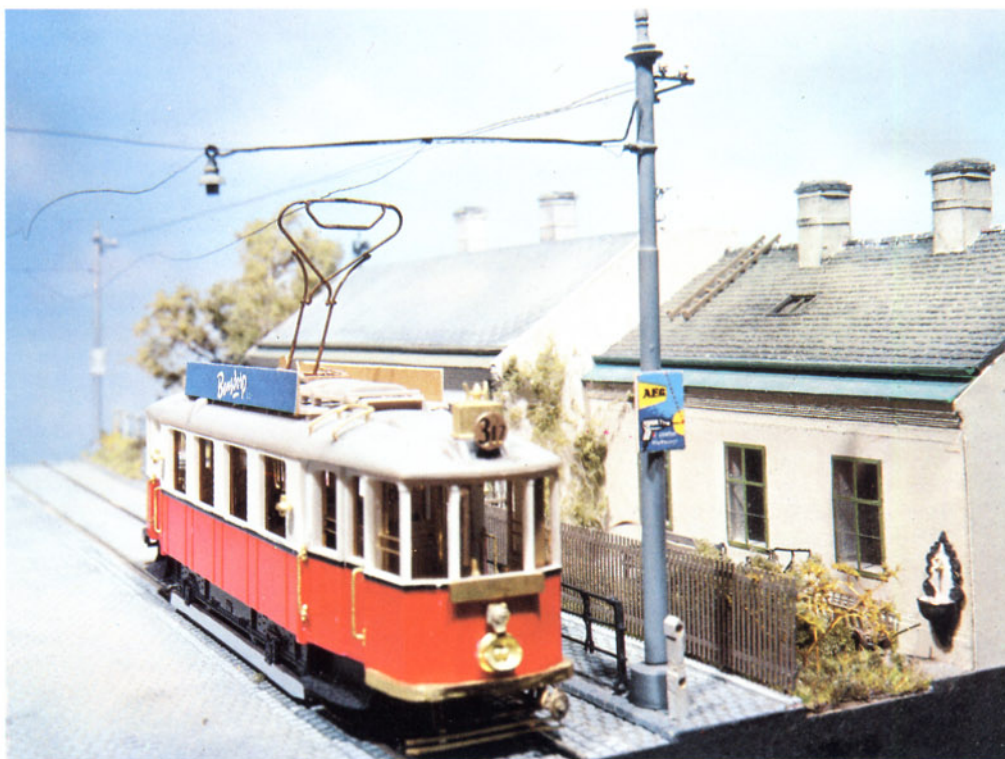
Bild 4: Straßenbahntriebwagen der Serie M. Die gesamte Inneneinrichtung besteht aus Messinggätsteilen.
