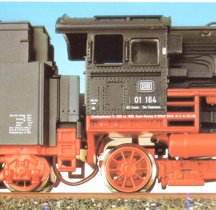
Bild 15: Das Fleischmann-Modell der 01 164 zeigt die richtige Anordnung der Anschriften auf der Lokführerseite.
