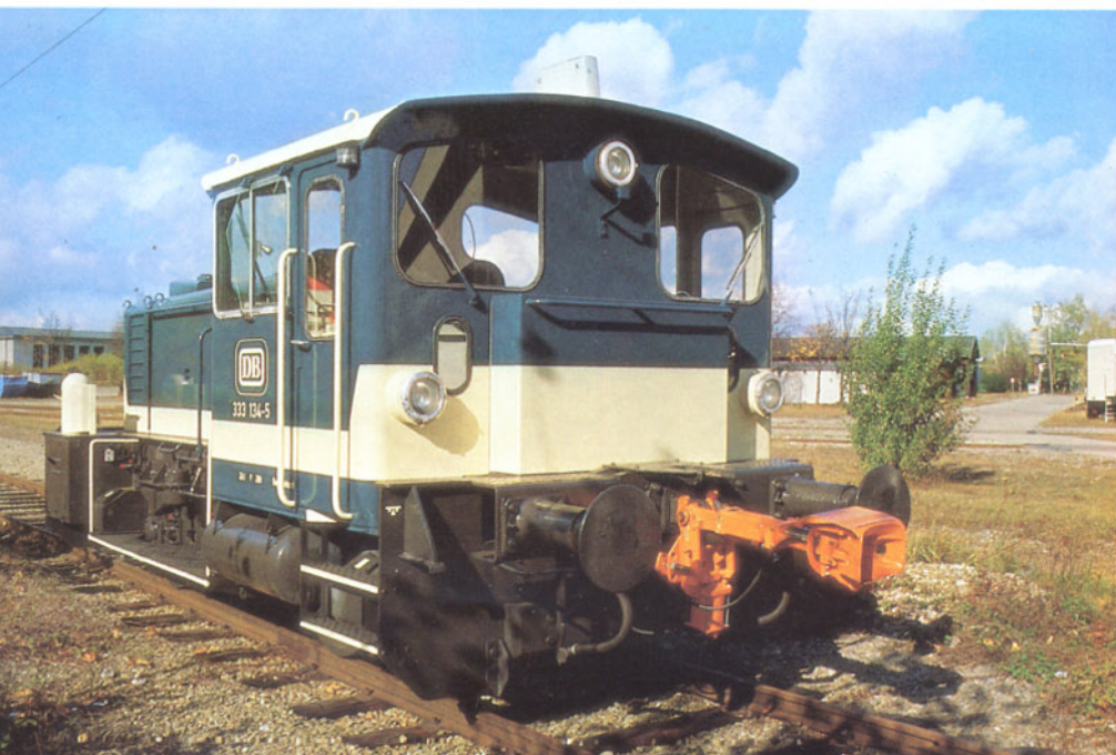
Bild 2: Die mit Funkfernsteuerung ausgerüsteten Lokomotiven der Baureihe 333 weisen an der Rückwand des Führerhauses eine neu geschaffene Auskoffnung auf. Das Foto zeigt die 333 134 des Bw Ingolstadt vor der Umzeichnung in 335 134. Foto: BZA München (H. Bechtner)
