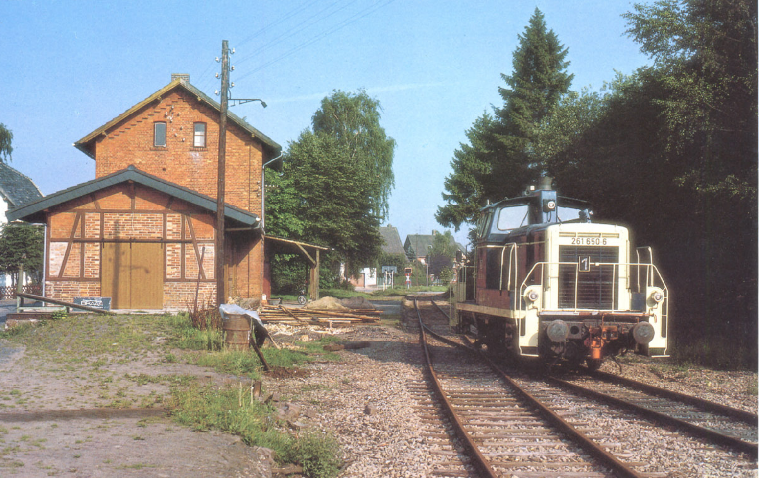
Bild 12: Im Sommer 1986 rüstete das AW Kassel die 261 650 mit der Funkfernsteuerung der 261 839 aus. Die 261 839 war eine der drei ersten Lokomotiven dieser Baureihe, die von der Industrie mit einer Prototyp-Funkfernsteuereinrichtung ausgerüstet worden waren. Um eigene Umbauerfahrungen zu sammeln und die Kosten für den Umbau besser kalkulieren zu können, beschloß die DB, die Funkfernsteuereinrichtungen aus der 261 839 aus- und in die 261 650 einzubauen. Die damals noch als 261 650 bezeichnete Lokomotive rangiert am 01.09.1987 in Eschershausen (Strecke Vorwohle – Emmerthaler Verkehrsbetriebe, abgekürzt VEV). Foto: C. Bohn
