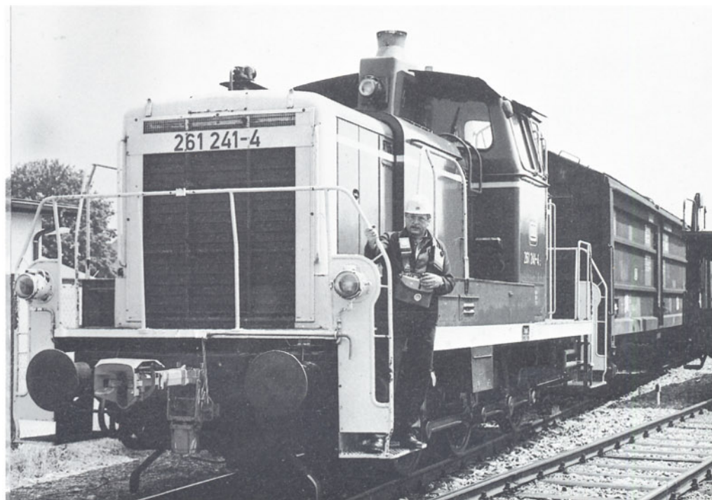
Bild 11: Der Führerstand der Rangierlok ist während des funkferngesteuerten Rangierens immer unbesetzt. Befindet sich die Lokomotive an der Zugschleife, steuert der Lokrangierführer bei den Lokomotiven der vormaligen Baureihe V 60 die Rangierfahrt von einer der beiden vorderen tief liegenden Trittflächen aus. Foto: BZA München (H. Bechtner)
