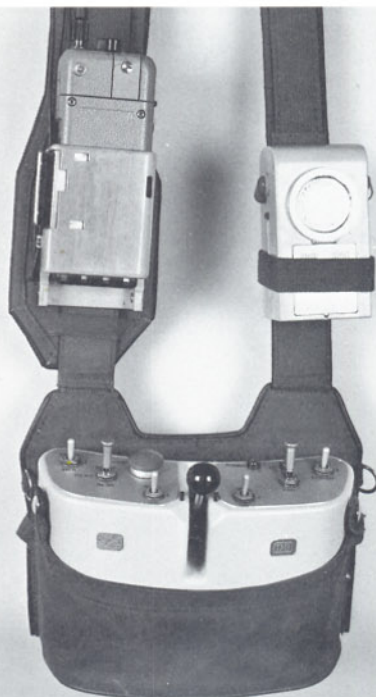
Bild 10: Das Fernsteuerbediengerät mit Tragegeschirr und Zusatzausrüstung (Sprechfunk "Teleport 9" und Handlampe). Foto: BZA München
