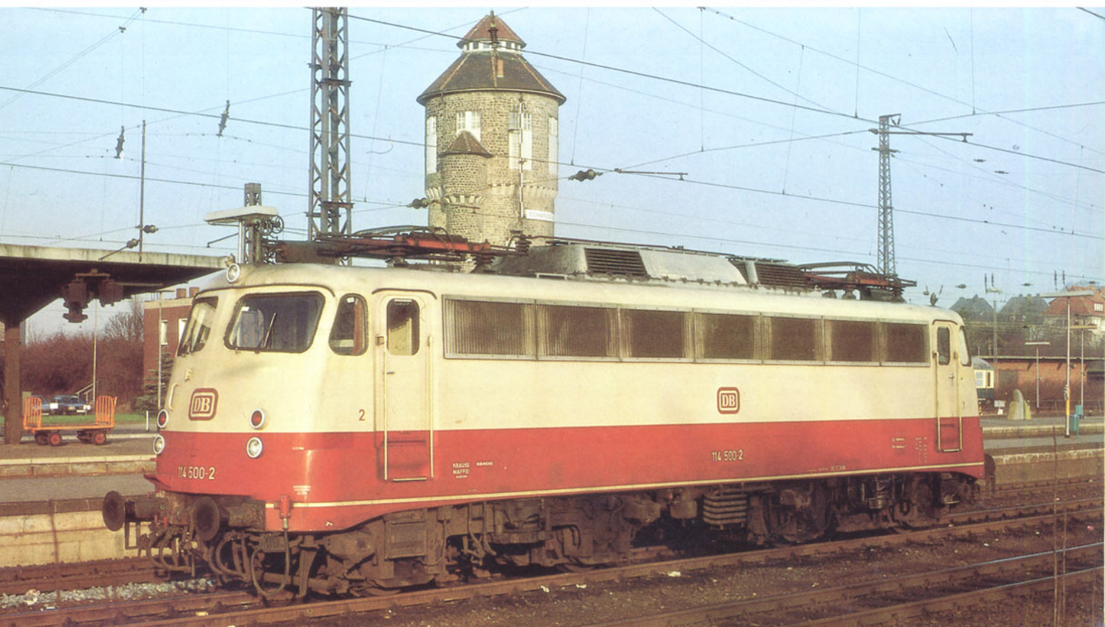
Bild 2: Zu Beginn des Jahres 1988 wurden die Lokomotiven 112 485 bis 504 in 114 485 bis 504 umgezeichnet, weil sie im Gegensatz zu den anderen Lokomotiven der Baureihe 112 nur noch für eine Höchstgeschwindigkeit von 140 km/h zugelassen sind. Die 114 500 wurde am 18.01.1988 in Osnabrück Hbf im Bild festgehalten. Foto: R. Köstner
