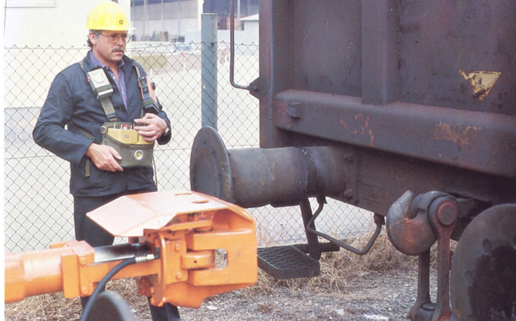
Bild 9: Die automatische Rangierkupplung, Bauart 55, der Firma Scharfenberg, mit denen die funkferngesteuerten Rangierlokomotiven der Baureihen 335, 364 und 365 beidseitig ausgerüstet sind, entlastet den Lokrangierführer weitgehend von den beschwerlichen Kuppelarbeiten. Das Lösen der automatischen Rangierkupplung erfolgt über das Fernsteuerbediengerät. Foto: BZA München (H. Bechtner)
