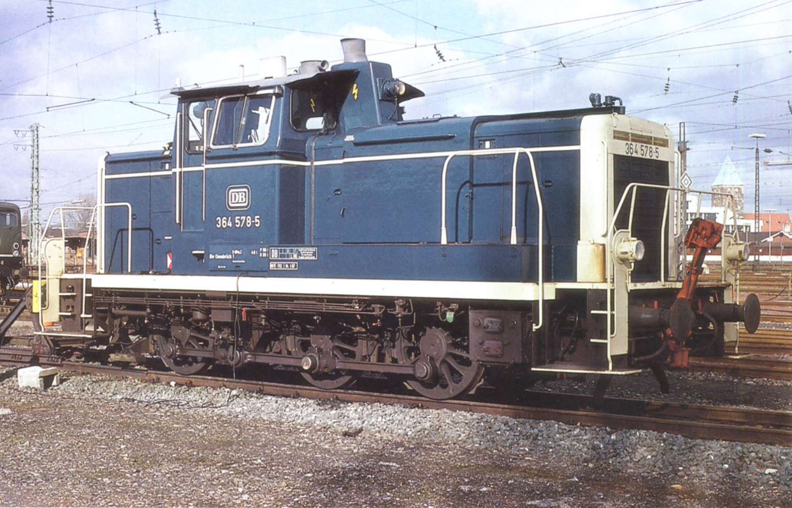
Bild 1: Aus der 260 578 wurde im Oktober 1987 durch Umzeichnung die Kleinlokomotive 360 578 und, weil sie über eine Funkfernsteuerung verfügt, zu Jahresbeginn 1988 die 364 578. Nach den derzeitigen Planungen der DB wird sie voraussichtlich auch die einzige Vertreterin der Baureihe 364 bleiben, denn zukünftig sollen keine Lokomotiven der Baureihe 360, sondern nur noch Maschinen der Baureihe 361 mit Funkfernsteuerung ausgerüstet werden (die dann in Baureihe 365 umgezeichnet werden). Die Aufnahme entstand am 20.02.1988 im Bw Rheine Pbf. Foto: R. Köstner
