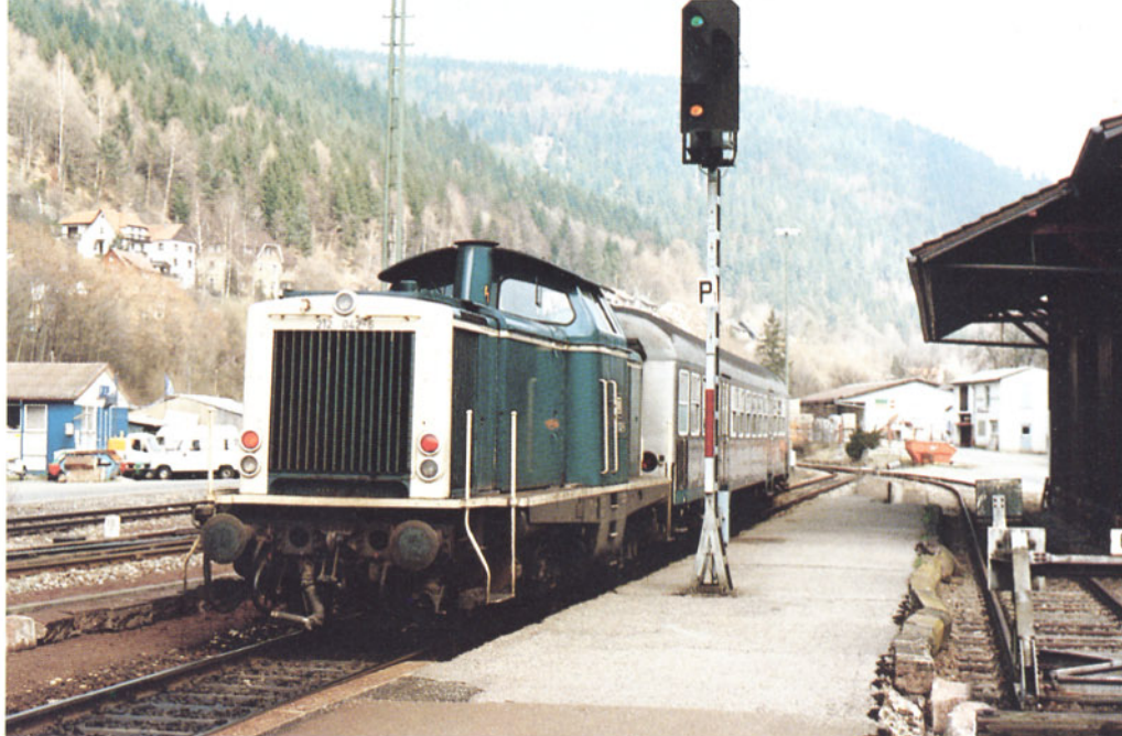
Bild 10: Das Lichtsignal zeigt das Signal Hp 2 für die 212 042 mit ihrem Wendezug nach Pforzheim (April 1987).
