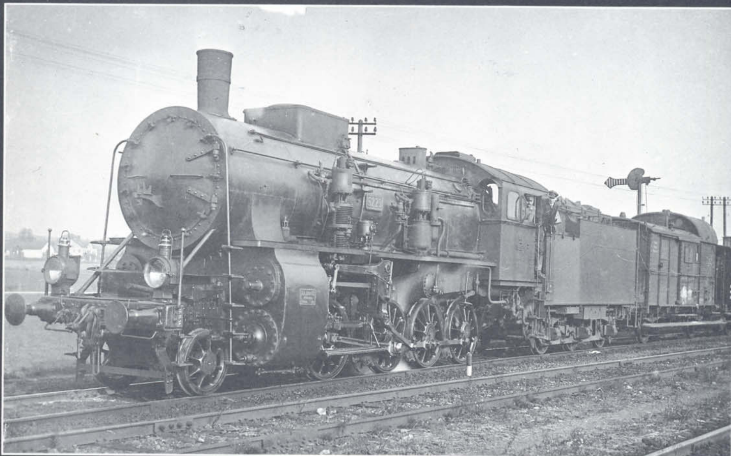
Bild 7: An der Pufferbohle der G 4/5 H mit der Bahnnummer 5229 steht seitlich das Datum 18.10.24 zu lesen. Die Lokomotive wurde 1919 von Maffei geliefert und 1925 in 56 1119 umgezeichnet.
