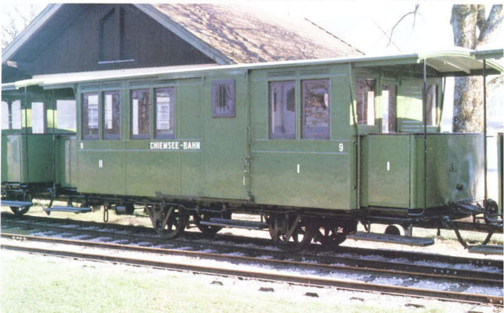
Bild 13: Der kombinierte Personen-Gepäckwagen (ABPwi) der Chiemseebahn, Baujahr 1888.
