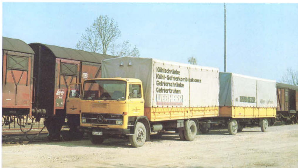
Bild 7: Hier werden im Mai 1982 in Ochsenhausen Kühl- und Gefrierschränke der Firma Liebherr vom LKW in zweiachsige, gedeckte Güterwagen der DB umgeladen. Die normalspurigen Güterwagen laufen auf der Schmalspurstrecke Warthausen – Ochsenhausen auf Rollböcken mit einer Spurweite von 750 mm. Foto: A. Ritz
