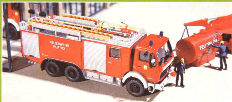
Bild 23: Das neue Tanklöschfahrzeug TLF 48/50-5 und, im Hintergrund, einer der neuen Flüssigkeitsbehälter für den "Meiller" Absetzkipper.
