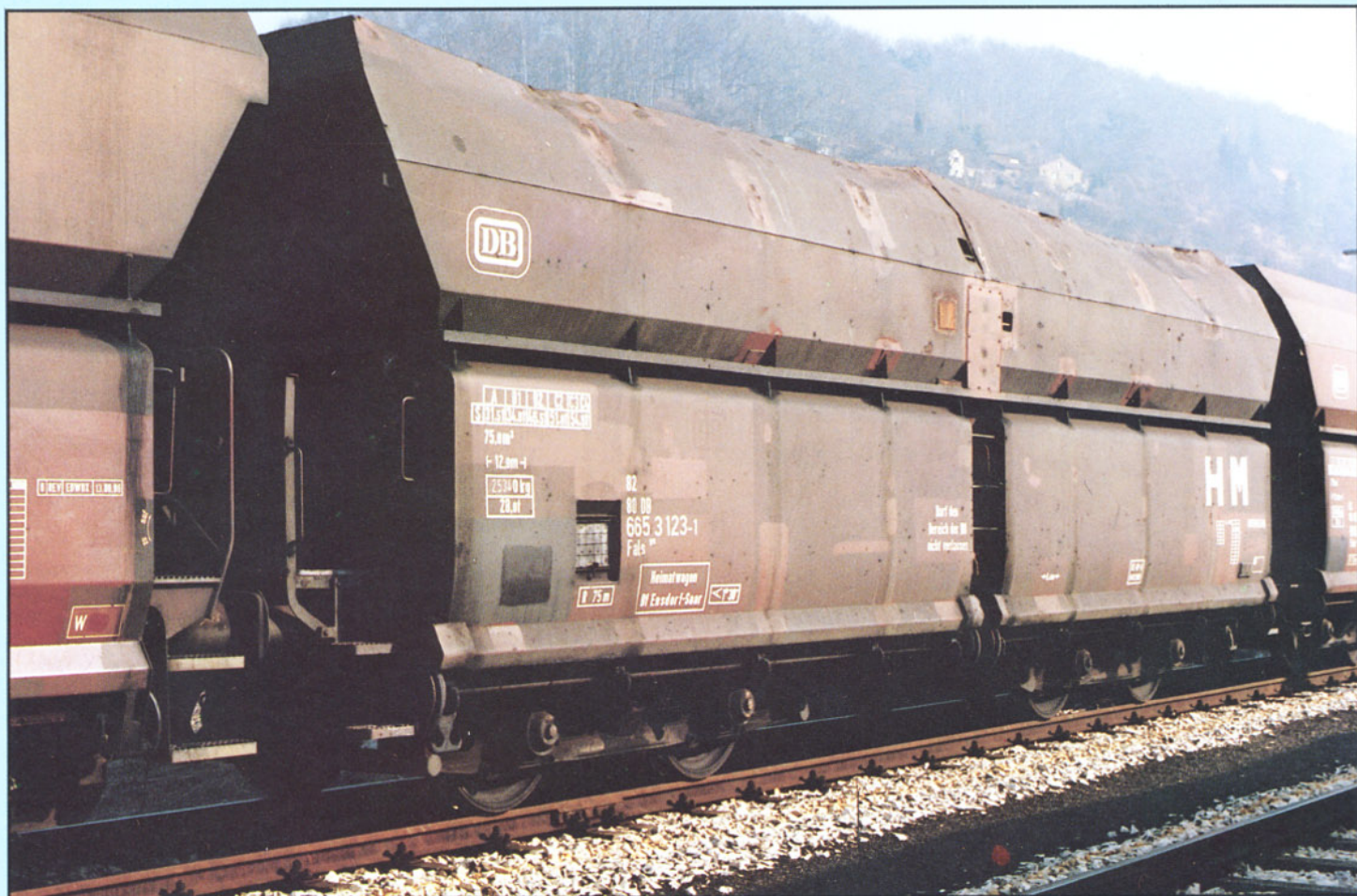
Bild 4: Großraum-Selbstentladewagen der älteren Bauart Fals 178. (Das Anschriftenfeld dieses Wagens ist auf Bild 2 zu sehen).
