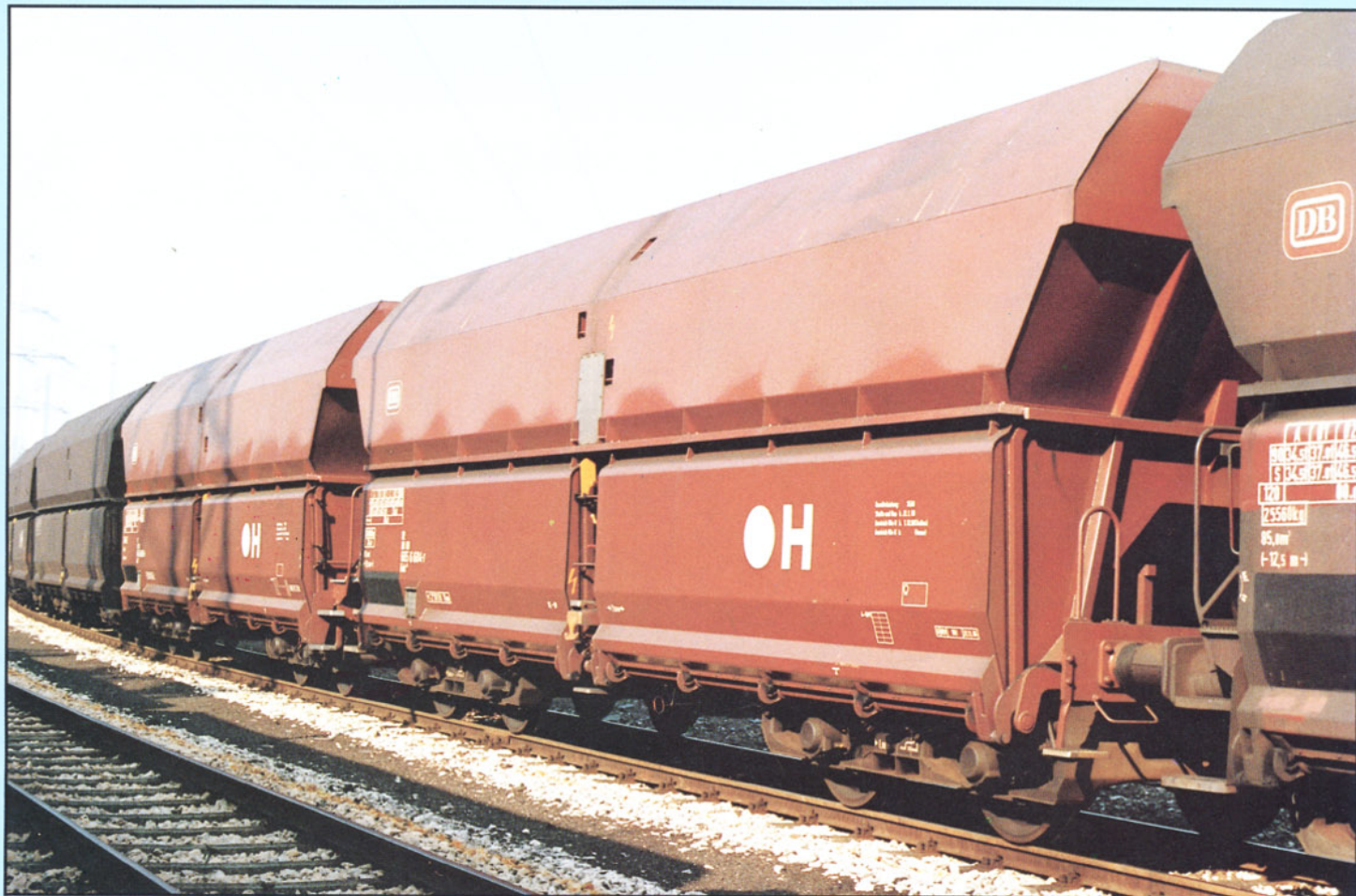
Bild 7: In zunehmendem Maße erscheinen in den Ganzzügen zu den Großkraftwerken die neuen Grobraum-Selbstentladewagen der Bauart Fals 183.
