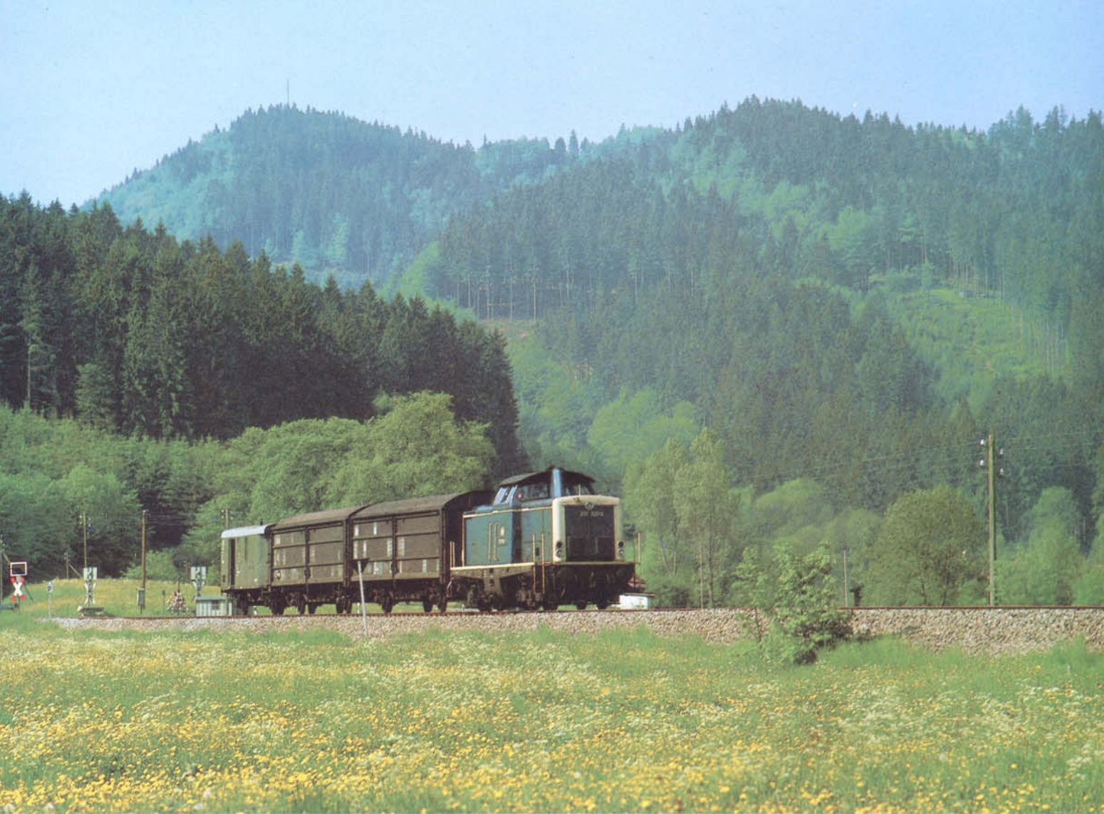
Bild 4: Der Übergabezug von Kempten nach Isny bestand am 01.06.1982 bei Klausenmühle aus der Diesellokomotive 212 100, zwei gedeckten Güterwagen mit Schiebewänden und einem Güterzuggepäckwagen.
