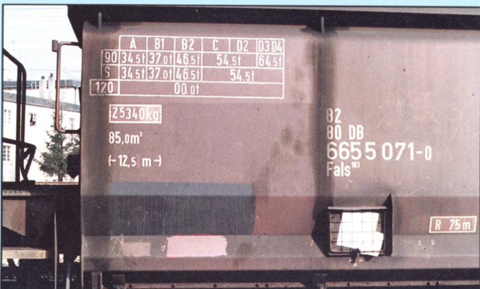
Bild 2 (Mitte): Wie dem Anschriftenfeld zu entnehmen ist, haben die Fals 178 nur einen Laderaum von 75 cbm, obwohl ihr Eigengewicht dem der Fals 183 fast gleichkommt. (Eine Typenaufnahme des Selbstentladewagens zeigt Bild 4).
