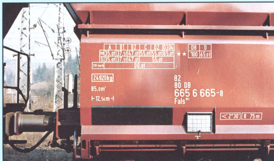
Bild 4: Großraum-Selbstentladewagen der älteren Bauart Fals 178. (Das Anschriftenfeld dieses Wagens ist auf Bild 2 zu sehen).
