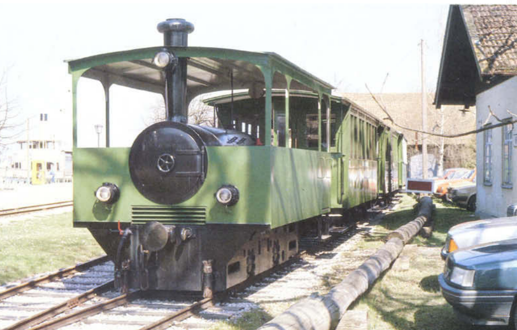
Bild 11: Die KHD-Diesellokomotive der Chiemseebahn wurde äußerlich ganz der Dampflok angeglichen. Sie stellt keinen Ersatz, sondern nur Ergänzung für sie dar. Foto: Dr. Hufnagel
