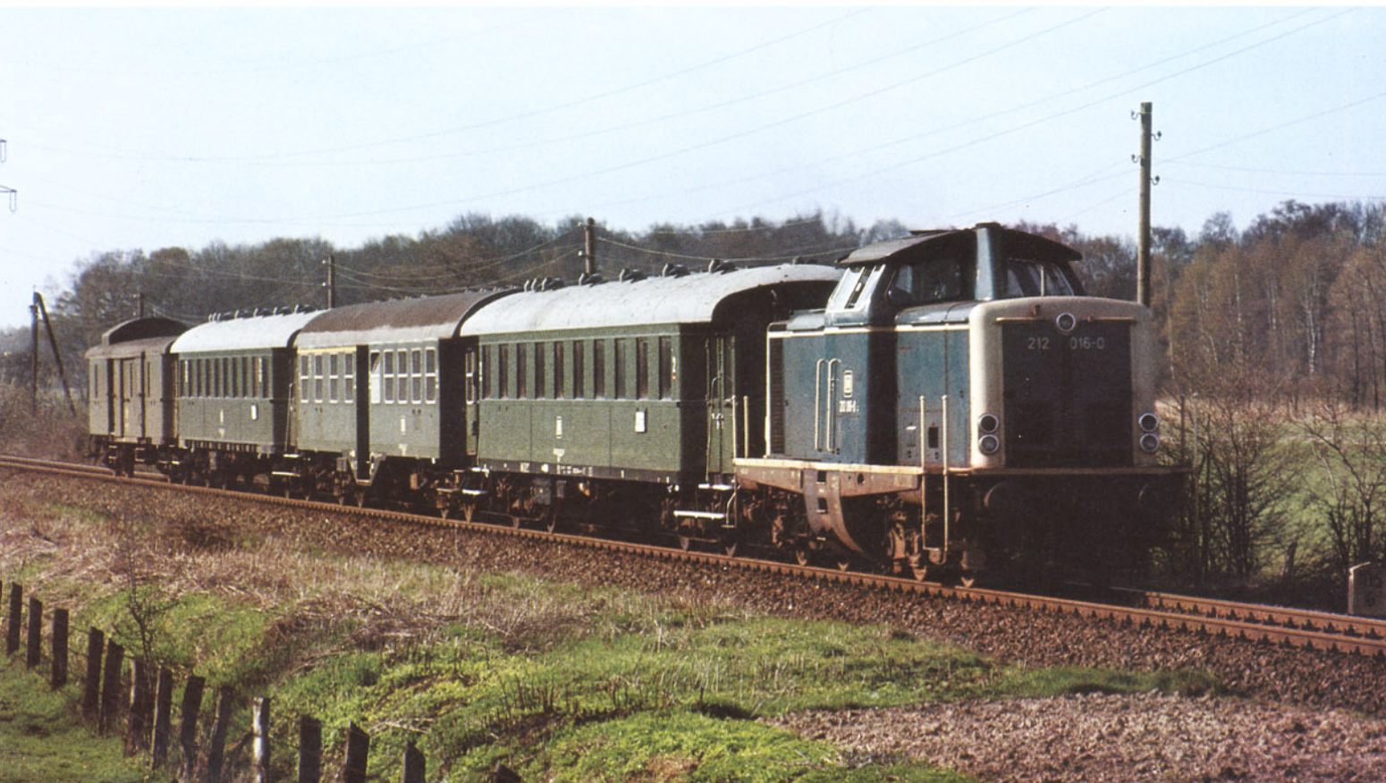
Bild 4: Mit einem Nahverkehrszug von Delmenhorst nach Osnabrück wurde die 212 016 am 19.04.1982 bei Osnabrück-Eversburg im Bild festgehalten. Der Zug besteht aus drei Personenwagen, darunter ein vierachsiger Umbauwagen, sowie einem Gepäckwagen. Foto: R. Köstner
