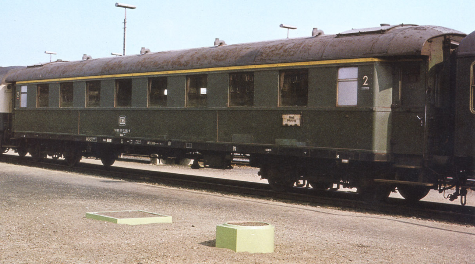
Bild 5: Wegen Mangel an Personenwagen der 2. Wagenklasse in der BD Hamburg und der BD Hannover wurden kurz vor ihrer Ausmusterung mehrere 1. Klasse-Wagen der Bauart Ayse 604 zu Wagen der 2. Klasse herabgestuft, ohne daß sie vorher einem Innenumbau unterzogen wurden – nur die Klassenbezeichnung neben den Einstiegen wurde von 1 auf 2 geändert. Zu diesen Fahrzeugen zählt auch der Ayse 604 mit der Wagennummer 50 80 18-11 284-9, der am 25.04.1981 im Bww Lübeck aufgenommen wurde. Foto: M. Rex, Sammlung Bächle
