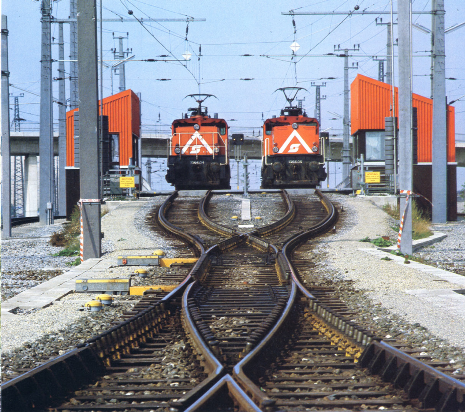
Bild 5: Die beiden sechsachsigen Lokomotiven der ÖBB-Reihe 1064 haben ihre Güterzüge abgedrückt. Während des Abdruckvorgangs erteilt die Funk-Fernsteuerung aus dem Zentralcomputer die erforderlichen Befehle. Der Lokführer übt bei diesem Vorgang lediglich Kontrollfunktionen aus.
