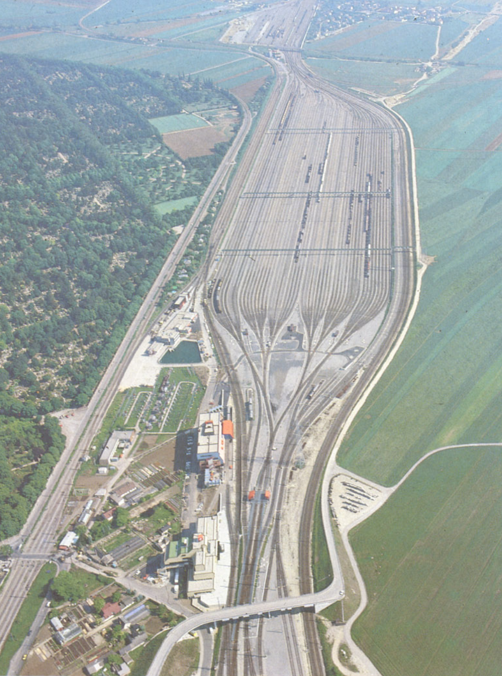
Bild 3: Dieses Luftbild vermittelt einen guten Überblick über die Größe des Zentralverschiebebahnhofs. Am unteren Bildrand das Ende der Einfahrgruppe, links von der Einschnürung (Rollberg) das Betriebsgebäude 1, anschließend die Reihungsgruppe und am oberen Bildrand die Ausfahrgruppe. Die zweigleisige Hauptstrecke von Wien Süd nach Budapest bildet den rechtsseitigen Abschluß der Anlage (Luftaufnahme freigegeben vom BM f. LV mit Zahl 13088/136-1.6/86).
