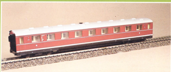
Bild 5: Mittelwagen des VM 06 104 mit den neuentwickelten Wagenübergängen.
