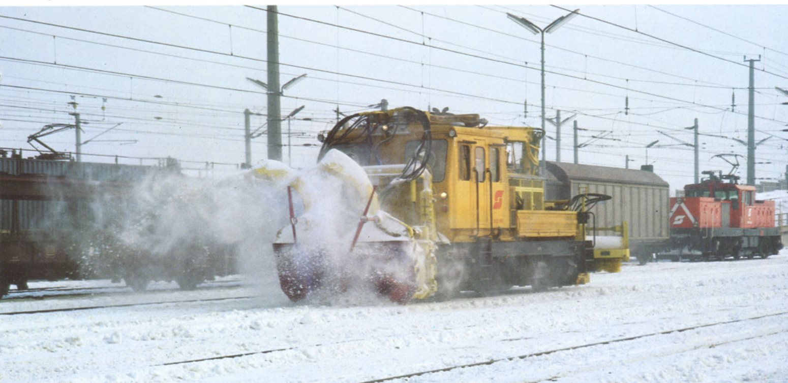
Bild 2: Kein einwandfreier Betrieb ohne Wartung. Im Winterdienst der Einführungssaison 1985/86 haben sich die Bahnmeisterfahrzeuge der Reihe X628, mit Schneeräumgeräten bestückt, sehr gut bewährt.
