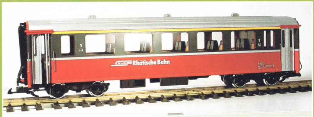
Bild 14: Der sehr fein detaillierte Wagen 1. Klasse der Rhätischen Bahn von LGB.
