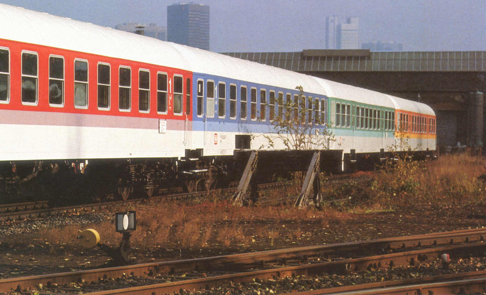
Bild 1: Die Reisezugwagen der DB erhalten eine neue Farbgebung. Die Wagenkasten werden in Zukunft lichtgrau gespritzt, die Fensterbänder je nach Produktgruppe rot (Inter-city), blau (Fernverkehr), türkis (Nahverkehr) oder orange (S-Bahn). Hier alle vier Farbvarianten auf einen Blick.
