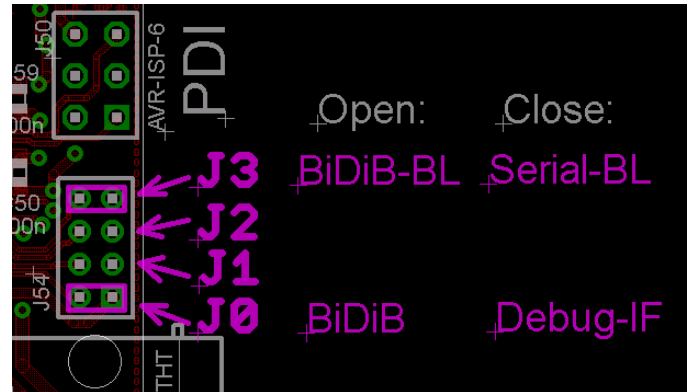
Рис. 38: GBMboost Джамперы Bootloader
