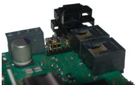
Рис. 19: GBMboost v1.8 Радиатор охлаждения
