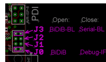
Рис. 50: GBM Джамперы Bootloader-a
