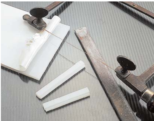
Die drei Leuchtkästen auf dem Dach werden aus milchig trübem 4-mm-Plexiglas gesägt. Sie finden in Schlitzten entlang des Dachs ihren Platz.
