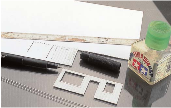
Die Wände entstehen aus Polystyrolplatten. Tür- und Fensteröffnungen sind bereits ausgeschnitten, ihre Rahmen und die Leisten aufgeklebt.
