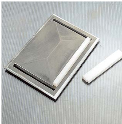
Die drei Leuchtkästen auf dem Dach werden aus milchig trübem 4-mm-Plexiglas gesägt. Sie finden in Schlitzten entlang des Dachs ihren Platz.
