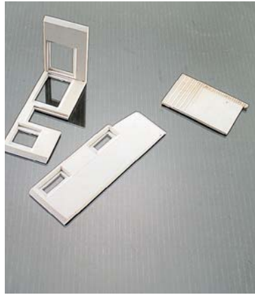
2 mm starke hinterklebte Polystyrolplatten stabilisieren die Wände. Die Einfassung der Toilettenfenster entsteht aus 0,75 x 0,5-mm-Profilen.
