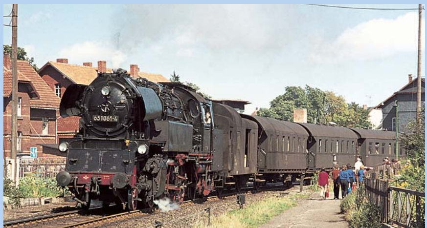
Die Naubaudampflok 65 1061 der DR im Jahr 1974 in Ilmenau mit Packwagen, zwei vormaligen Ci und einem früheren Bi 29. Dieser Wagen hat bei einem Umbau Fenster erhalten, bei denen nur der obere Teil aufgeklappt werden kann. FOTO: BERND V. MITZLAFF
