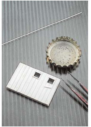
2 mm starke hinterklebte Polystyrolplatten stabilisieren die Wände. Die Einfassung der Toilettenfenster entsteht aus 0,75 x 0,5-mm-Profilen.
