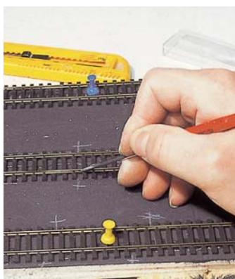
Kabel an vernickeltem Schienenprofil festzulöten ist nicht ganz einfach – so geht es: Mit einem spitzen Gerät die Profile seitlich ankratzen ... Lötfett drauf- tupfen ... Schiene (und Kabelende) verzinnen ... anlöten. Nun muss das Kabel nur noch durch eine Bohrung im Untergrund verschwinden.
