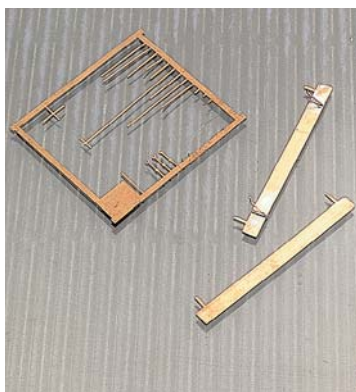
Zwei Ablagebretter entstehen aus Messingblech und Ätzteilresten.
