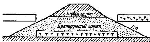
Фиг. 44. Отсыпка насыпи с опусканием её вместе с торфяным ковром на дно болота
