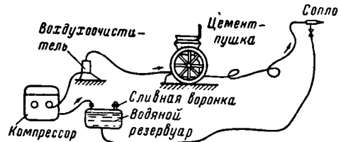
Фиг. 57. Схема установки цемент-пушки
