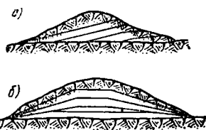
Фиг. 27—28. Схематические профили расположения забоев в продольном направлении: а — продольные, параллельные забои при односторонней вывозке; б — продольные забои с постепенным смягчением уклона при двусторонней вывозке
