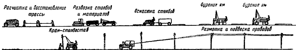
Фиг. 98. Работа механизированной колонны по устройству столбовой линии
