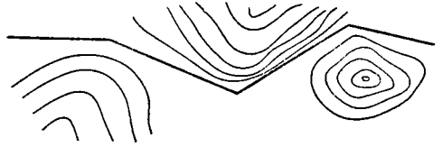
Фиг. 15. Схема обхода трассой препятствий
