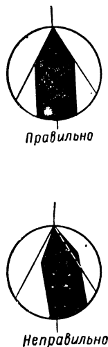
Рис. 163. Правильная и неправильная установка резца по профилю резьбы.
