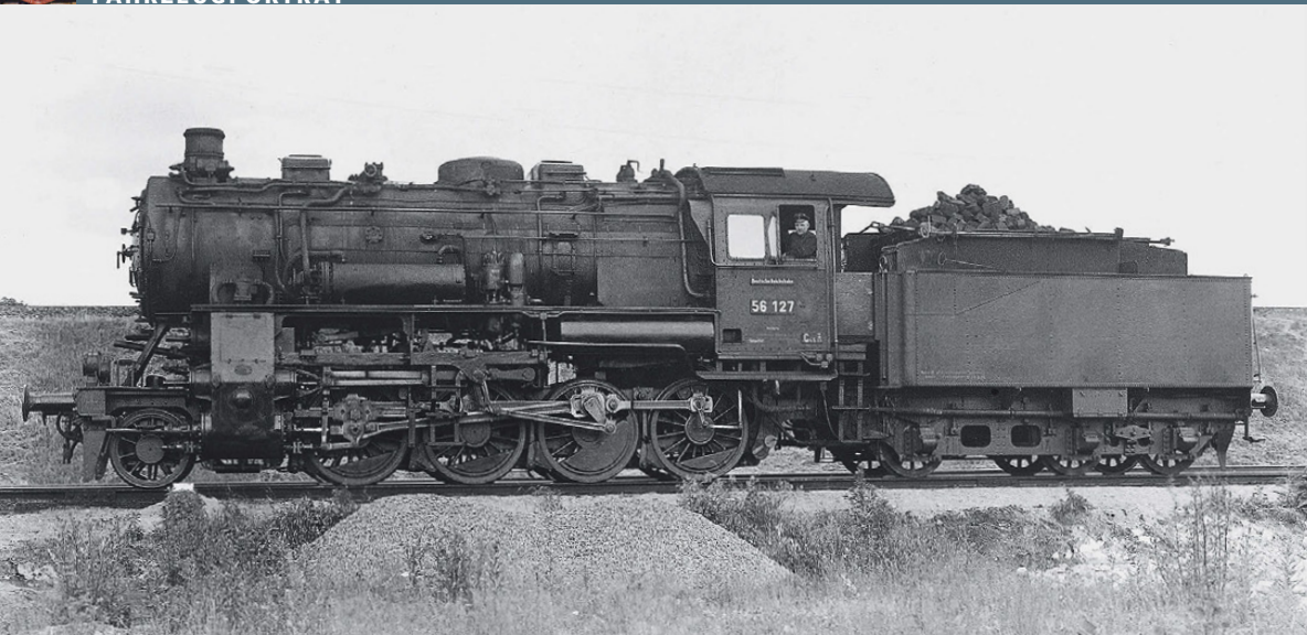
56 127 im Bahnbetriebswerk Tempelhof in den 1930er-Jahren: Das versetzte Gegengewicht am Treibradsatz zeigt, dass auch das Innentriebwerk auf den dritten Radsatz wirkt
