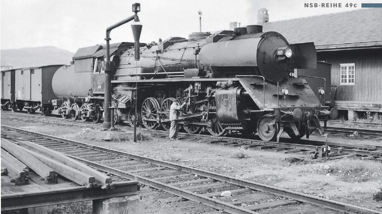
Die Lok 470 vor einem Güterzug in Oppdal – beeindruckend die schräg montierten Zylinder Slg. NMJ-GF-0367
