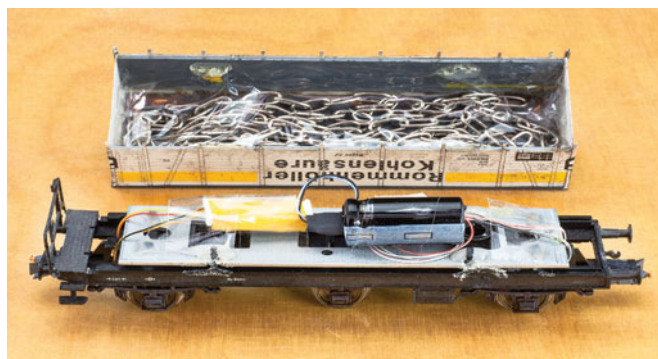
Einbaubeispiel bei einem Güterwagen. Hier waren im Boden des Wagens so viele Lücken, dass nicht gebohrt werden musste. Gut zu erkennen ist der relativ kleine Wagendecoder mit dem angeschlossenen Kondensator als Energiespeicher. Da dieser Wagen auch einzeln rangiert wird, ist seine Masse und somit seine Tragheit durch eine Metallkette im Wagendach erhöht worden.
