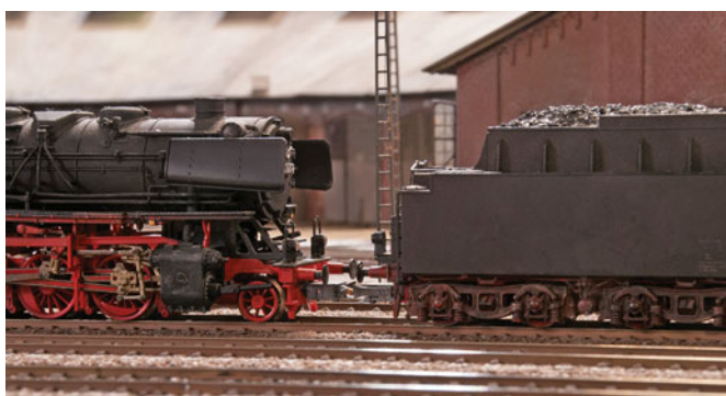
Die Zuglok muss natürlich vorn mit einer T4T-Kupplung ausgerüstet sein.
