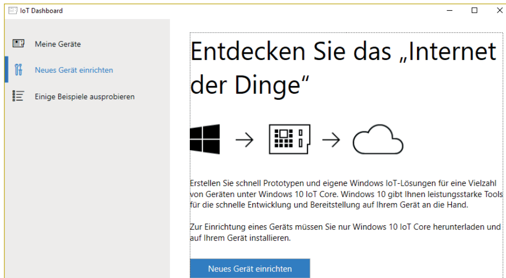
Abb. 2 und 3: Die Installation von Windows 10 IoT mittels Dashboard
