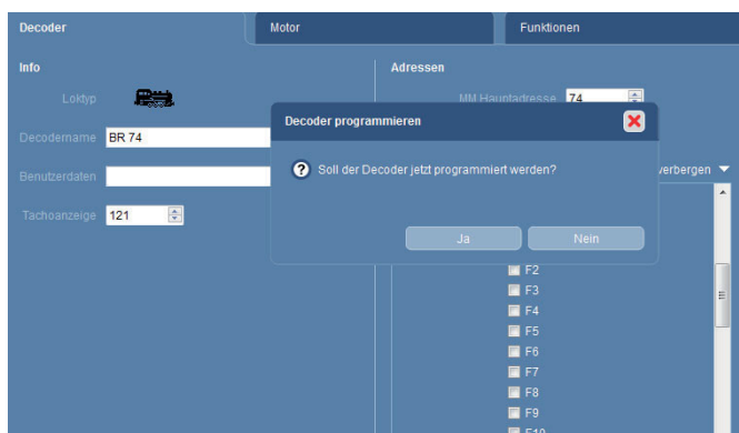
Ist alles eingestellt, können die Parameter an den Decoder übertragen werden.
