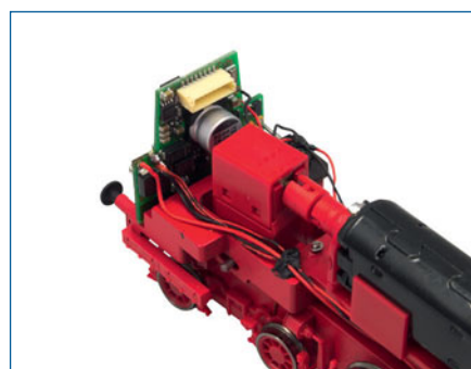
Die zwei Kabel von den Radkontakten kommen an den einen, das eine vom Mittelschleifer an den anderen Pol der Lokplatine.
