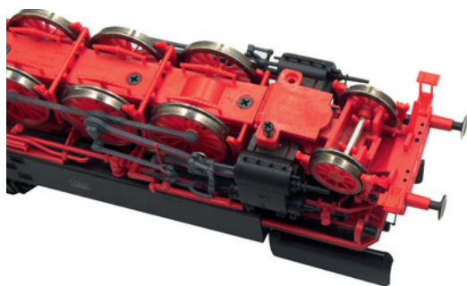
Zum Öffnen der Lok entfernt man zuerst die Abdeckung über der Vorläuferdeichsel.
