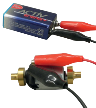
Mit einer 9-V-Batterie lässt sich der Motor testen.
