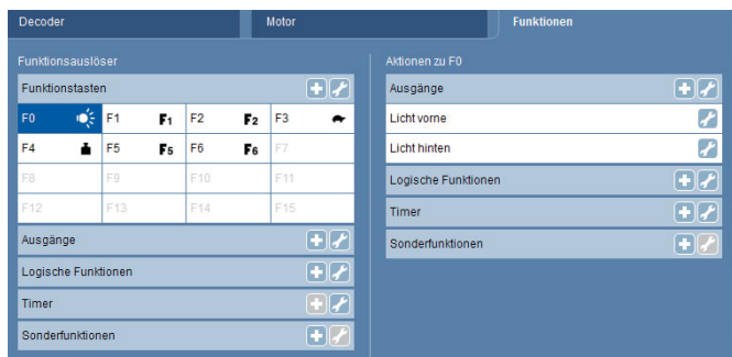
Hier wird die Zuordnung zwischen Funktionsnummer, Symbol und Ausgang bzw. technischem Verhalten festgelegt.
