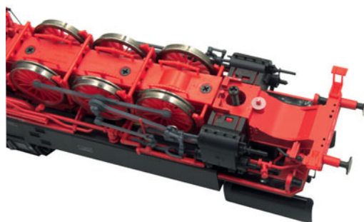
Hat man den Vorläufer entfernt, erreicht man die zentrale Gehäuseschraube.
