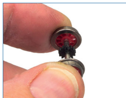
Ein geplatztes Zahnrad kann das ganze Getriebe blockieren!
