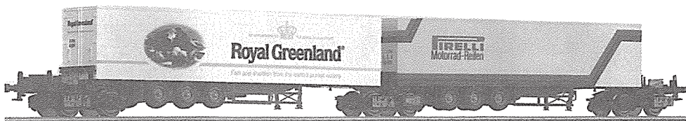
Speciální podvozky pro převoz návěsů kamionů po železniční trati
