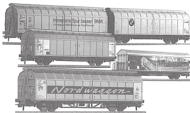
Velkoobjemové kryté vagóny pro dálkovou přepravu lehkého zboží na pevných nápravách
