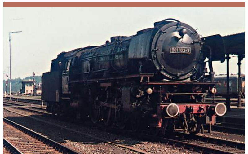
An einem Spätherbstabend des Jahres 1972 hatte die 001 103-1 einen Zug aus Regensburg nach Hof gebracht. Ihre Erkennungsmerkmale waren damals das weiß umrandete Nummernschild, die besonders abenteuerlich vor dem Schornstein über dem Kesselscheitel verlegte Rohrleitung und die beiderseits ihrer Handlauf-Stangen beraubten Windleitbleche.
