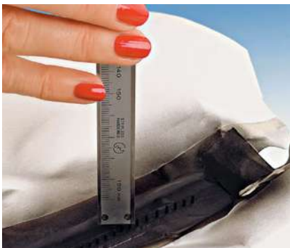
Entsprechend tief drückt dann das Ende des Messwerkzeugs die Pfosten in die Hartschaumlehre.
