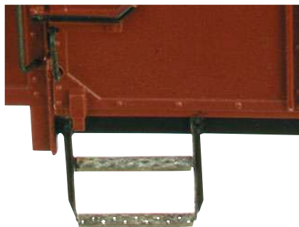
Auch die Aufstiegstritte unterhalb der Türen sind mit durchbrochenen Gitterrosten ausgerüstet, für die am Modell wiederum Ätzteile von Udo Böhnlein sorgen.
