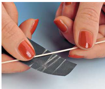
Um Holzdraht von abstehenden Fasern zu befreien, wird er erst einmal durch Schleifpapier gezogen.
