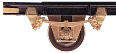
Komplettes Laufwerk mit Federböcken, Federn, Schaken, Verstärkungskappen und Diagonal-Abstützung.
