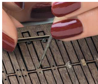
Auf den Schwellen 36 und 43 liegen die Rp 16-Kleisen einander so eng gegenüber, dass sie teilweise ausgeklinkt werden müssen. Zudem empfiehlt es sich, die zugehörigen Aufnahmelöcher mit einer Rundfeile zum Langloch zu erweitern.
