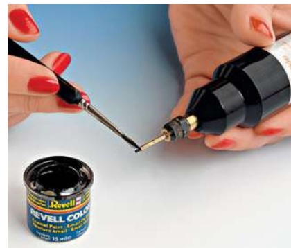
Mit dem Pinsel geht es auch: Das Abdecken übernimmt jetzt ein Stück Messingrohr, während das Einfärben mit Schwarz und Weiß bei langsam drehender Bohrmaschine erfolgt.
