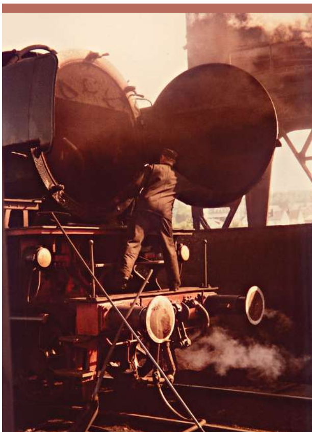
Die 001 103-1 beim Lösche ziehen im Bw Hof: Das im Spätherbst 1972 aufgenommene Foto lässt den komplett innerhalb der Rauchkammer untergebrachten Mischvorwärmer erkennen. Im Gegensatz zur 001 180-9 sind bei der 001 103-1 die unteren Reflexglas-Lampen des Spitzenlichts schwarz lackiert.
