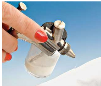
Dann folgt – ganz rechts – der Warnanstrich in Weiß. Generell kommt es darauf an, dass die Hartschaummaske richtig eng um die Pfosten anliegt – sonst sorgen später Farbnebel für unscharfe Kanten.
