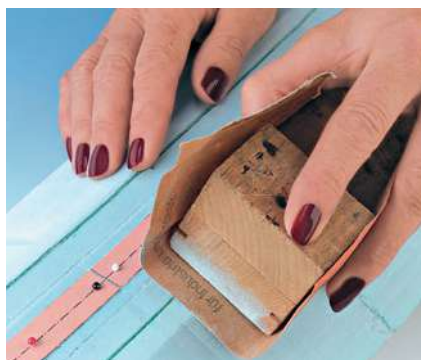
Sorgt für Ausrundung am Randweg: der Schleifklotz
