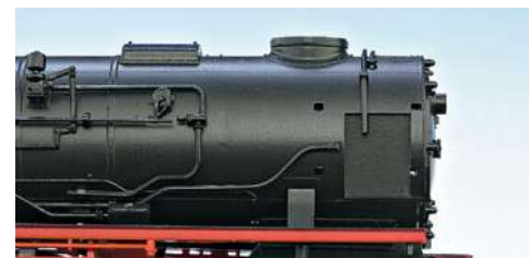
Nach Abnehmen der Windleitbleche zeigt sich die Nische in der Rauchkammer auf der Lokführerseite der Roco-01 mit Neubaukessel.
