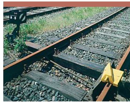
Aufgelegt und abgesperrt: die Gleissperre VI im Bahnhof Weidenberg. Der Schlüssel zu ihrem Schloss (roter Pfeil, unten) steckt im gekuppelten Riegel-Hands Schloss an der Weiche Nummer 6 (Kasten oben).
