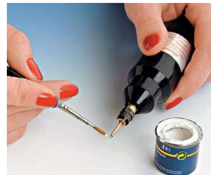
Mit dem Pinsel geht es auch: Das Abdecken übernimmt jetzt ein Stück Messingrohr, während das Einfärben mit Schwarz und Weiß bei langsam drehender Bohrmaschine erfolgt.
