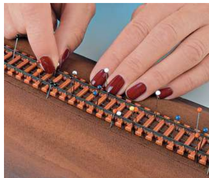
Zum Befestigen der Gleisjoche empfiehlt sich langsam abbinder Zweikomponenten-Kleber; so bleibt genügend Zeit zum Ausrichten. Bis zum Abbinden fixieren Stecknadeln die Gleise in der endgültigen Lage.
