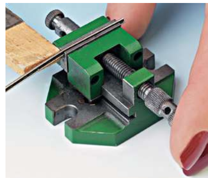
Das Abwinkeln der Flügelschienen an den eingesägten Stellen (rote Pfeile in der Skizze) erfolgt nach der bewährten Formel Augenmaß x \pi .
