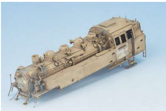
Während des Umbaus gilt es, viele Teile an- oder abzulöten. Dazu ist – wegen des starken Messingblechs – ein Lötkolben mit 60 Watt Leistung nötig.
