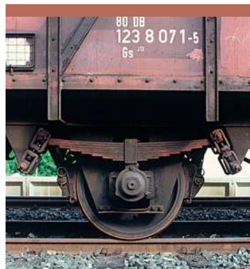
So soll's aussehen: Laufwerksdetail eines Gmms 60 (Gs213) im Bahnhof Lauf/rechts der Pegnitz. Foto: Willy Kosak, Sommer 1990
