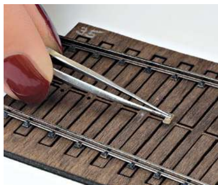
Nach dem Einstecken und Festkleben der Herzstück-Unterlegplatte ...
