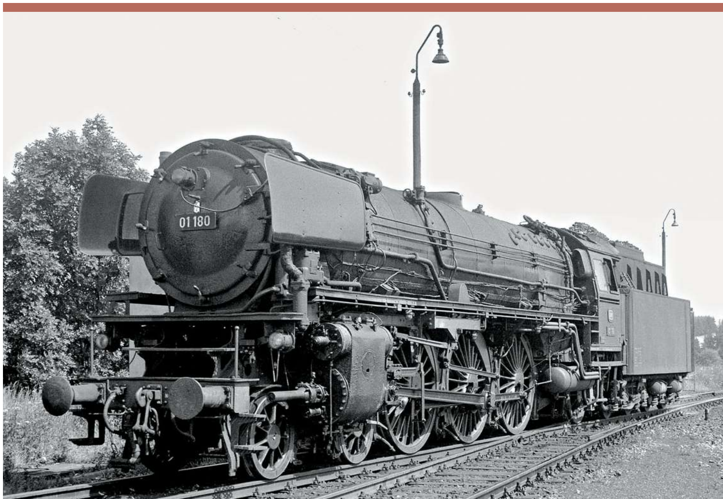
Als Ulrich Budde die 01 180 am 29. Juli 1968 im Bw Hof aufnahm, war sie mit einem T 34-Tender gekuppelt, der nicht nur über einen Kohlenkasten-Aufsatz mit drei durchbrochenen Stützen auf der Heizerseite verfügte, sondern zudem, ebenfalls auf der linken Seite, unterhalb des Wasserkastens zwei Luftbehälter aufwies, die eigentlich nur an 03 10 -Tendern zu finden waren.
