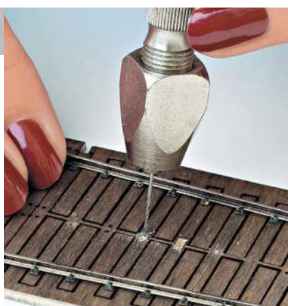
... stehen auf der benachbarten Schwelle 3384 zwei weitere 0,7-mm-Bohrungen an, die später halbierte Rp 16 aufnehmen.
