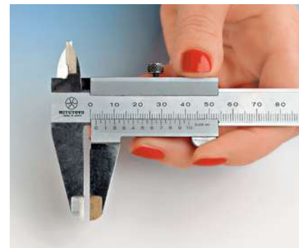
Nach dem Lackieren mit Schwarz wird die Schieblehre auf 2,4 mm eingestellt.
