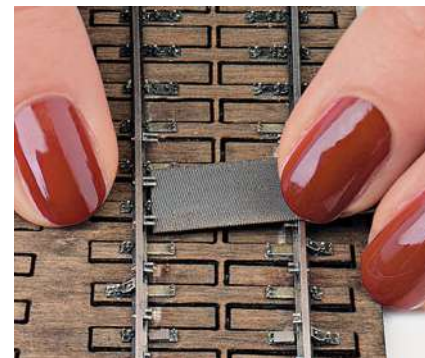
Nach dem Einbau sollten die Enden aller Stützknaggen möglichst auf einer Höhe liegen.
