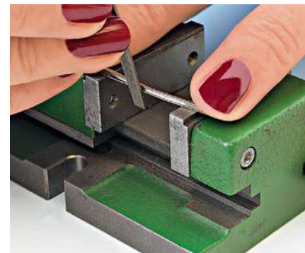
Im Bereich des Herzstücks wird der innere Flügelschienen-Fuß – nur für H0pur® – weggefeilt, ohne dabei den Schienenkopf mit der Feile zu berühren.
