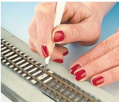
Passend zugeschnittene North-Eastern-Streifen (1 x 10) werden auf die Pertinaxschwellen geklebt. Sie tarnen den Trennschnitt in Schwellenmitte.
