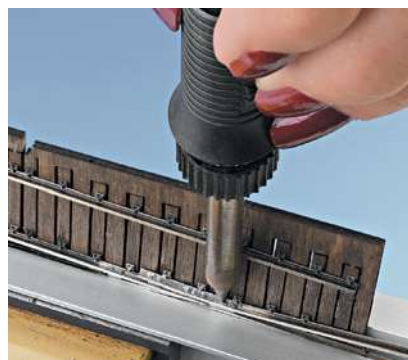
Einlöten der Schienenlaschen mit geätzten Vierkantköpfen.
