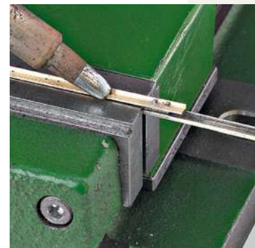
In die Bohrungen lassen sich dann die Weichenschrauben – 13 Stück pro Radlenker – einlöten.
