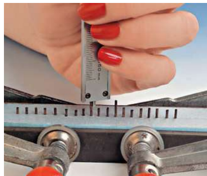
Jetzt werden die Pfosten mit der Schieblehre eingeschoben, bis sie exakt 3,7 mm weit überstehen.
