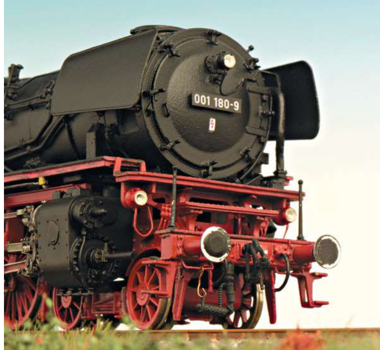
Von schräg unten aufgenommen, ist die Nische in der Rauchkammer auf der Lokführer-Seite oberhalb des Umlaufs vor dem Zylinder-Einströmröhr recht gut zu erkennen. Dieses Detail musste beim Weinert-Umbausatz 4001 nachträglich in das Kesselblech per Laubsäge eingearbeitet werden.
