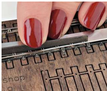
Nach dem Verlöten mit Backenschiene und Schrauben werden die Stützknaggen mit Hilfe einer Feile auf die endgültige Länge gebracht. Ein untergelegtes Stück Blech verhindert dabei Schäden an den Holzschwellen.
