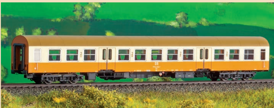
Brawa nahm sich eines Vorbilds der Deutschen Reichsbahn aus der Epoche IV an (46008): Der Halberstädter Mitteleinstiegswagen Bmhe verfügt über mehrfarbige Sitze und schöne Türen.
