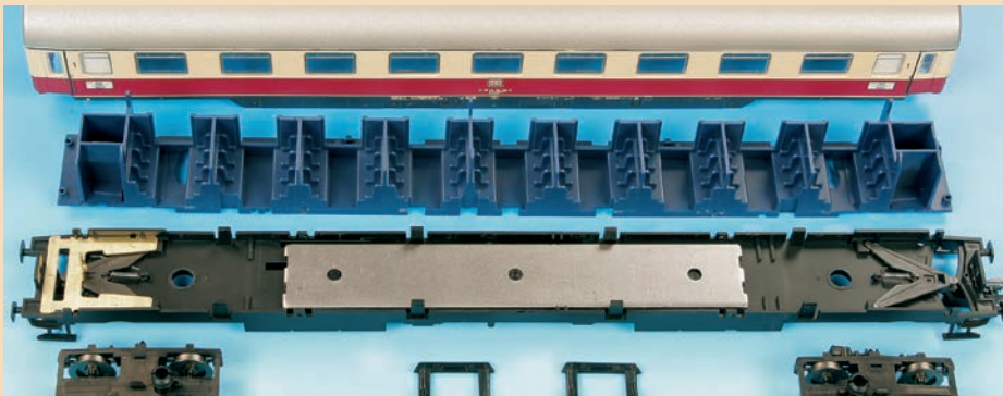
Um den Innenraum des Abteiwagens farblich neu gestalten zu können, müssen wir ihn zunächst zerlegen. Später werden auch der Wagenkasten und die Drehgestelle nachbehandelt.
