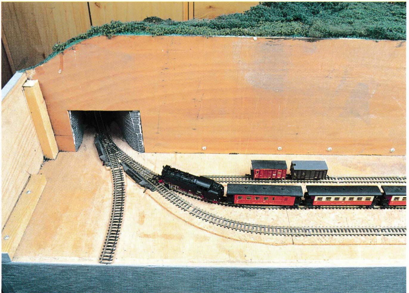
Der Schattenbahnhof mit der Anschlußmöglichkeit für weitere Segmente. Damit bei einer falschen Weichenstellung der Zug nicht etwa in den Abgrund rast, wurde die eine Schiene entfernt, so daß die Lok dann auf dem Schwellenbahn zum Stehen kommt.
