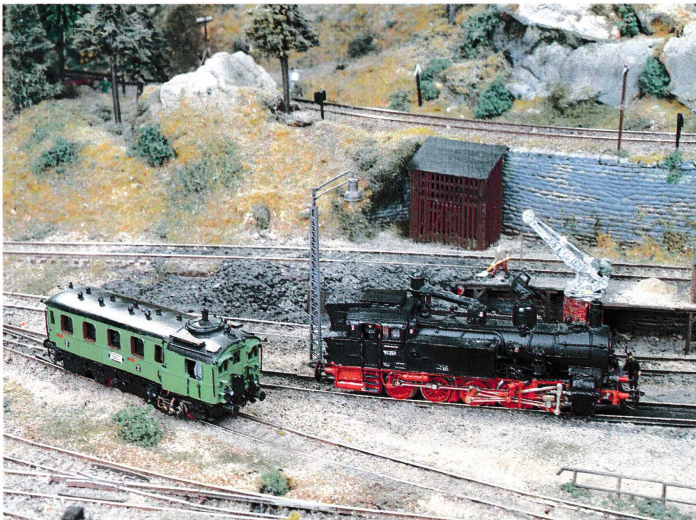
Eigen- und Umbaumodelle bestimmen den Fahrzeugpark auf der Anlage. Der Kittel-Dampftriebwagen entstand völlig in Eigenbau, wobei Messingätzteile und ein Antriebsatz mit Faulhaber-Motor verwendet wurden.
