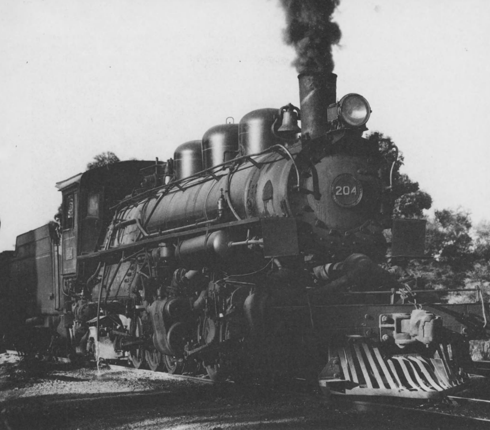
Einfachexpansion-Mallets sind charakterisiert durch 4 gleich grosse Zylinder wie hier an der Lok Nr. 204 der Donna
