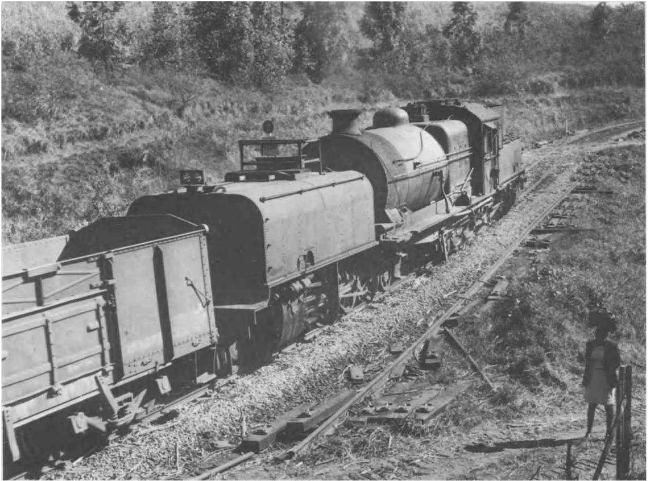
Eine Lok Klasse GE der 2. Serie mit abgerundeten Längskanten am vorderen Wassertank begegnet bei der Beförderung eines Leerzuges für Zuckerrohr einem Zulu-Mädchen, das seine Last auf traditionelle Art trägt. A. E. Durrant
