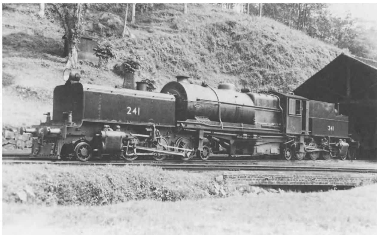
Die Prototyp-Garratt-Klasse C1 der Ceylon Government Railways, welche später als Klasse C1A nachgebaut wurde und noch die Umbenennung des Landes in Sri Lanka erlebte. W. H. C. Kelland
