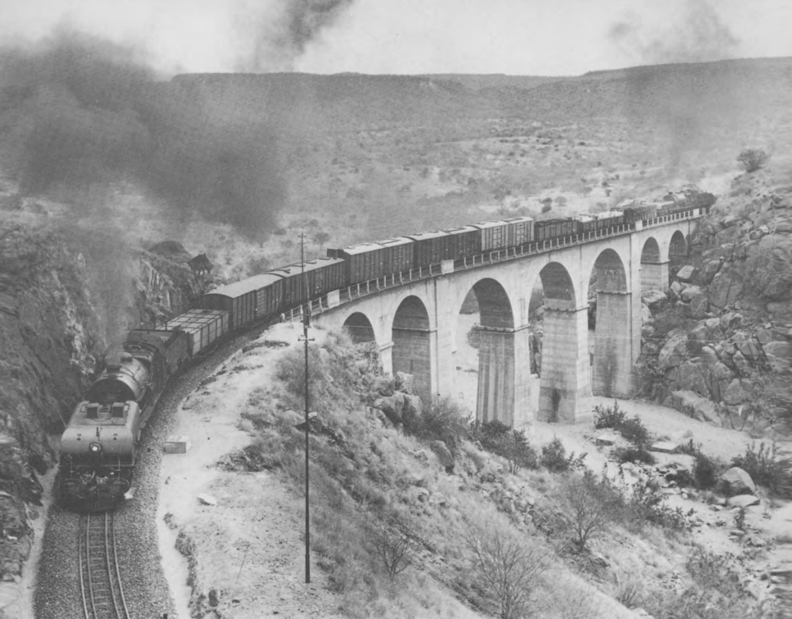
Ein «Dupla» in Aktion. Nach üblicher Praxis der CFB erhielten schwere Züge etwa in der Mitte eine Zwischenlokomotive. Das Bild zeigt zwei Garratts der 4. Serie.
