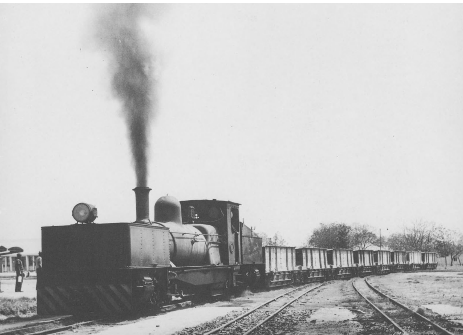
Unten: Die allerersten Garratts der SAR waren die Ursprungslieferung der Klasse NGG 11 noch mit Nassdampfkessel und Flachschiebern. Eine davon überlebte durch den Verkauf an die Rustenberg Platinum Mines, wo sie hier 1967 noch in Betrieb gezeigt ist. Gegenwärtig ist sie in wenig erfreulichem Zustand verwahrt. Wesentlich ist, dass diese Maschine als Vorläufer der grössten Garratt-Flotte der Welt renoviert und der Nachwelt erhalten wird.
