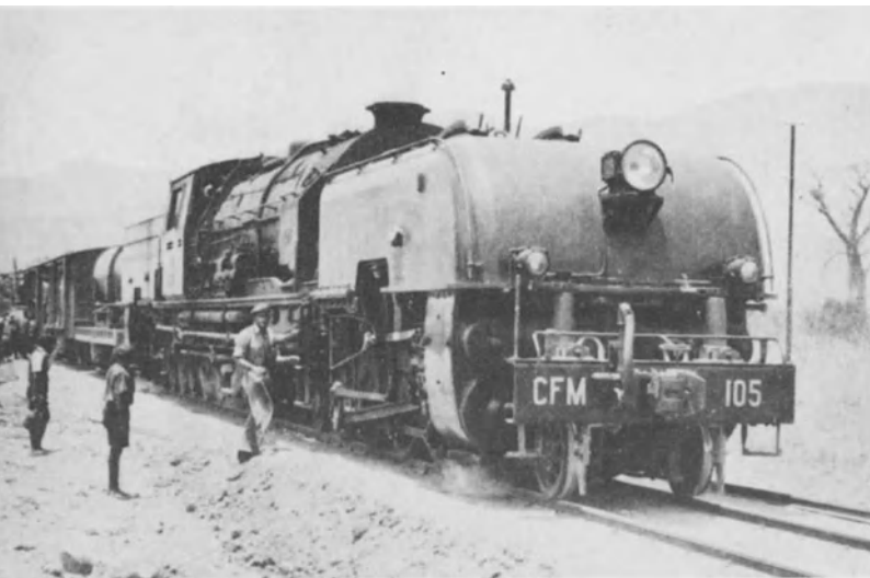
Lok 105 der Mocamedes-Bahn in Angola, eine von Henschel gebaute 2D1 1D2 mit Ölfuehrung. Sammlung des Autors
