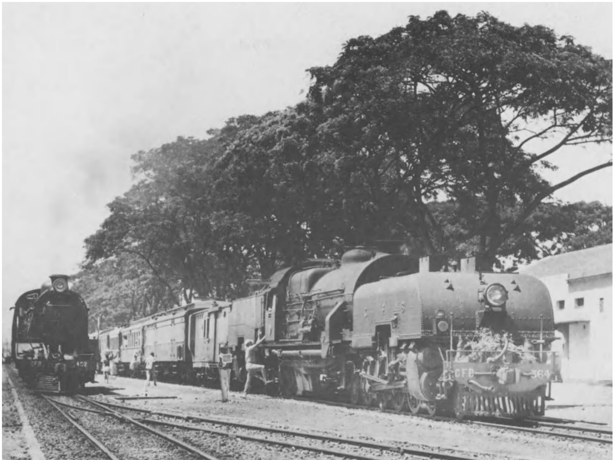
Lokwechsel in Benguela. Die ölgefeuerte Garratt Nr. 364 aus der 4. Serie beim Abspannen von einem Personenzug der Hauptlinie, den sie gerade vom Hochland herabgebracht
