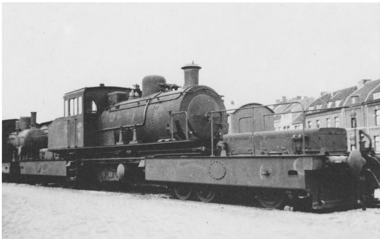
Eine ungewöhnliche Garratt. Innenzylinder und seitlich tief herabgezogene Wassertanks waren typische Merkmale
