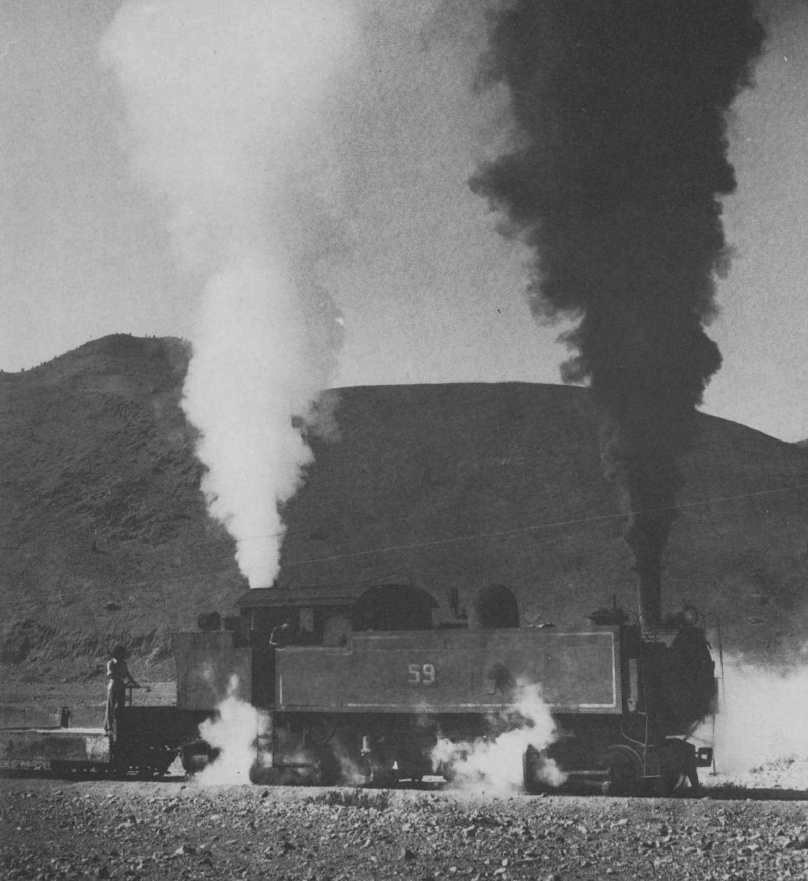
Die Kitson-Meyer als verbesserte Bauform der Original-Meyer-Type mit grösserem Abstand zwischen den Drehgestellen und ausreichend Raum dazwischen für Feuerbüchse und Aschkasten nahm dieses Merkmal der Garratt schon vorweg. Hier ist im Jahre 1977 die Lok Nr. 59 der Taltal-Bahn in Chile zu sehen. Diese CC-Tenderlok war das letzte Exemplar ihrer Gattung. Bemerkenswert ist der ungewöhnliche doppelte Auspuff. Das hintere Zylinderpaar bläst durch einen hinter dem Führerhaus befindlichen eigenen Schornstein aus.
