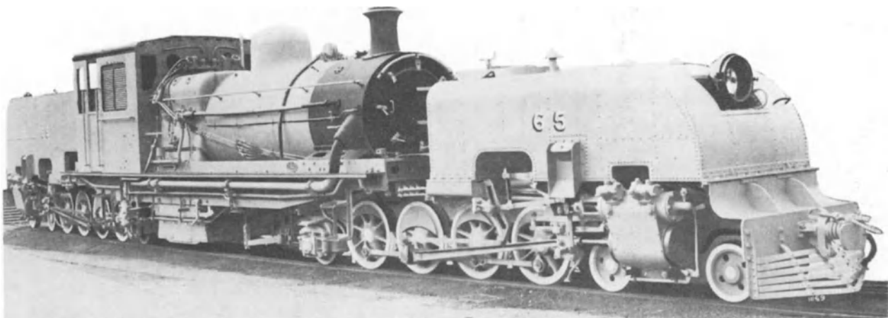
Die letzten Garratts für Sierra Leone – relativ grosse Maschinen auf kleiner Spur und dabei die kleinsten je gebauten Garratts mit 2 × 4 gekuppelten Achsen. Beyer Peacock
