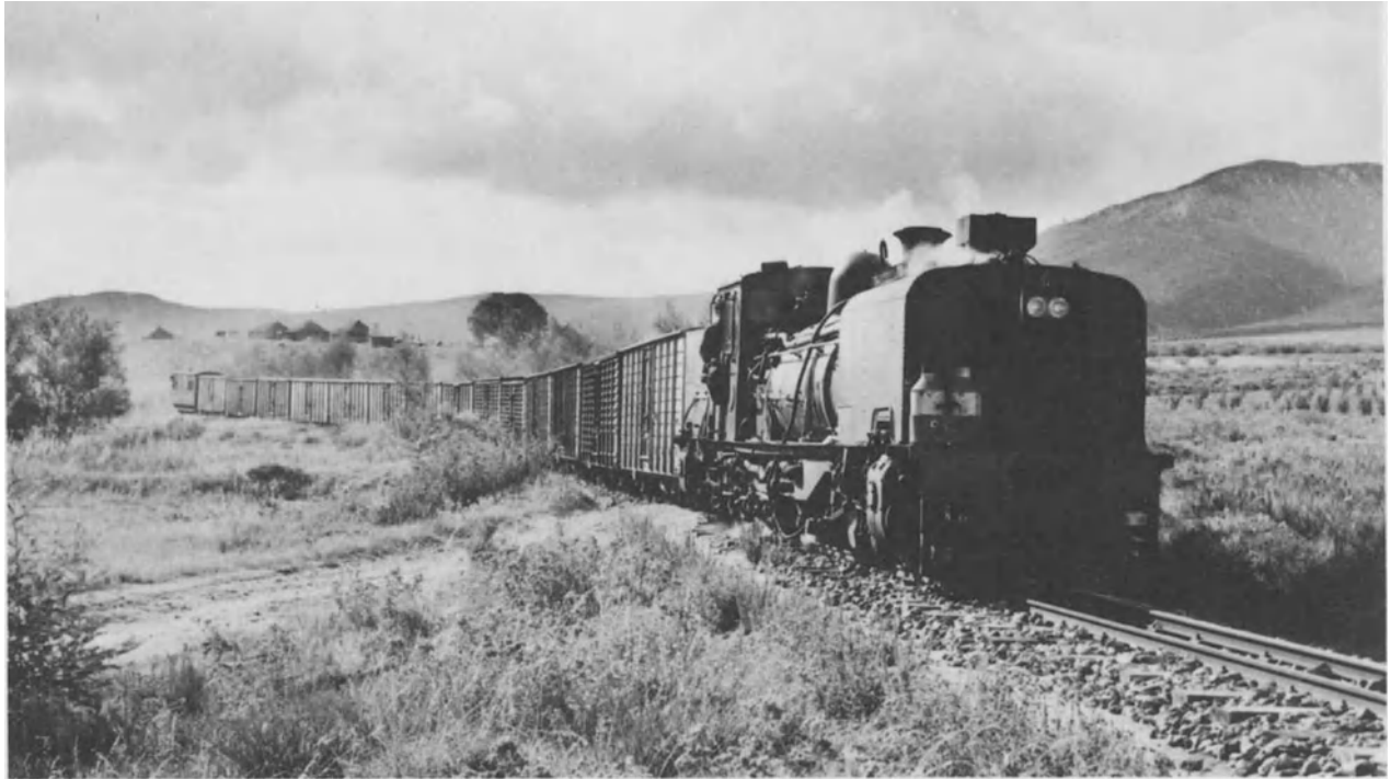
Oben: Die früheren Exemplare der Klasse NGG 16 sind an der runden Stehkesseldecke und an den seitlich oben abgerundeten vorderen Wassertanks genieteter Bauart erkennbar, ebenso wie auch die Klasse NGG 13 diese Merkmale aufweist. Auf dem Bild ist Lok NGG 109 auf der Fahrt mit einem Apfelzug im Jahre 1968 zu sehen. A. E. Durrant
