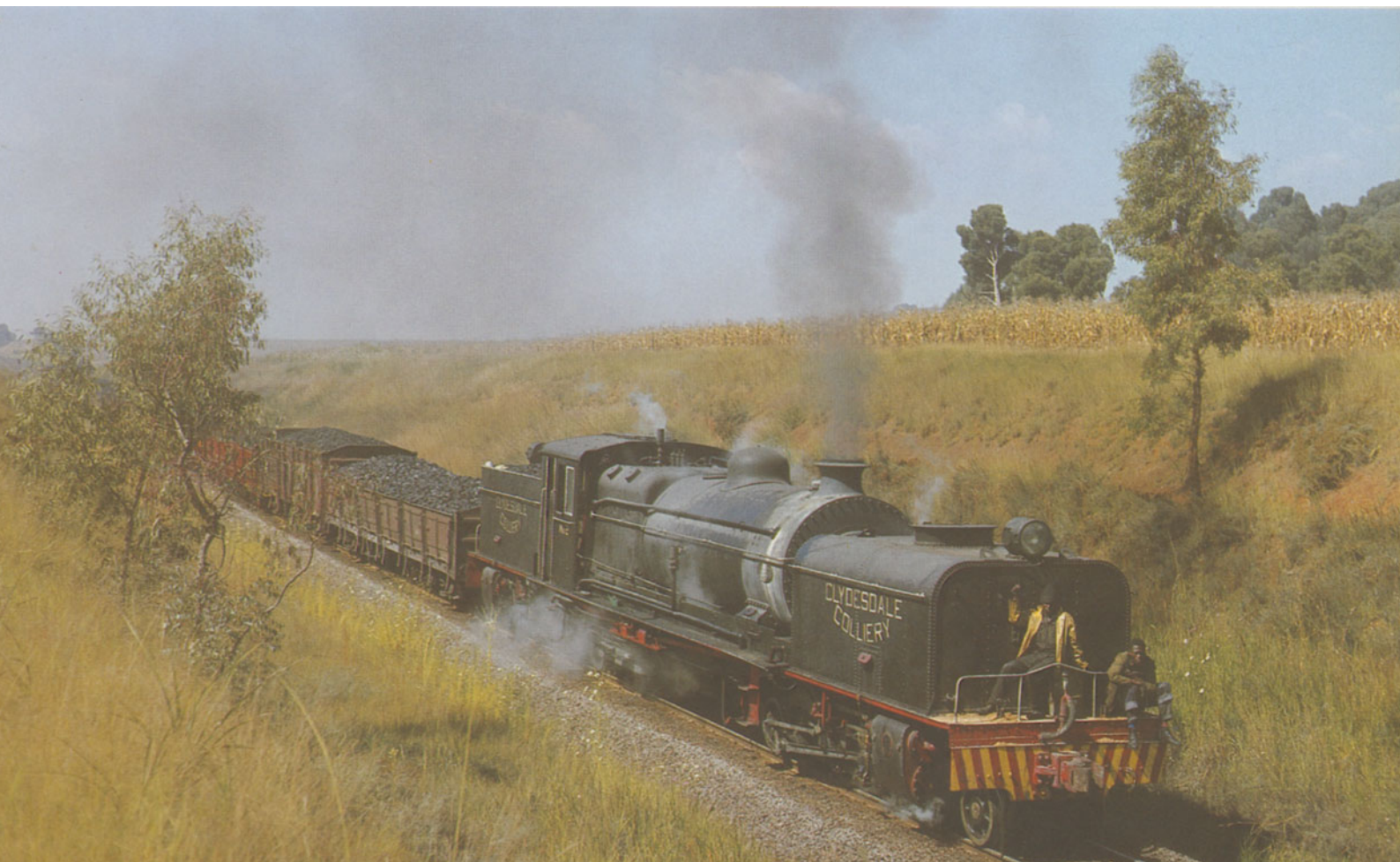
Unten: Die 1C1 1C1 Industriebahn-Garratt der Clydesdale Colliery schleppt hier kurz nach einer Überholung im Reparaturwerk einen Kohlenzug durch einen von Wildblumen und Maisfeldern eingesäumten Abschnitt auf dem Weg zum SAR-Anschlussbahnhof Bezuidenhoutsrust. Die beiden Afrikaner vorn auf der Lok erfüllen Doppelaufgaben als Rangierer und Sandstreuer.
