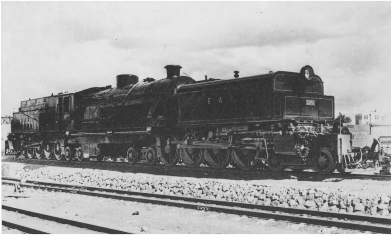
Rechts: Die ehemalige Klasse EC3 der KUR wurde bei den EAR zur Klasse 57. Durch die Ausrüstung mit grösserem Dom und Schornstein verlor sie von ihrem eindrucksvollen
