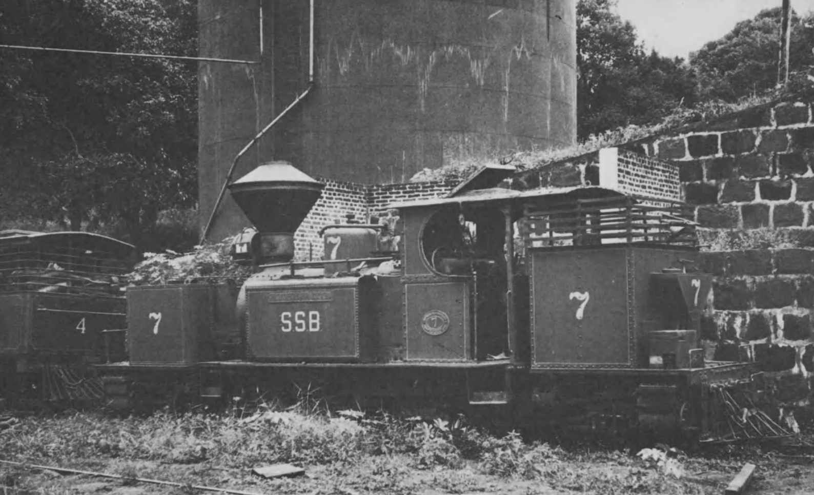
Eine Meterspur-Garratt mit Holzfeuerung, Funkenfänger-Schornstein (Kobel) und seitlichen Wasserkästen der Sucrerie de Piracicaba, Brasilien im Juli 1970. Jeremy Wiseman
