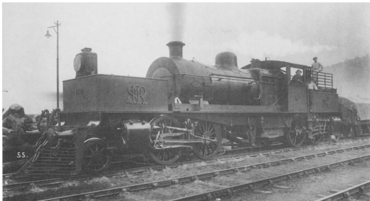
Auf dem Küstenabschnitt von und nach Santos verwendete die Sao Paulo Bahn drei 1B B1 Garratts für alle Zugarten. F. C. Santos a Jundiahy
