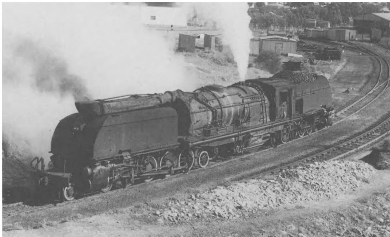
Die Lok Nr. 4009 der Klasse GEA, bekannt als Rhinoceros und versuchsweise mit einer Funkenfängerausrüstung
