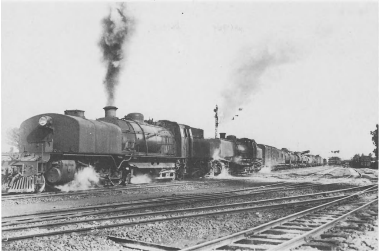
Eine seltene und ungewöhnliche Kombination stellt diese in den 1930er Jahren bei Johannesburg aufgenommene Bespannung dar – eine Garratt Klasse GF und eine Modified Fairlie Klasse HF fahren zusammen einen Güterzug.
