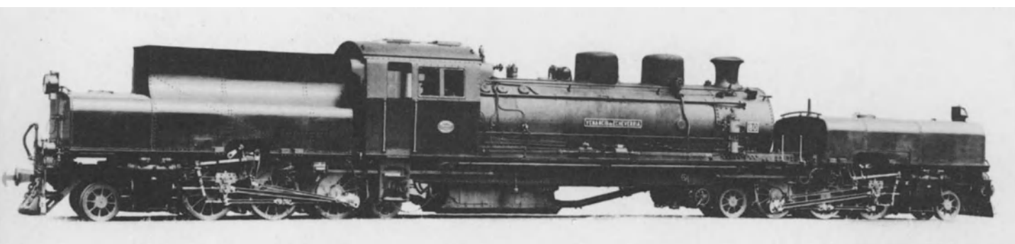
1C1 1C1 Garratt-Lokomotive für die La Robla Bahn (Spanien) Nr. 80 Venancio de Echeverria Hanomag Fabrik-Nr. 10646/1929
