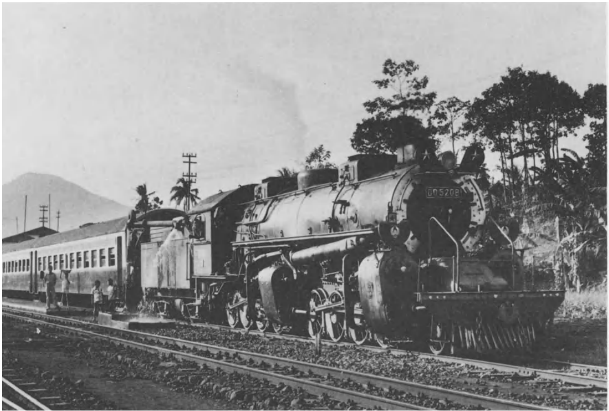
Die klassische Verbund-Mallet-Lokomotive ist hier repräsentiert von der Lok Nr. DD 5208 der Indonesischen Staatsbahn PNKA, eine 1DD vor einem Reisezug im
