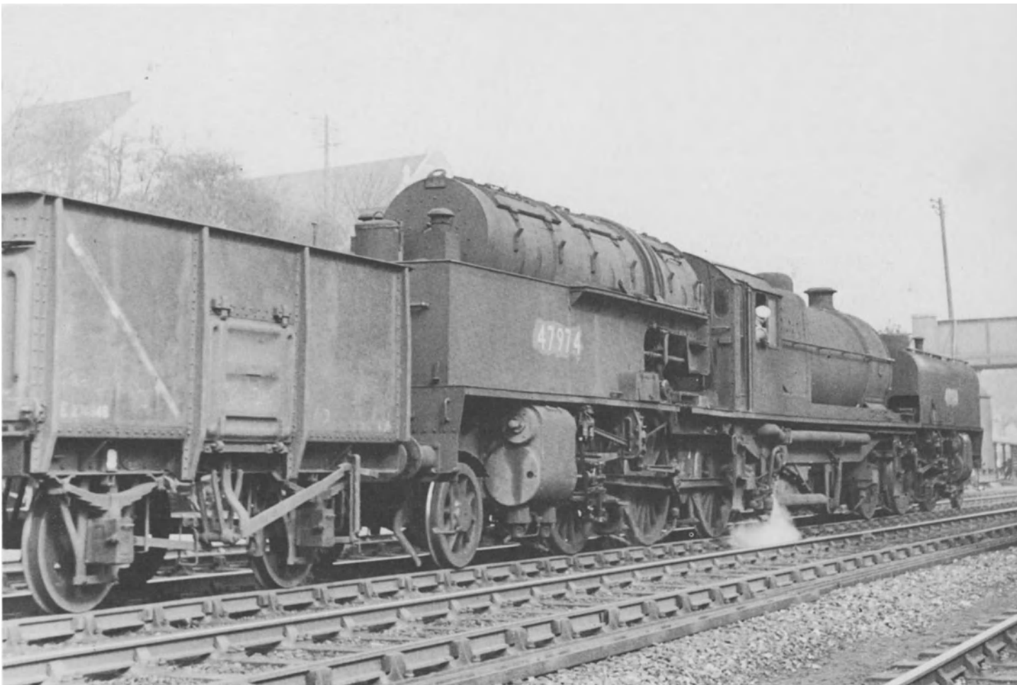
In ihrem letzten Bauzustand mit der British Railways Nr. 47974, kleinem Schornstein, drehbarem Kohlebunker und Schutzblechen gegen auf das Gestänge herabfallende Kohlenstückchen rumpelt die ehemalige LMS Garratt mit kleinen ungebremsten Kohlenwagen die Midland-Hauptstrecke entlang.
