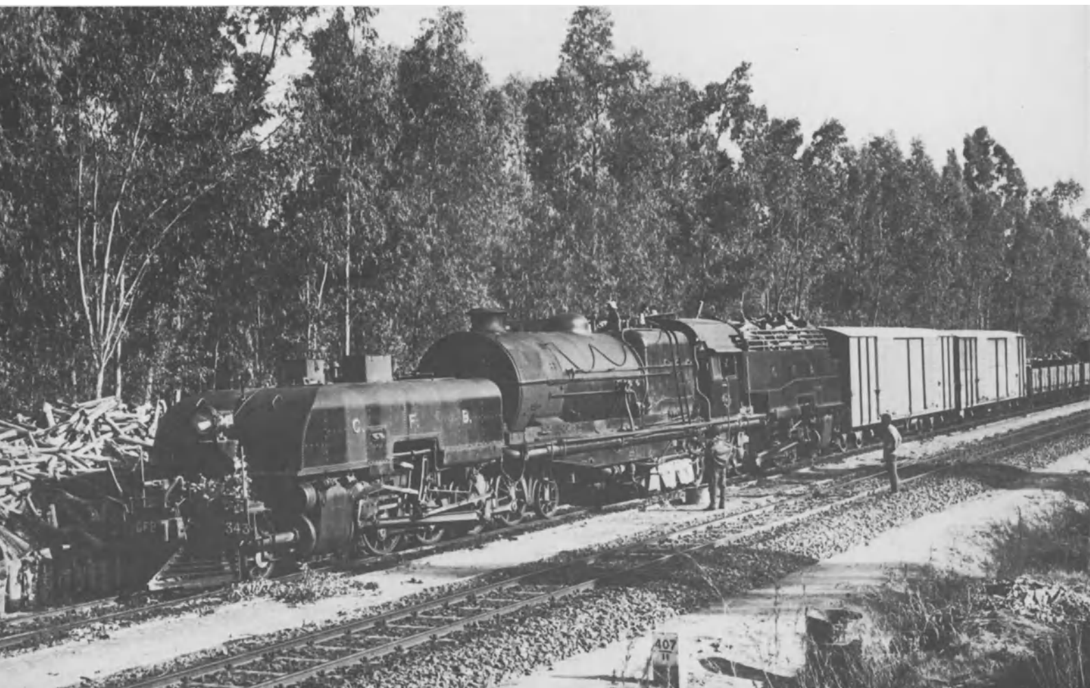
Unten: Die Lok Nr. 343 aus der 3. CFB-Serie mit abgerundeten Wassertankstirnseiten und Holzfeuerung bei der Brennstoffaufnahme in Zentralangola.
