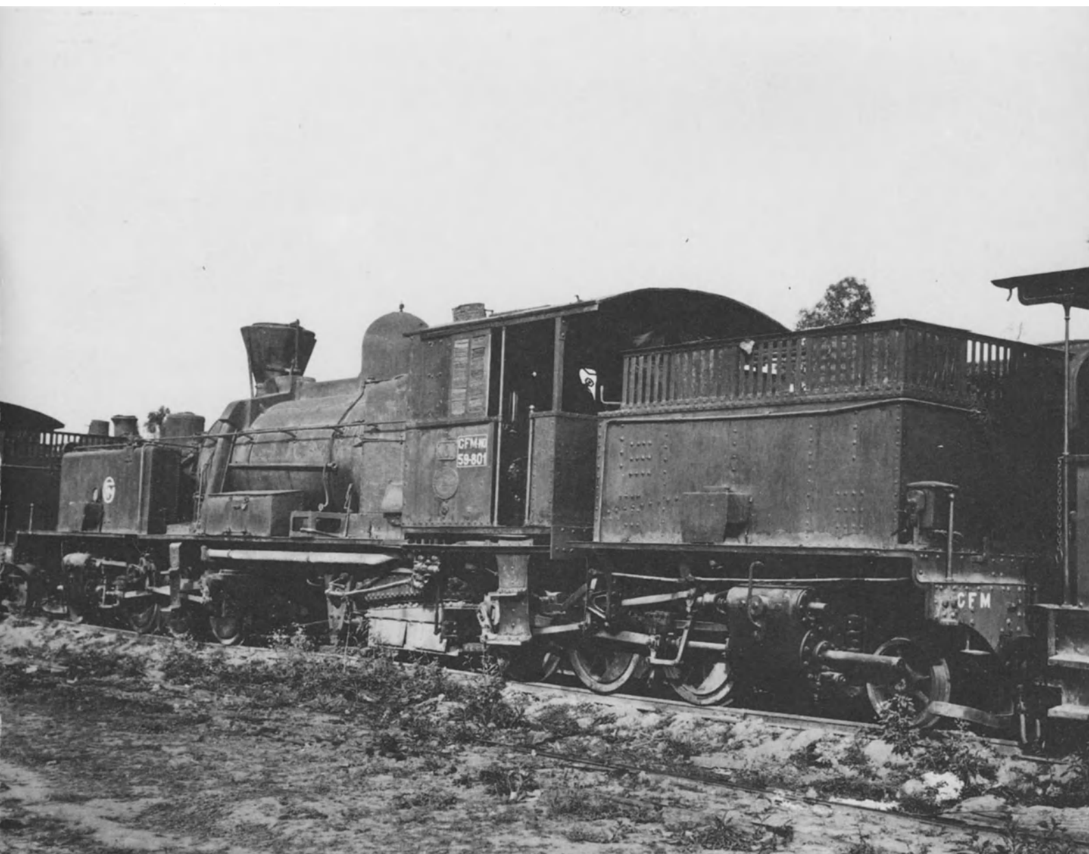
In Belgien gebaute IC C1-Garratt der Madagascar Railways mit Holzfeuerung und Funkenfängerschornstein.
