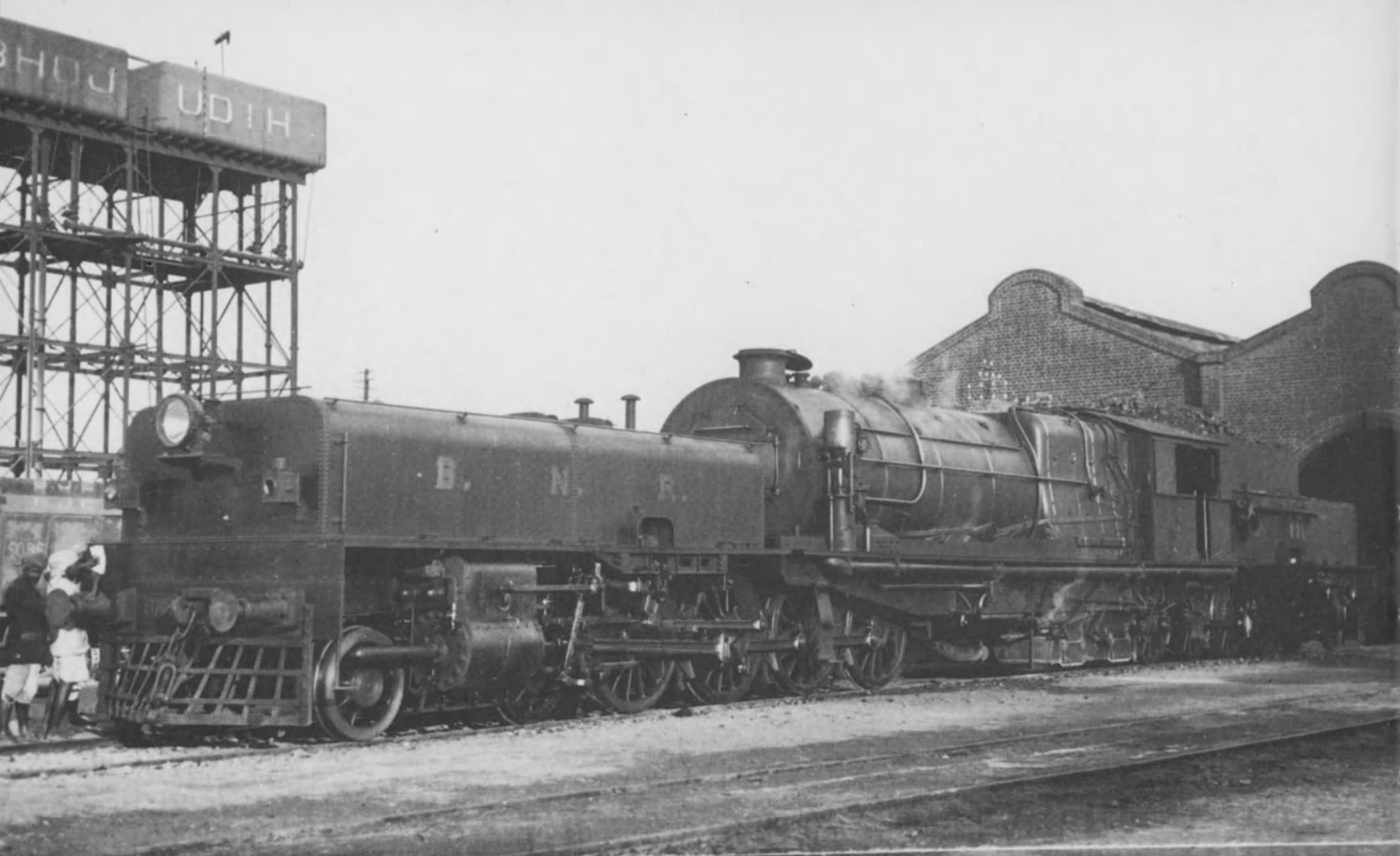
Eine BNR-Lok Klasse NM mit Lentz-Ventilsteuerung im Depot Bhojudih Junction. Diese Loks behielten ihre Ventil-
