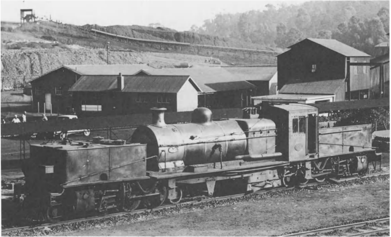
Oben: Die Lok Nr. 2 der Vryheid Railway, Coal & Iron wurde nach den Plänen der New Cape Central Railway Garratts (SAR Klasse GK) gebaut, die ihrerseits der SAR Klasse GC sehr ähnlich sind. Im Jahre 1969 wartet diese Industrielok in der Hlobane Colliery in Natal auf ihr Schicksal, lange nachdem die SAR Klassen GO und GK verschrottet wurden. (Beyer Peacock Fabrik-Nr. 6206/1925)
