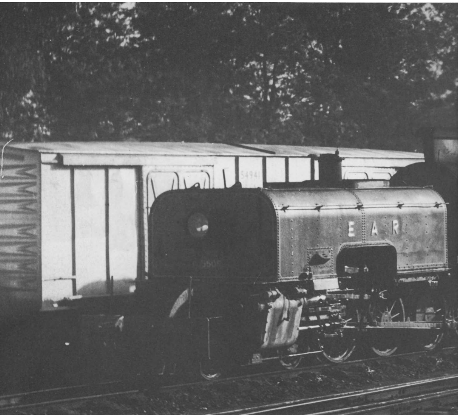
Die Klasse 55 der EAR kam von verschiedenen Lieferanten, war für Kohle- oder Ölfeuerung eingerichtet und erhielt schliesslich Giesl-Ejektoren. Die Lok Nr. 5505 war eine der
