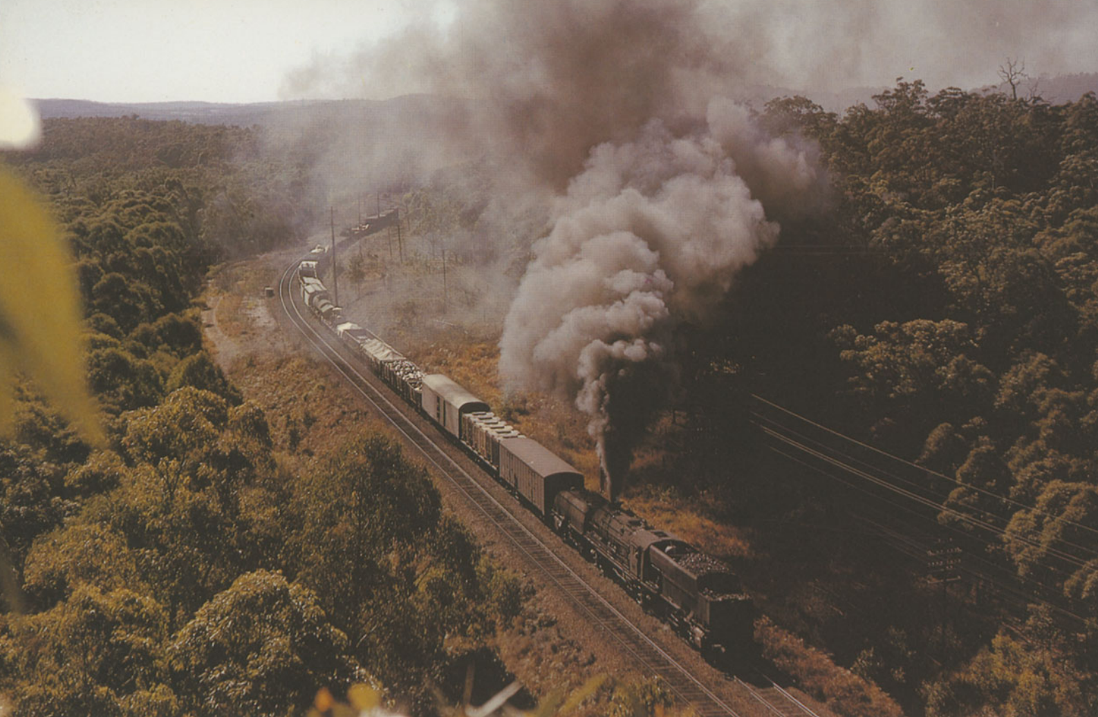
Oben: Ein südwärts fahrender Güterzug kämpft sich die Steigung 1:75 (13,3‰) zum Scheitelpunkt Hawkmount hinauf, gezogen von einer der leistungsfähigsten australischen Dampflokomotiven, der 2D2 2D2 Garratt Klasse AD 60 der NSWGR auf Normalspur. R. A. Kingsford-Smith
