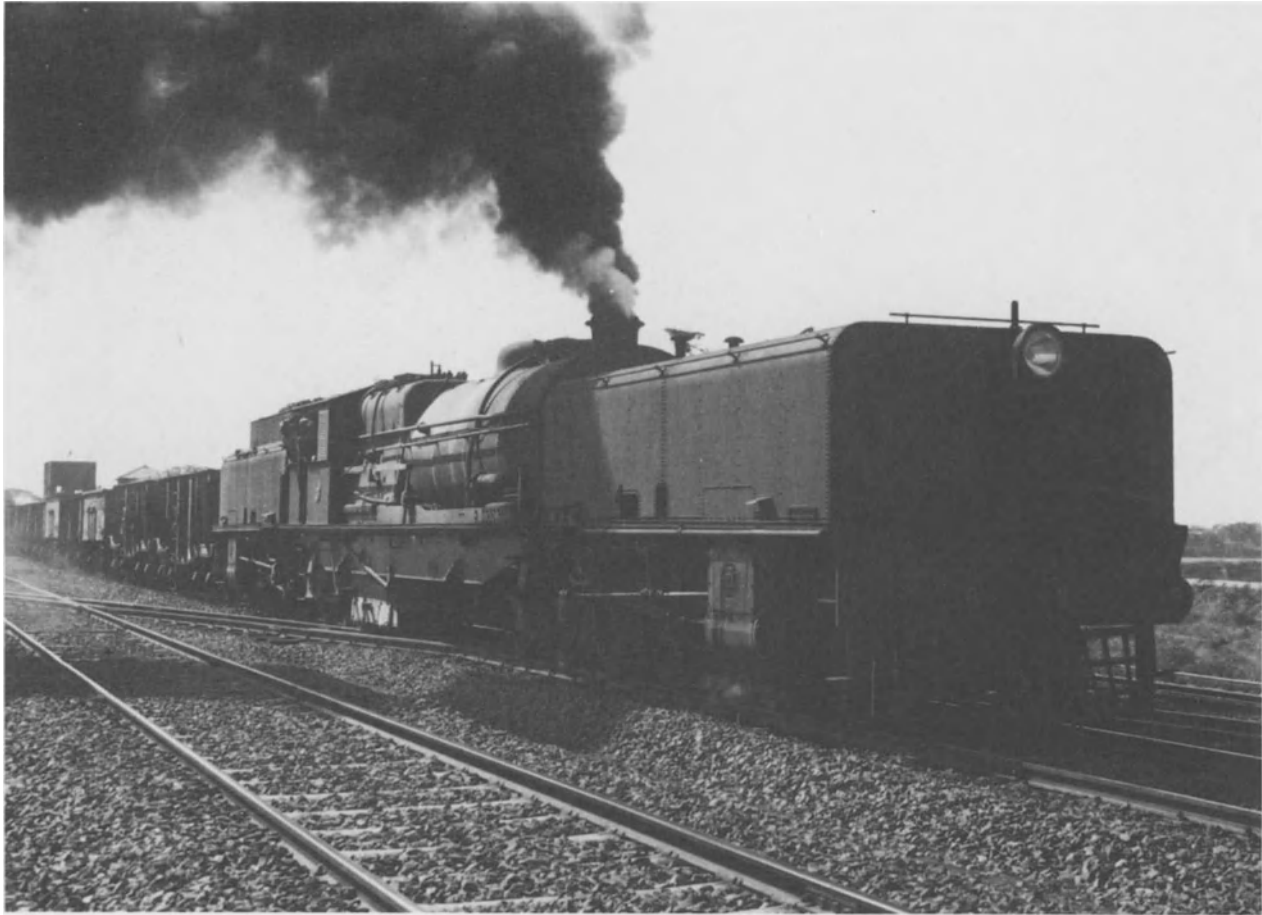
Eine BNR-Lok Klasse N im Einsatz. Es ist noch die ursprüngliche Ventilsteuerung mit umlaufender Nockenwelle
