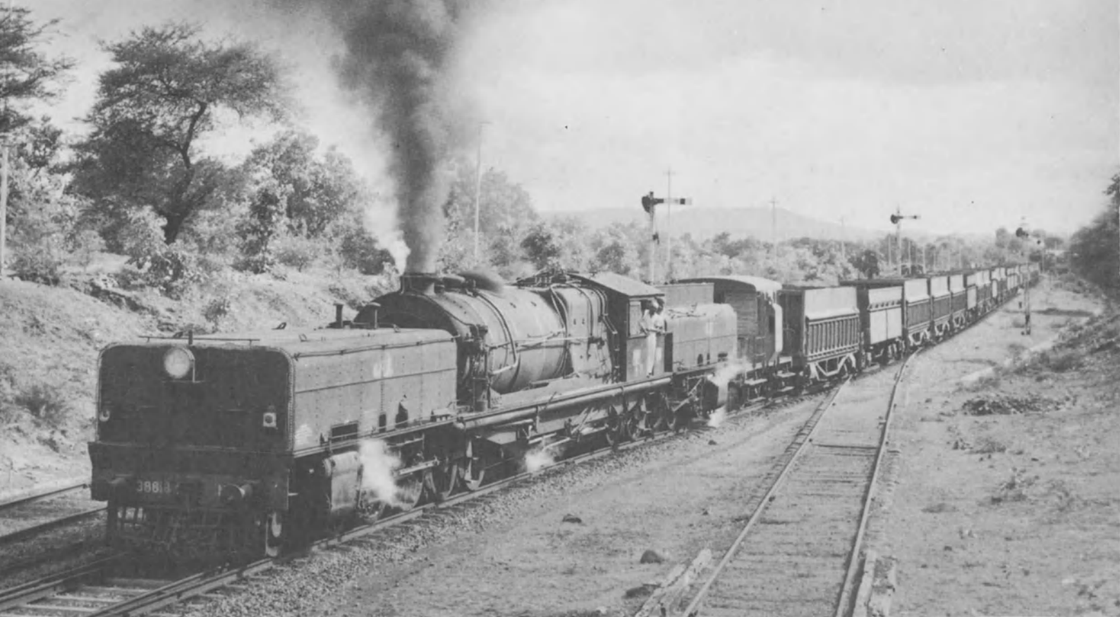
Die Garratt Klasse N der Bengal Nagpur Bahn in ihrer ersten und letzten Bauform mit Kolbenschiebern. Die Lok Nr. 38810 der Indian Railways fährt hier im Jahre 1970 mit einem
