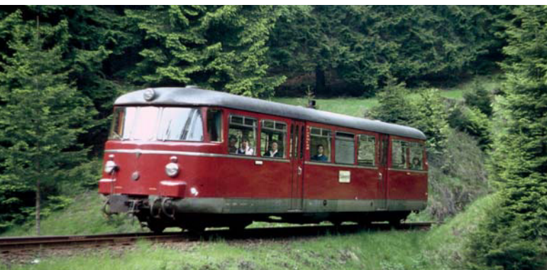
Der 1960 von MAN für die SHE gebaute vierachsige Meterspur-Triebwagen VT 14 ist am 13. Juni 1962 bei Stöberhai unterwegs.
