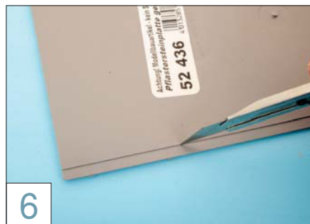
6 Die Auhagen-Platten müssen seitlich beschnitten werden, damit gerade Kanten in der Pflasterung entstehen.
