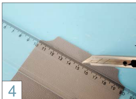
4 Das Füllstück mit zwei passgenauen Rundungen wird mit einem Cutter in der richtigen Breite abgetrennt.
