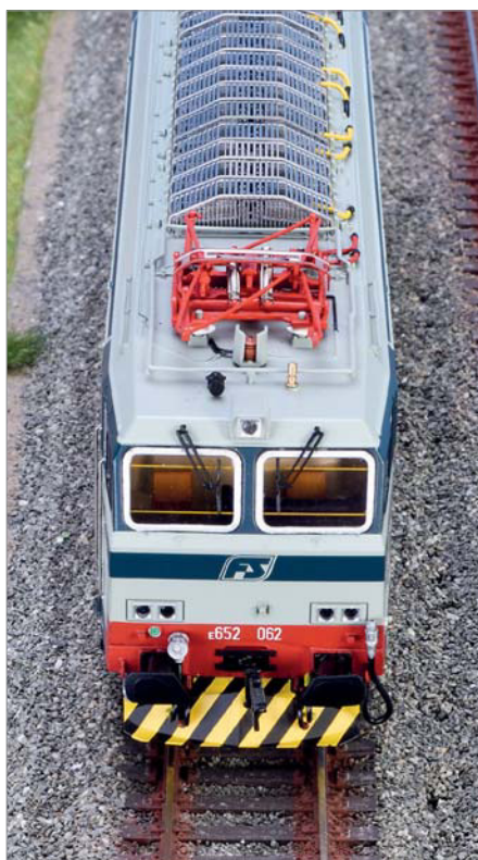
Die feinen Schutzgitter über den Dachwiderständen der E.652 062 sind eine wahre Augenweide.
