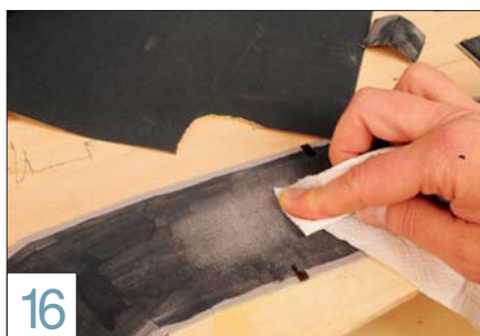
16 Ist diese durchgetrocknet, trägt man sie auf den Pflastersteinköpfen mit feinem Schleifpapier wieder ab.
