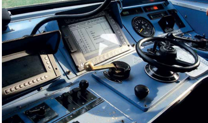
Das Fahrpult der Baureihe 614, hier ist schon der letzte Zustand kurz vor der Ausmusterung 2008 zu sehen, kam mit dem Nötigsten aus.
