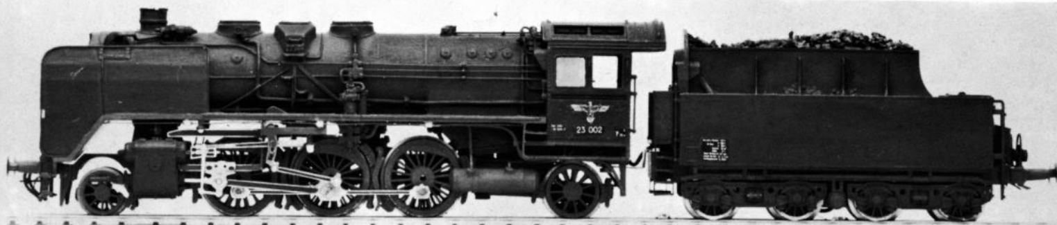
Bild 2: Dieselbe Lok von der Heizerseite. Gut erkennbar der freie Rahmendurch- blick sowie der in der Höhe etwas abgeänderte Tender.
