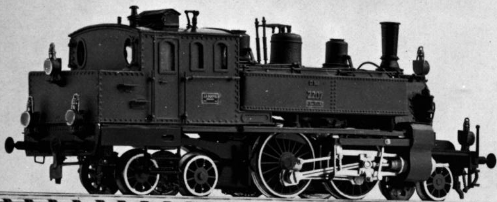
Bild 4: Dieses Bild läßt den großen Überhang des Führerhauses nach den Treibachsen erkennen. Dieser birgt enorme Schwierigkeiten für einen Modellbau, da dadurch das Modell zum Wippen neigen kann.
