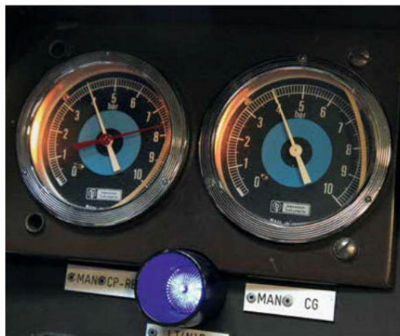
Sur une rame TGV Sud-Est, la CG et le RE sont à 4 bars, et la lampe témoin «neutre» est allumée. Le conducteur effectue ses essais d'étanchéité. Janvier 2014.
