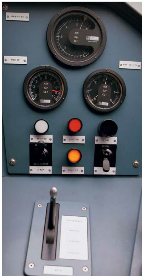
Dans la cabine de conduite de cette voiture Corail réversible B5 uxx, la surcharge est alimentée à 5,4 bars en vue de l'essai de frein à venir.
