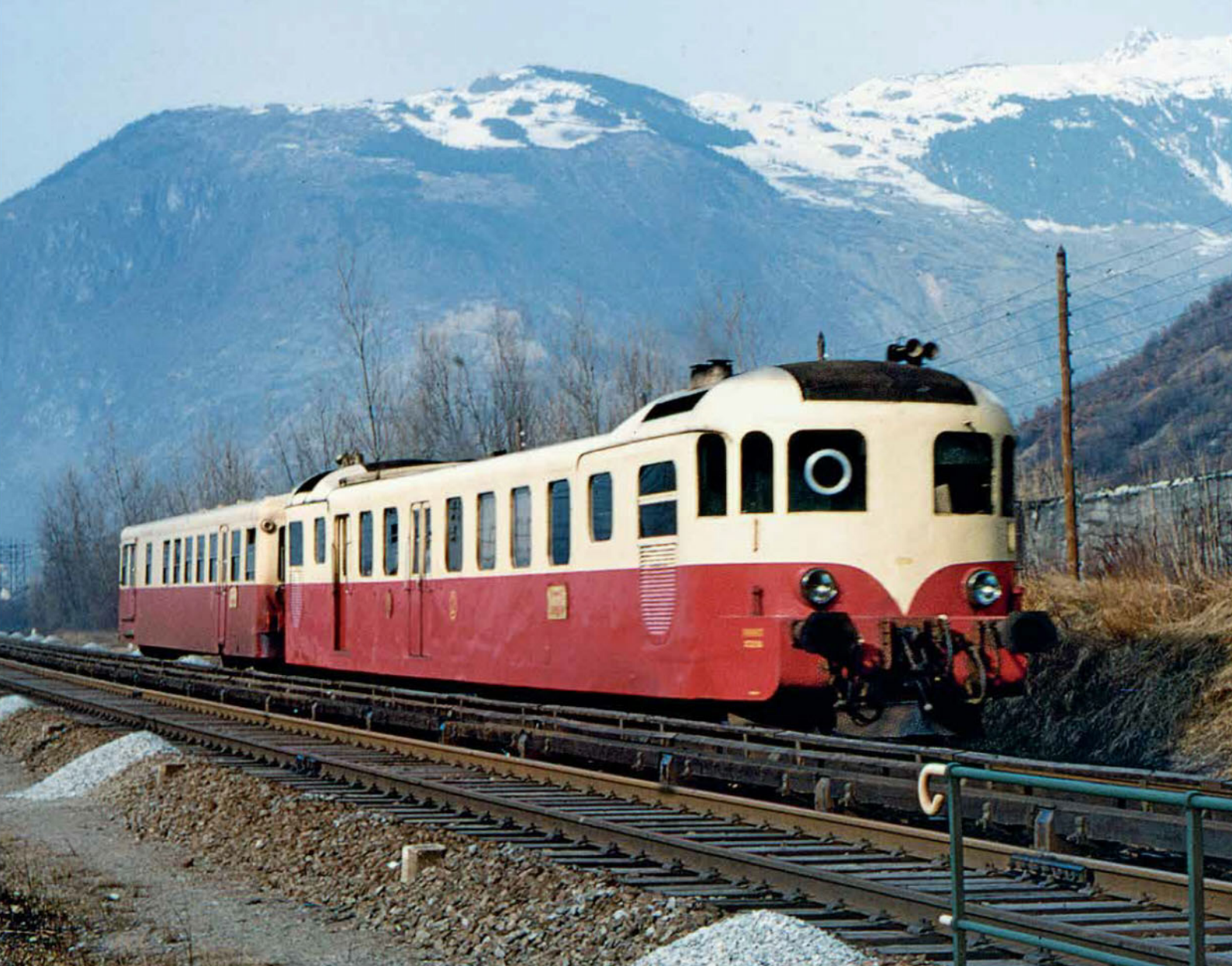
À la fin des années 1950, cet X 52000 tracte une XR 7800 grand fourgon sur la ligne de Maurienne alors électrifiée par 3 e rail 1500 V.
