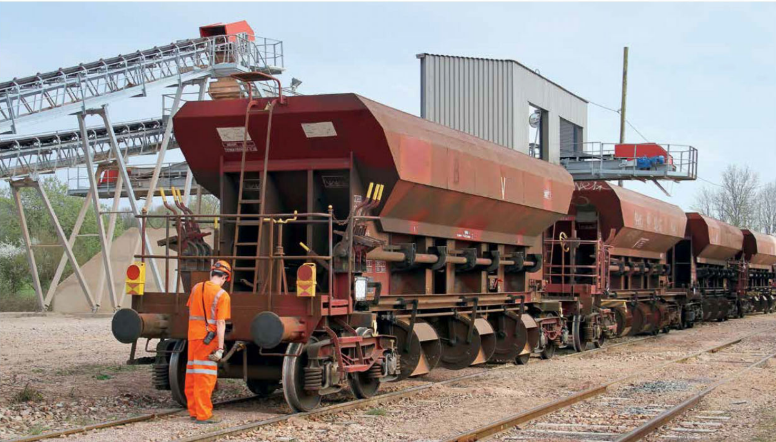
Sur l'embranchement des carrières d'Epiry-Montreuil, Flavien Lefebvre vidange la CG de la rame de ballast au cours d'un essai complet. Vendredi 6 avril 2012.
