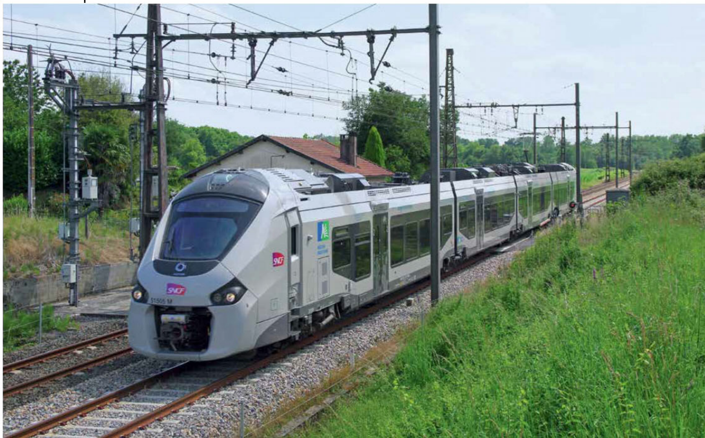
Regiolis existe aussi en rame pure électrique sans powerpack diesel. Ici, la rame à 4 caisses Z 51505 de TER Aquitaine.
