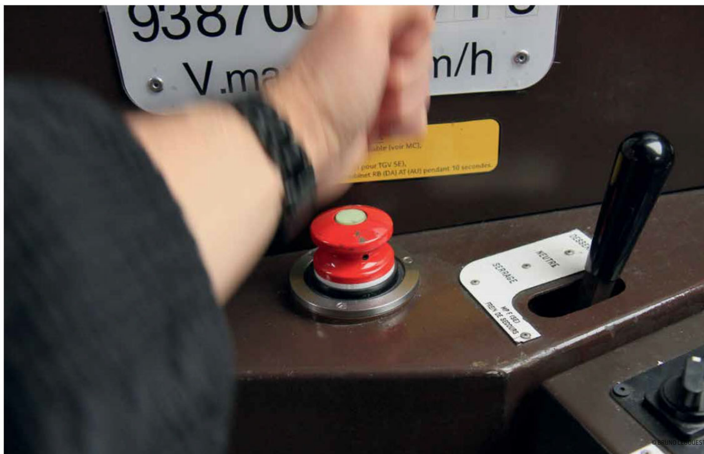
Essai du BP-URG par coup de poing. Le conducteur contrôle son bon fonctionnement par observation du manomètre CG qui tombe à 0 et du maintien de la pression maximale au manomètre des CF. Janvier 2014.
